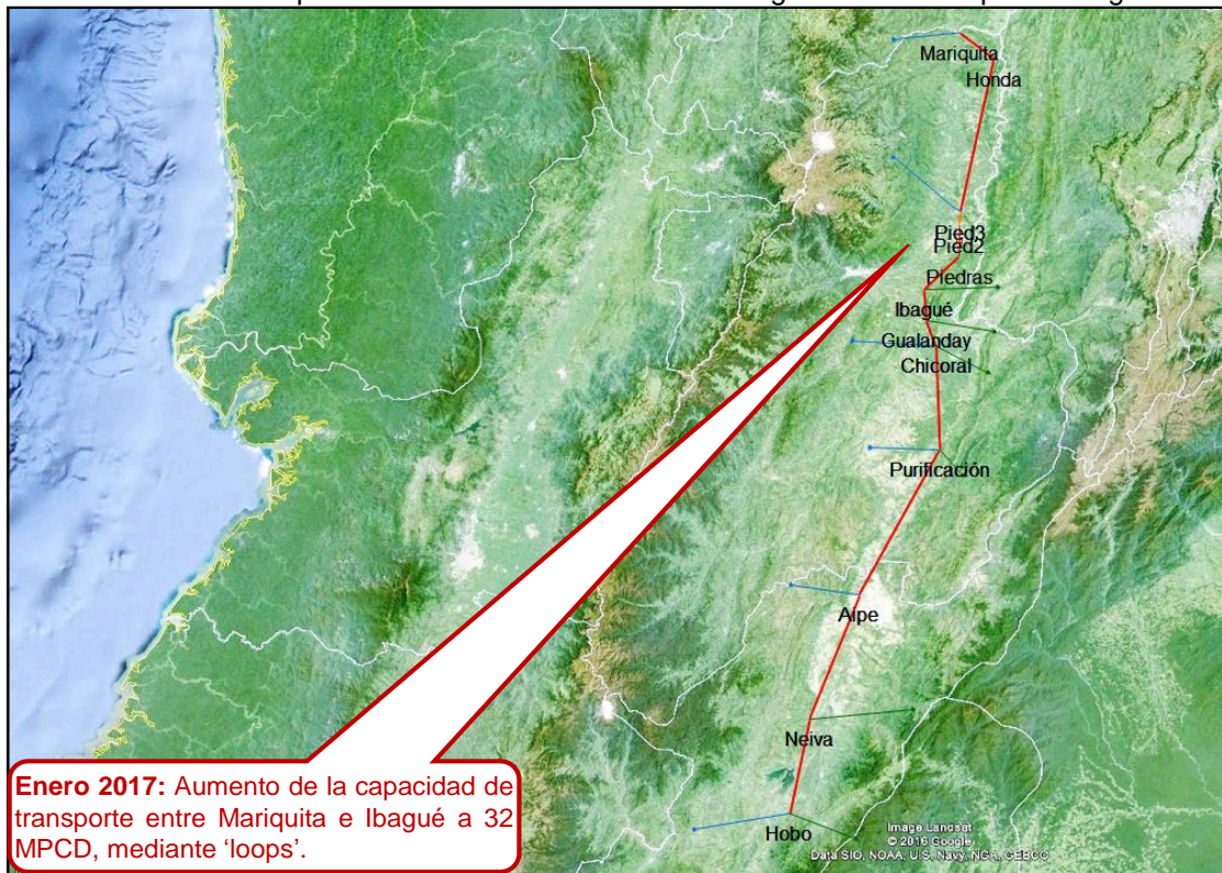
Gráfica 6-13: Requerimientos de infraestructura en el gasoducto Mariquita – Ibagué.
