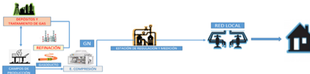
Figura 3. Red física de ductos de Gas Natural
