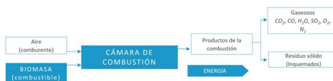
Figura 3. Esquema del proceso de combustión de la biomasa. Fuente: elaboración propia (basado en Sebastián, 2017).
