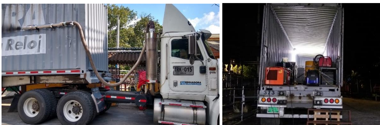
Figura A. 2. Adaptación del tubo de muestreo al tubo de escape (izquierda) y contenedor cargado (derecha).
