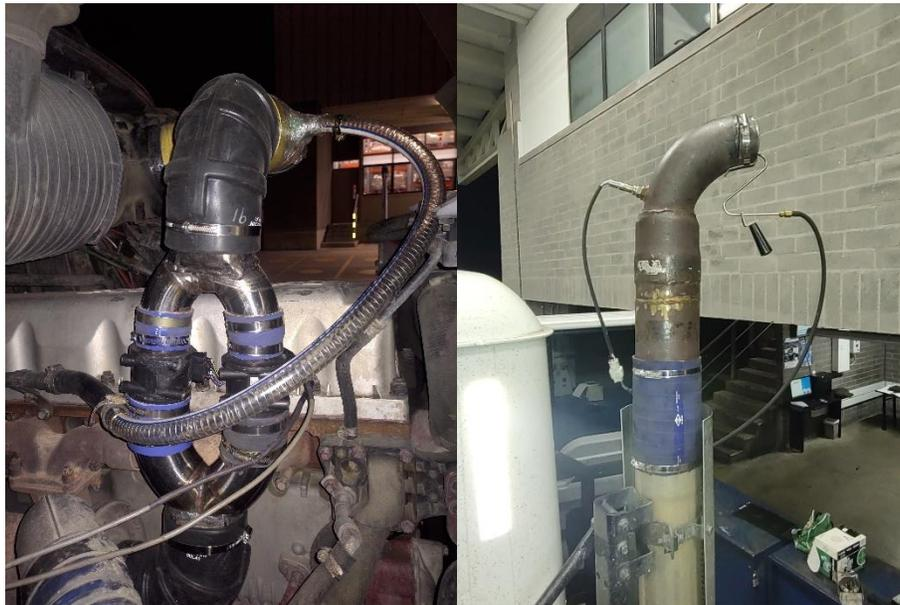
Sistema de doble MAF en la admisión y adaptación tubo de escape de un tractocamión. FECOC+ Fase 2.2
