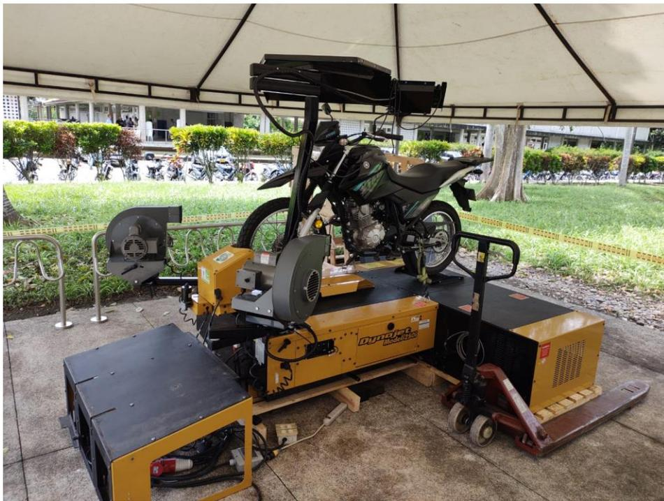
Figura 1.19. Montaje y puesta a punto del banco de rodillos para pruebas de motocicletas en la sede de Apartadó de la Universidad de Antioquia (0 msnm)
