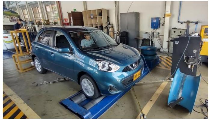
Figura 1.6. Bancos de rodillos utilizados para medir factores de emisión siguiendo ciclos de conducción. Izq.: para motocicletas. Der.: para vehículos livianos
