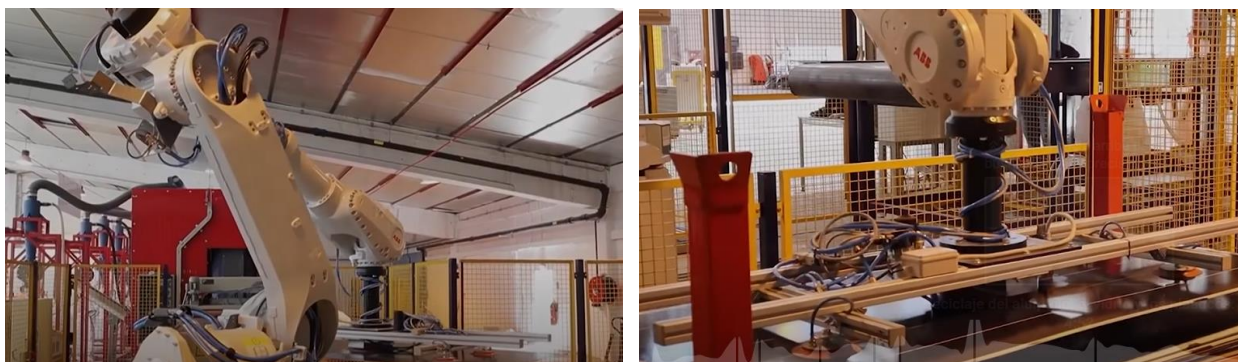
Figura 7. Proceso de desmontaje de marcos metálicos
