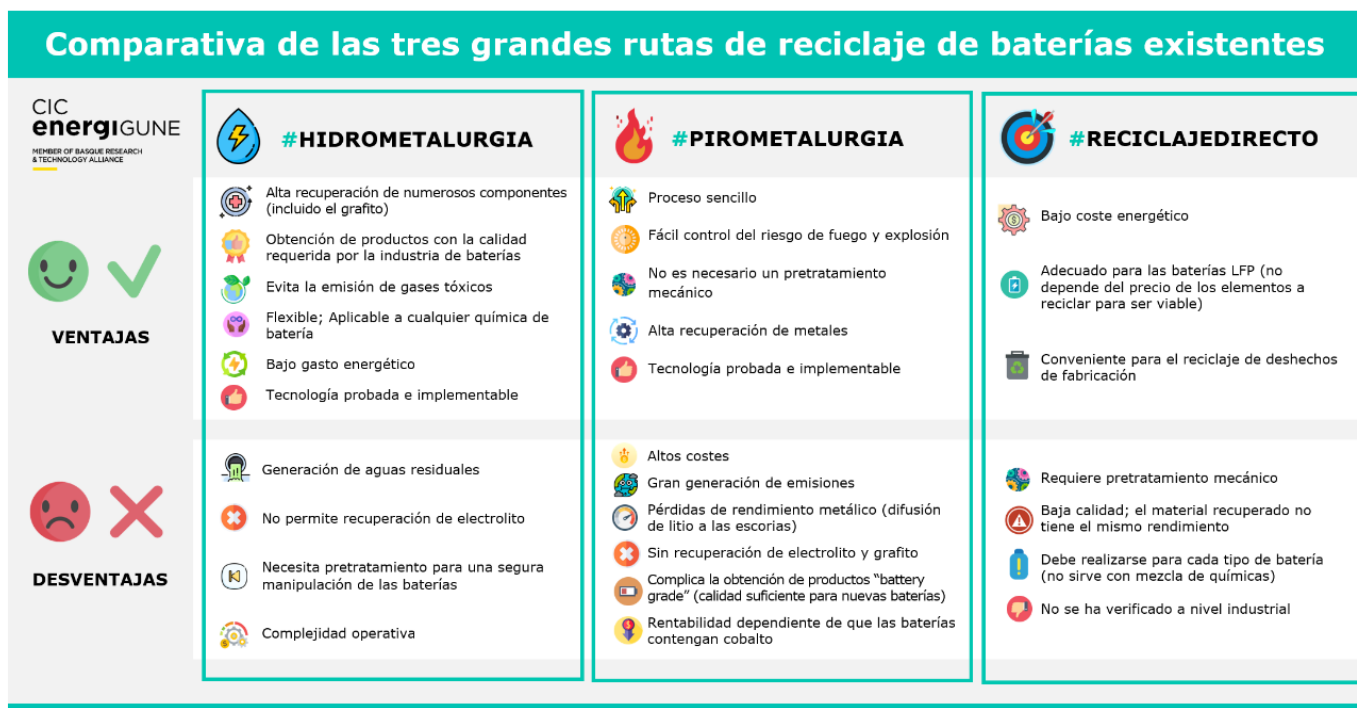
Figura 50. Comparación de los tres procesos de reciclaje de baterías existentes
