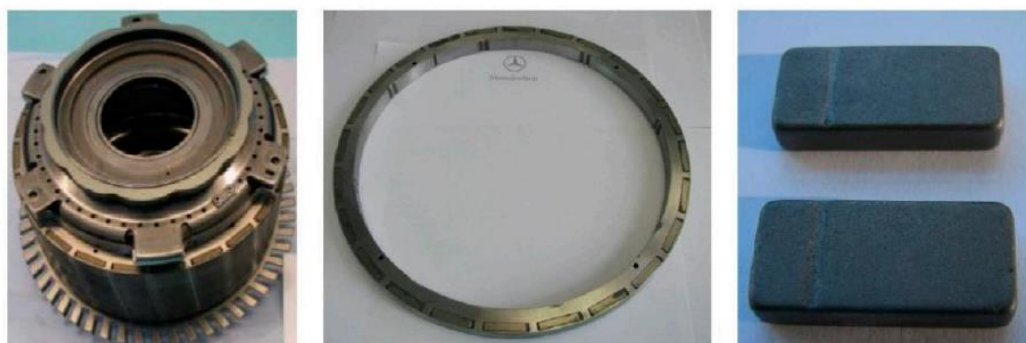
Figura 44. De izquierda a derecha: Rotor, Segmento del rotor, Imanes desmantelados
