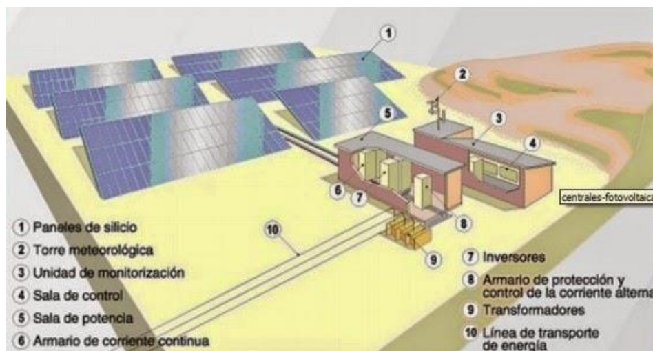
Figura 12. Ilustración de un generador fotovoltaico conectado a la red (YUBA, 2015)
