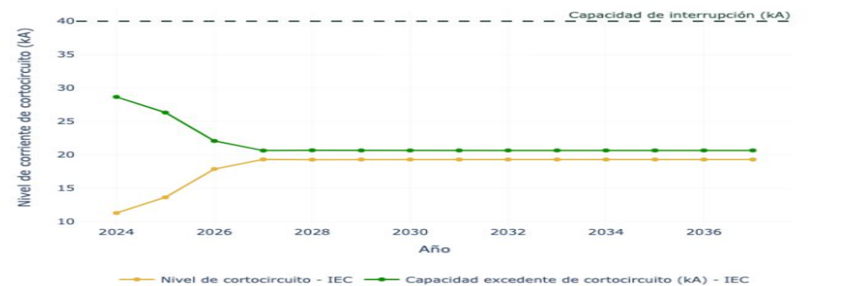
Figura 437. Capacidad de cortocircuito excedente de La Loma 500 a lo largo del horizonte de planeación
