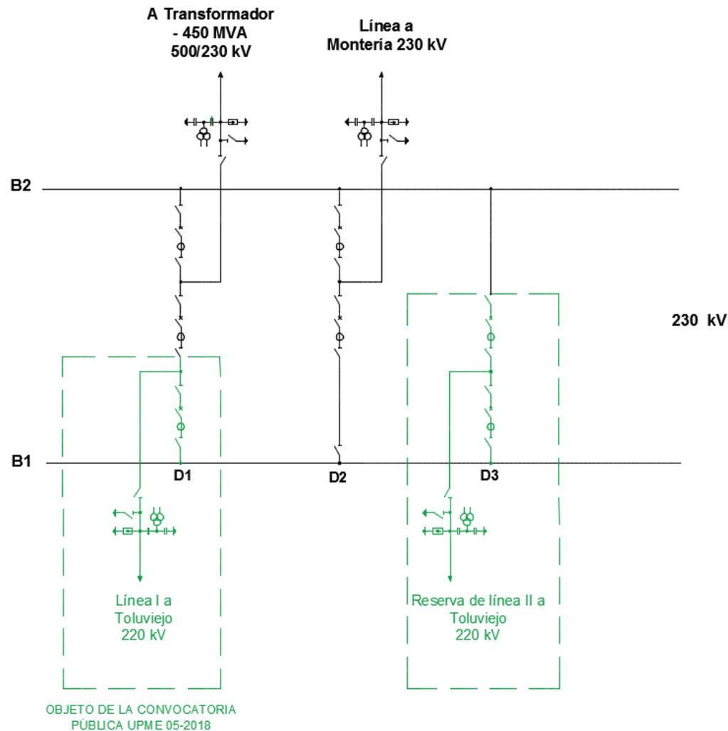
**Figura 3 - Diagrama Unifilar Subestación Chinú 230 kV
