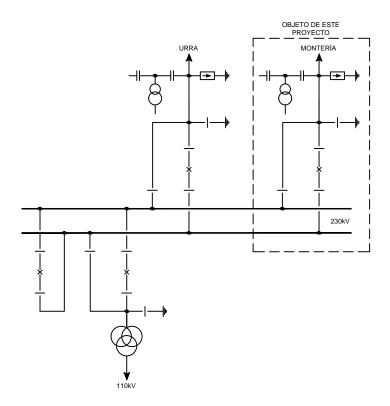
FIGURA 6 ESQUEMA UNIFILAR AMPLIACIÓN SUBESTACIÓN URABA 230kV
