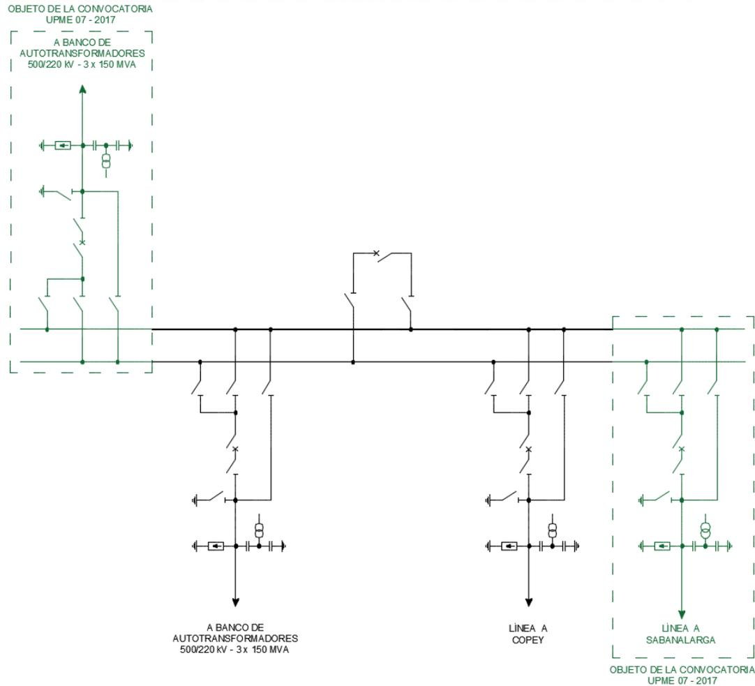
FIGURA 3. SUBESTACIÓN BOLÍVAR 500 kV
