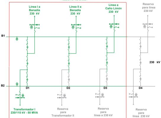
FIGURA 2 DIAGRAMA UNIFILAR SUBESTACIÓN LA PAZ 230 kV (PREPUBLICACIÓN)
