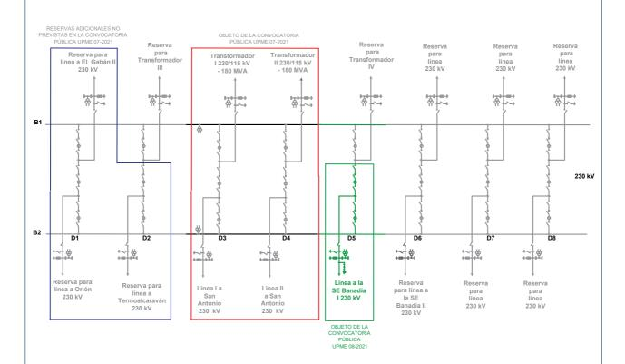
FIGURA 3 DIAGRAMA UNIFILAR SUBESTACIÓN ALCARAVÁN 230 KV (PREPUBLICACIÓN)
