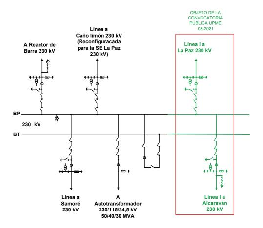
FIGURA 4 DIAGRAMA UNIFILAR SUBESTACIÓN BANADÍA 230 kV (PREPUBLICACIÓN)
