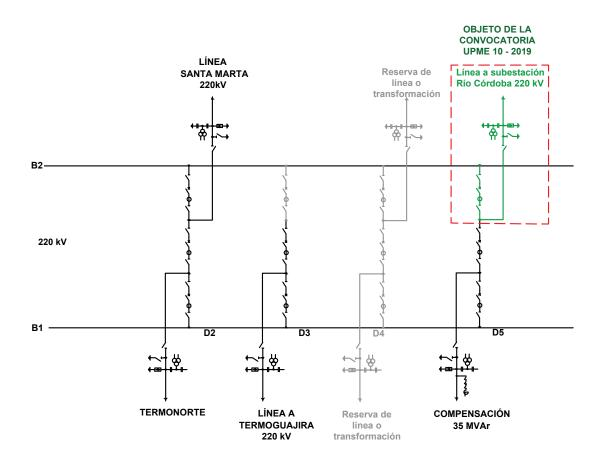
FIGURA 2 ESQUEMA UNIFILAR SUBESTACIÓN BONDA (TERMOCOL) 220 kV
