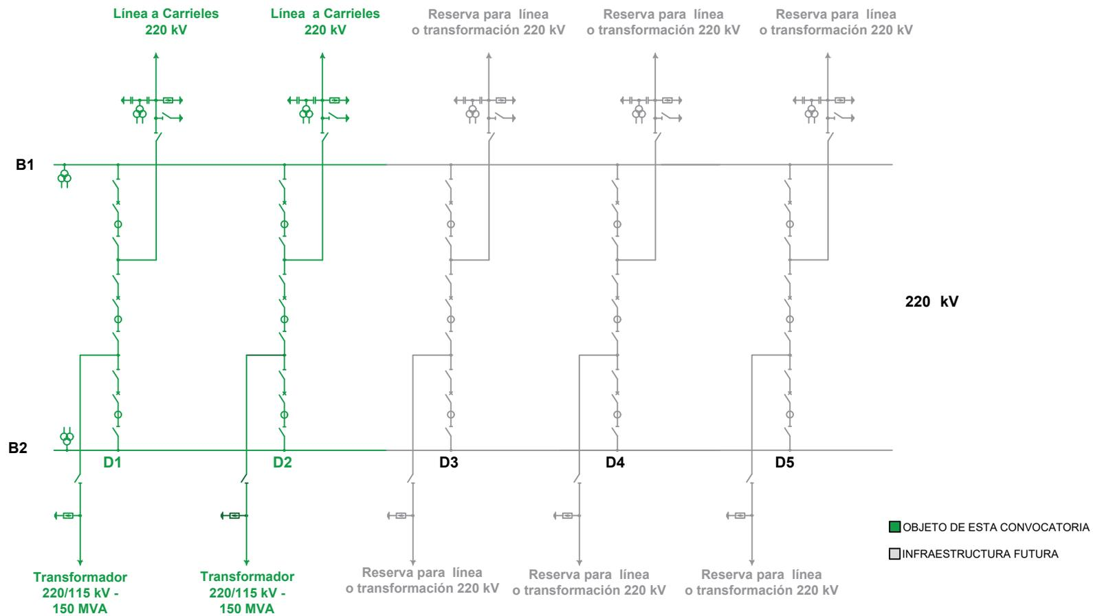
Figura 2. Diagrama Unifilar Nueva Quibdó 220 kV
