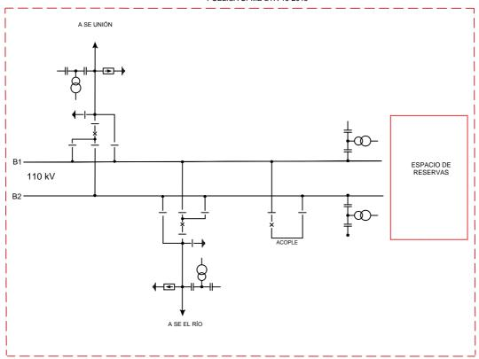
FIGURA 6 ESQUEMA UNIFILAR SUBESTACIÓN MAGDALENA 110 kV
