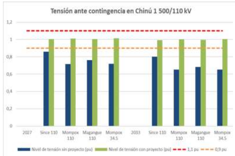
Figura 27. Resultados de tensión subestación Nueva Magangué (ii)
