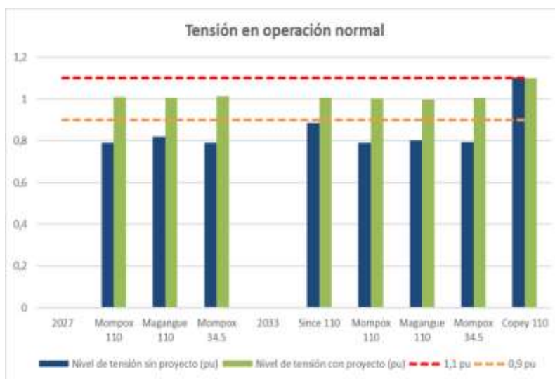
Figura 26. Resultados de tensión subestación Nueva Magangué (i)
