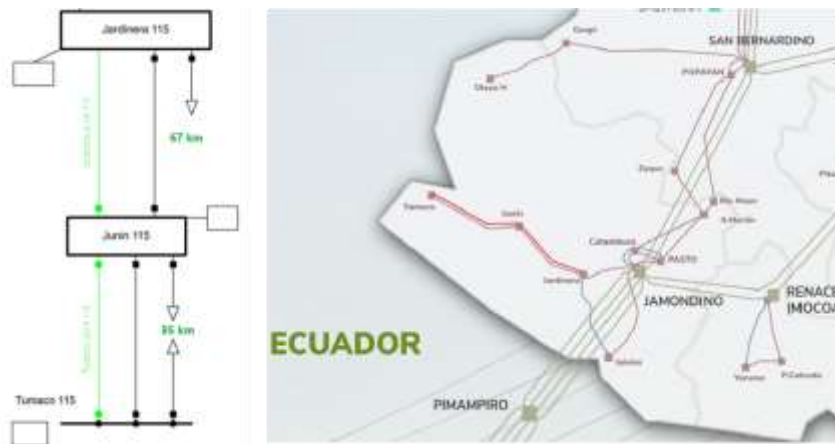
Figura 9. Diagrama unifilar y ubicación geográfica proyecto segundo corredor Jardínera-Junín-Tumaco 115 kV
