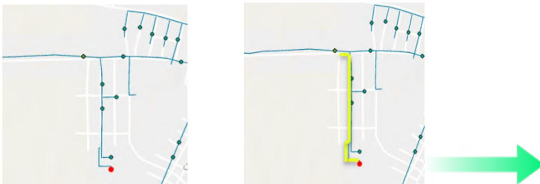
**Figura 20. Cálculo de distancia entre transformadores de nivel 1 y nivel 2 más cercano por el circuito de MT.**
