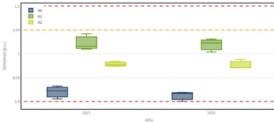
Figura 5-6. Perfil de tensiones en red normal en subestación Tumaco 115 kV sin proyecto (A0) y con proyectos A1 y A2. Fuente: UPME
