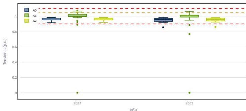
Figura 5-11. Perfil de tensiones ante contingencia N-1 en subestación Olaya sin proyecto (A0) y con proyecto A1 y A2. Fuente: UPME
