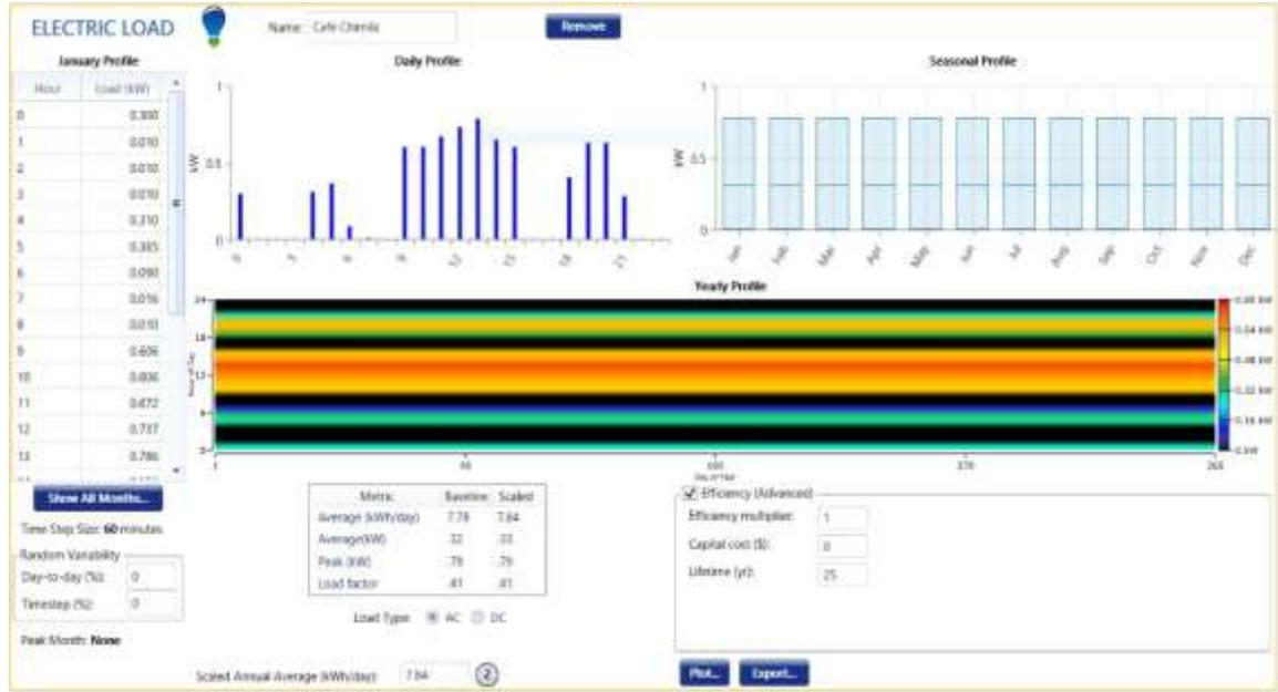
La carga es completamente AC, lo cual implica que exista un convertidor para invertir la tensión que venga de las fuentes de energía de DC. El consumo de energía promedio diario debido al perfil de carga es 7.84 kWh/d.
