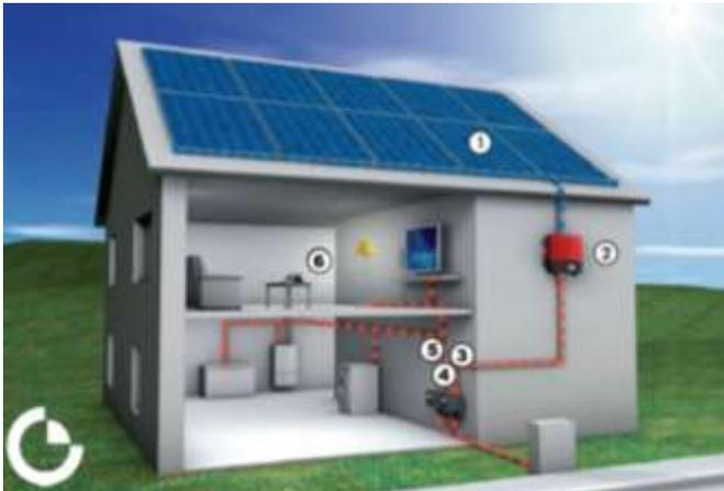
Los componentes principales del sistema son paneles fotovoltaicos (1), inversores de onda pura (2), sistema de control fotovoltaico (3), baterías de ciclo profundo (4), controlador de carga (5), una red en DC y una red en AC (6).
