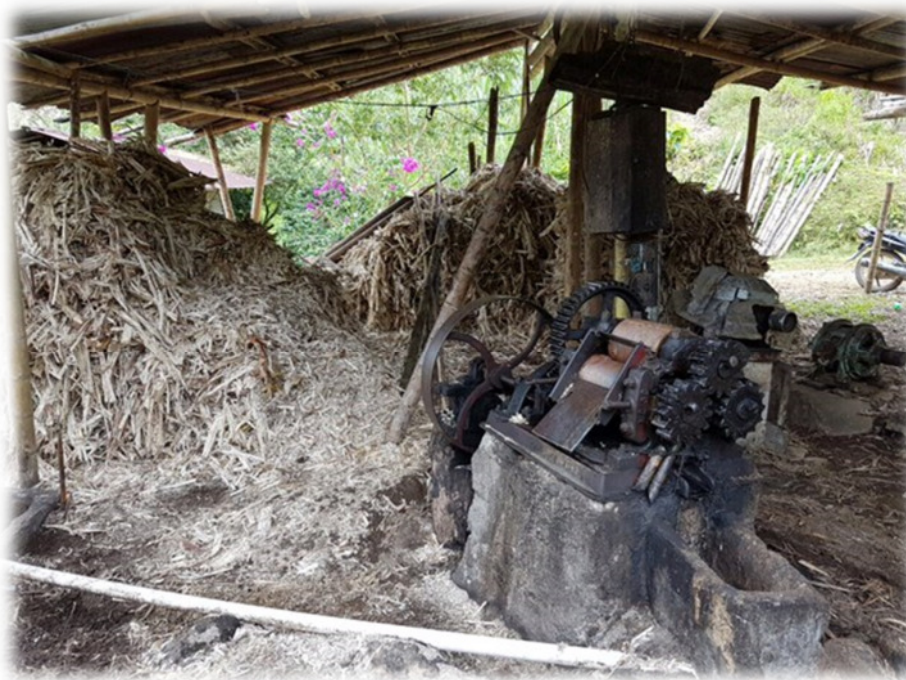
Fotografía 2. Trapiche rudimentario para la transformación de la caña panelera.
