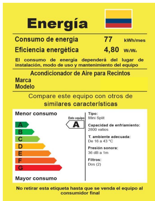
Figura 48. Etiquetado energético Colombia para acondicionador de aire. Tomado de: https://www.minminas.gov.co/retiq
