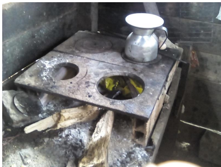
Foto 2. Estufa con plancha sin chimenea
