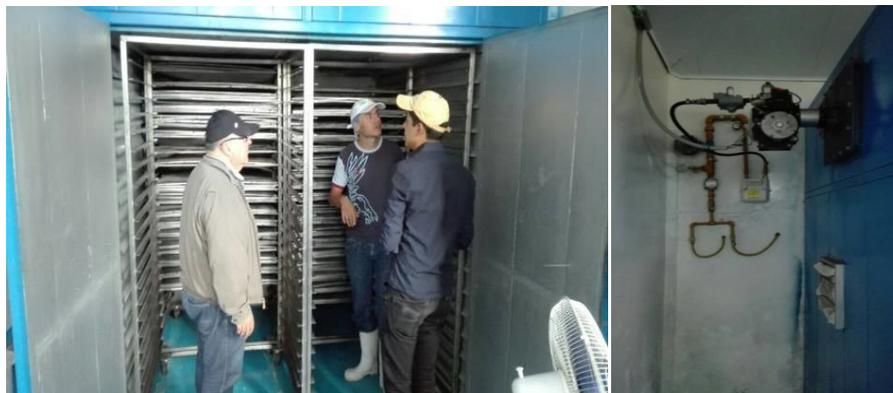
Figura 6. Deshidratador Gas/Electricidad. [Facilitado por Empresa BE FRUIT.]
