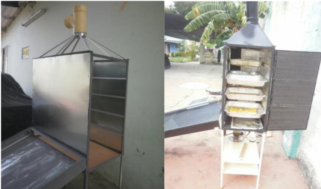
Figura 9. Fotografías de un prototipo de deshidratador solar de baja capacidad, construido con materiales de fácil acceso. Fuente: Caracterización de un deshidratador de mango solar ubicado en la región del Alto Magdalena, Libardo Cartagena Yara. 2014
