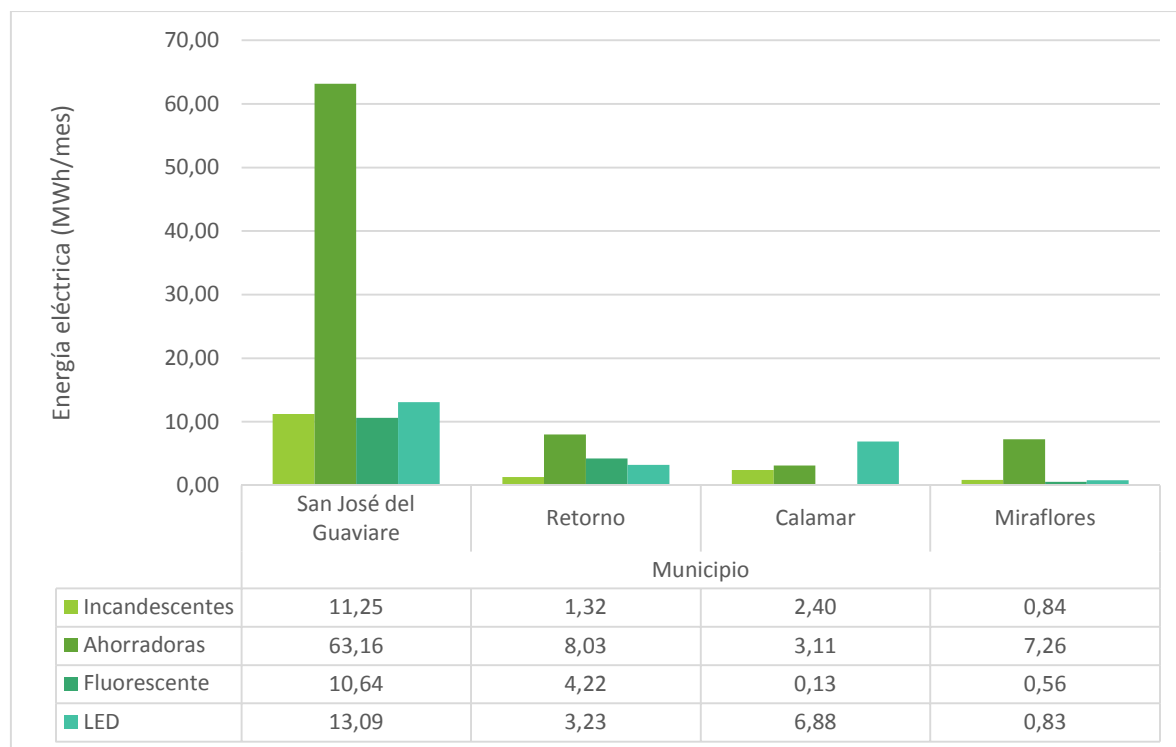
GRÁFICA 35 CONSUMO DE ENERGÍA ELÉCTRICA TOTAL POR ILUMINACIÓN EN LOS MUNICIPIOS DEL GUAVIARE
