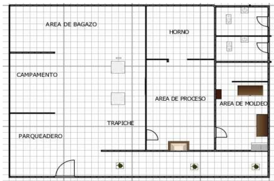
Figura 1. Distribución en Planta Trapiche Panelero
