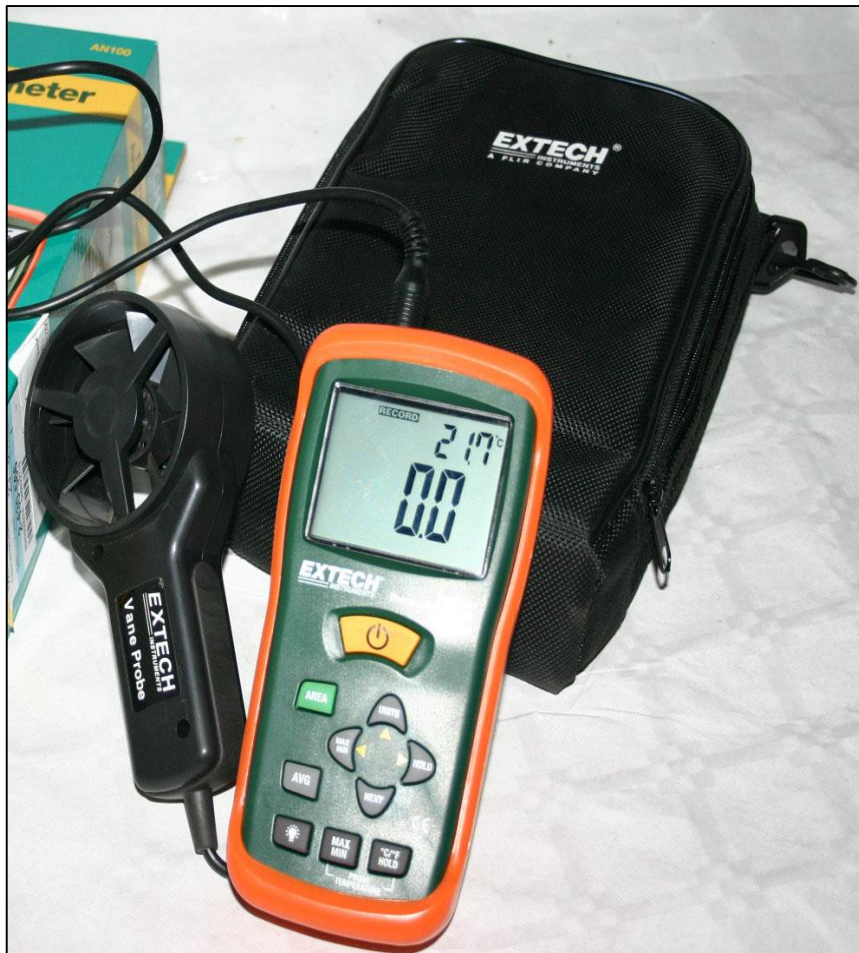
Figura 6. Anemómetro de veleta modelo 451112 Extech.
