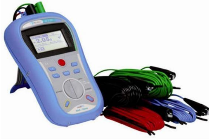
Figura. 12 Equipo utilizado para la medición de resistividad del terreno.
