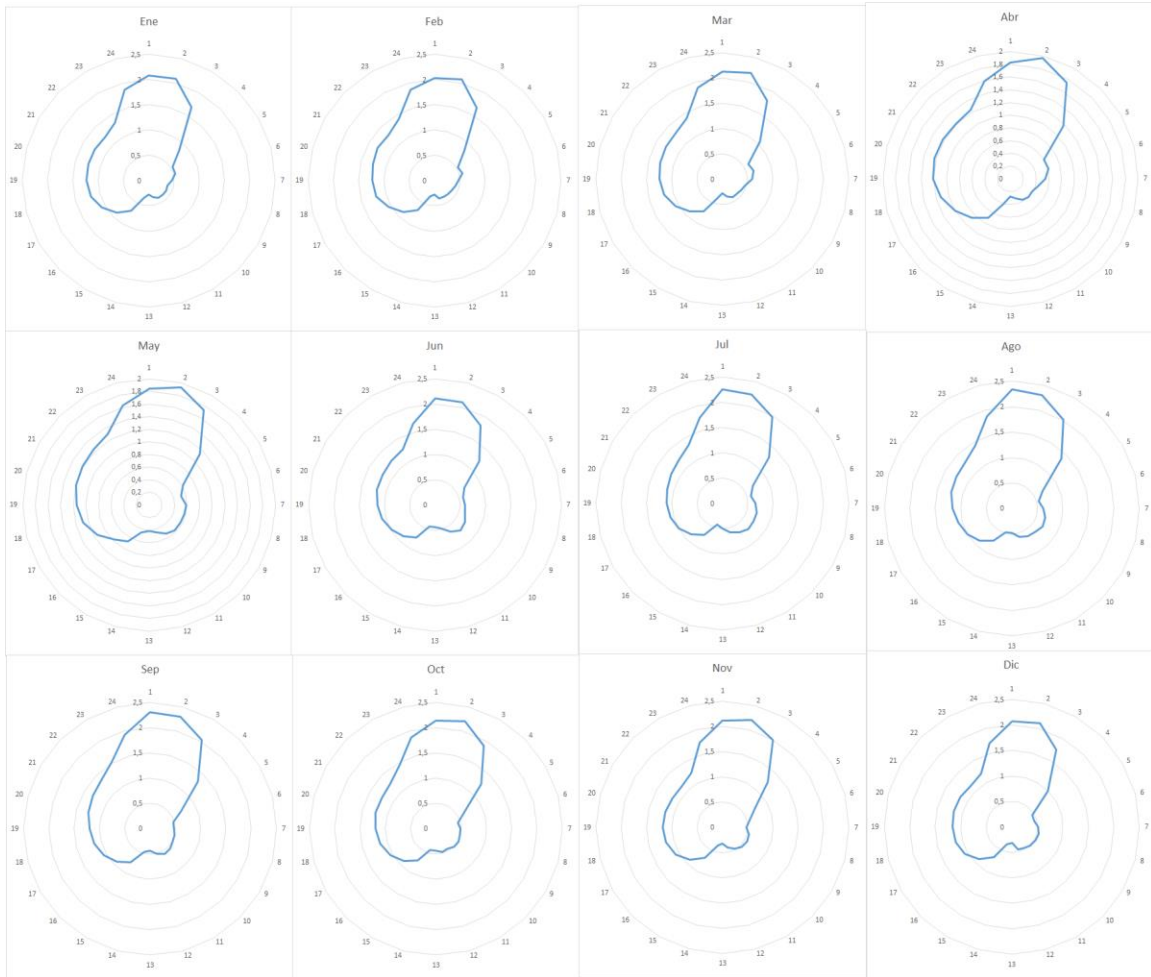
Figura 22 Variación horaria de la velocidad del viento (% de Velocidad promedio anual) – Norte – altura 100m. Fuente datos: Global Wind Atlas
