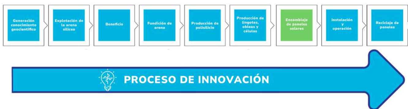
Figura 46. Cadena productiva de paneles solares
