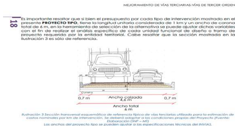
Figura 69. Sección transversal esquemática red vial terciaria.
