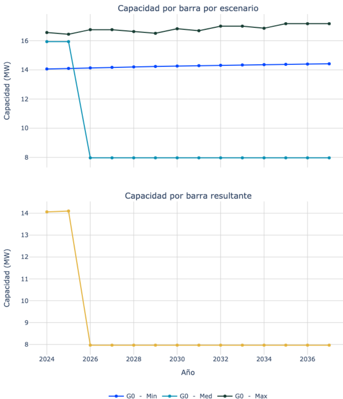
Figura 93. Capacidad de transporte de la subestación Tuluni_13.2A.
