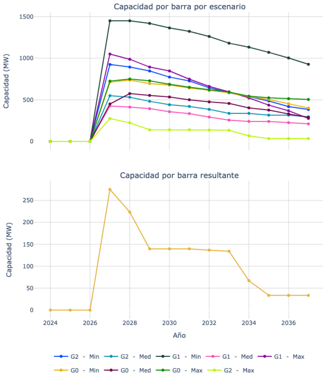
Figura 24. Capacidad de transporte de la subestación Carreto 500.
