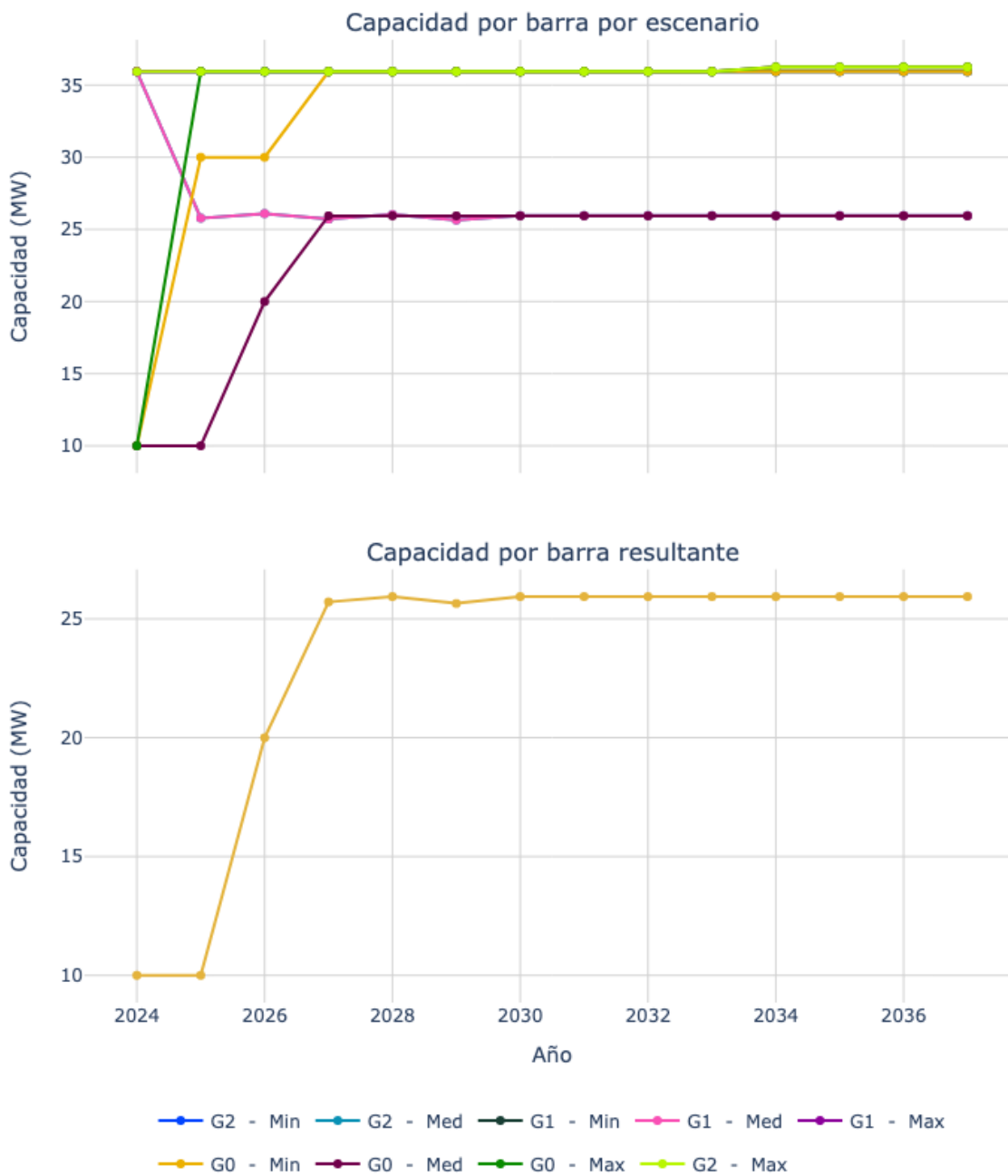
Figura 9. Capacidad de transporte de la subestación Bayunca 34.5.
