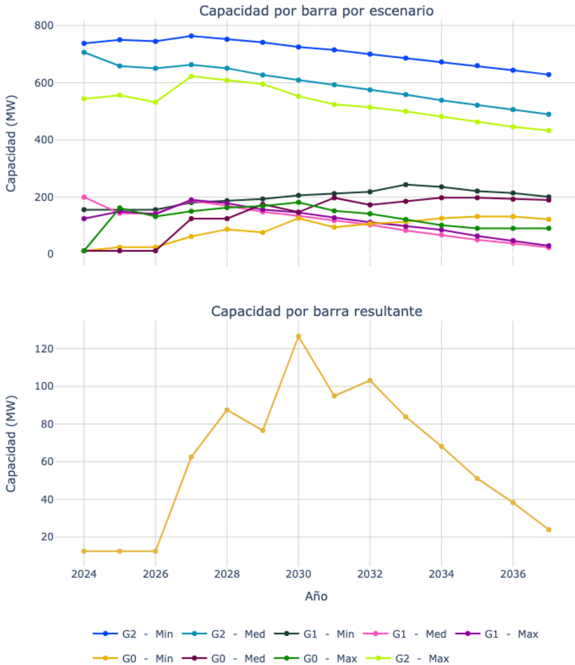
Figura 26. Capacidad de transporte de la subestación Cartagena 220.
