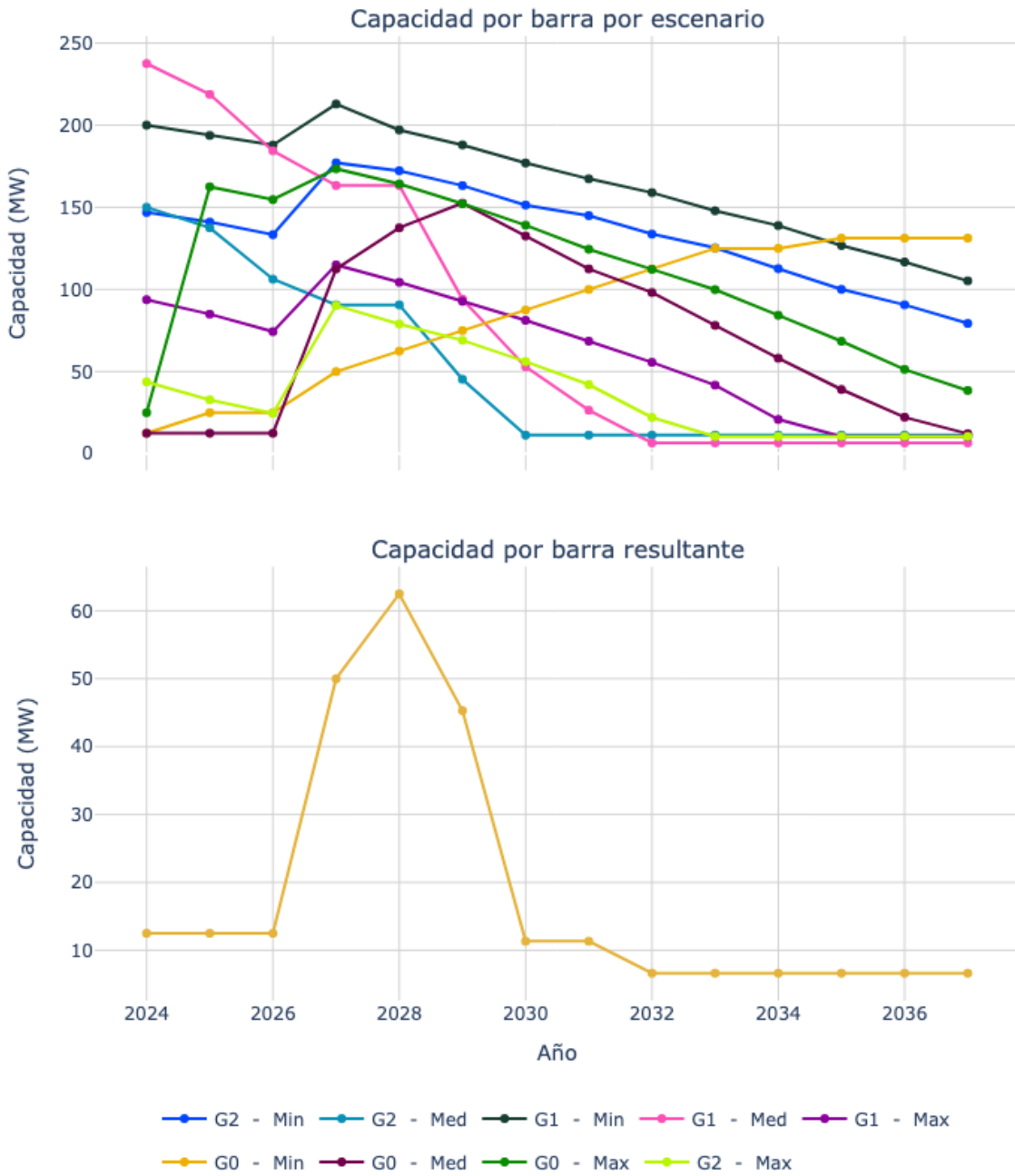
Figura 17. Capacidad de transporte de la subestación Bosque 66.
