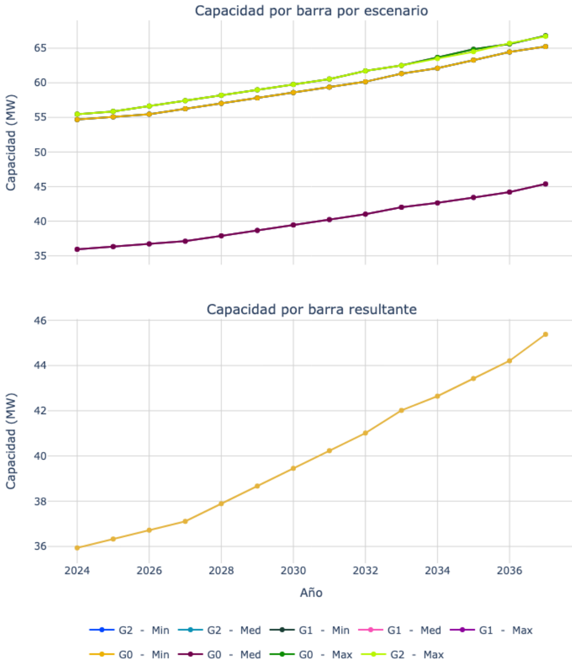
Figura 60. Capacidad de transporte de la subestación Zambrano 66.
