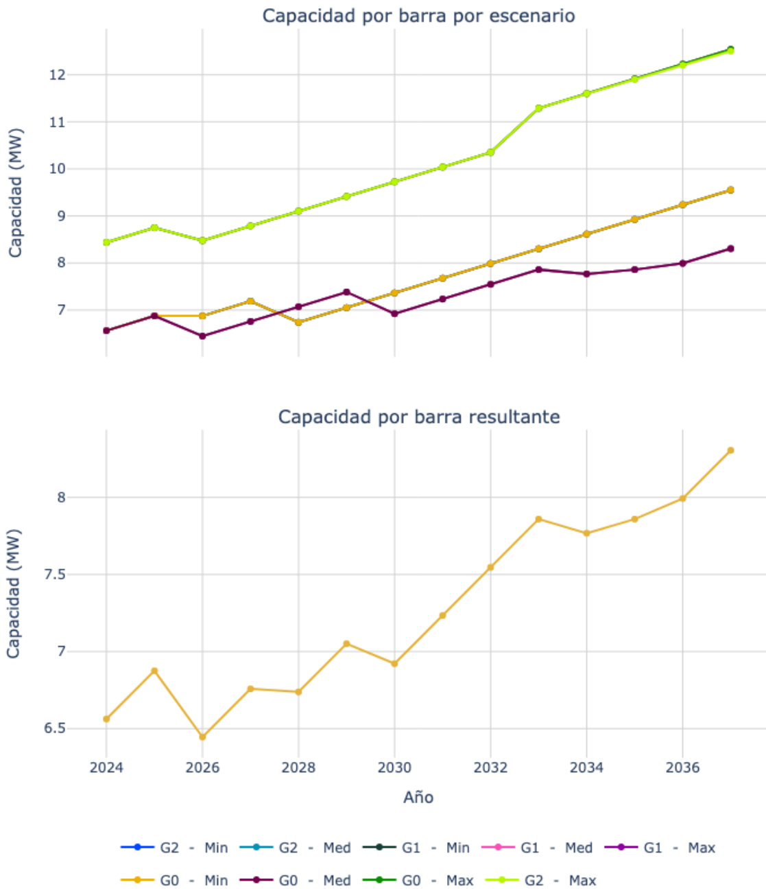
Figura 50. Capacidad de transporte de la subestación San Jacinto 13.8.
