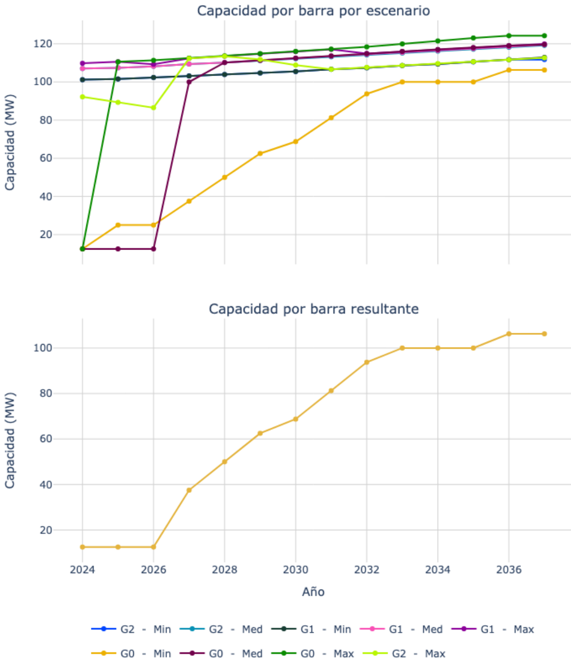
Figura 21. Capacidad de transporte de la subestación Campestre 66.
