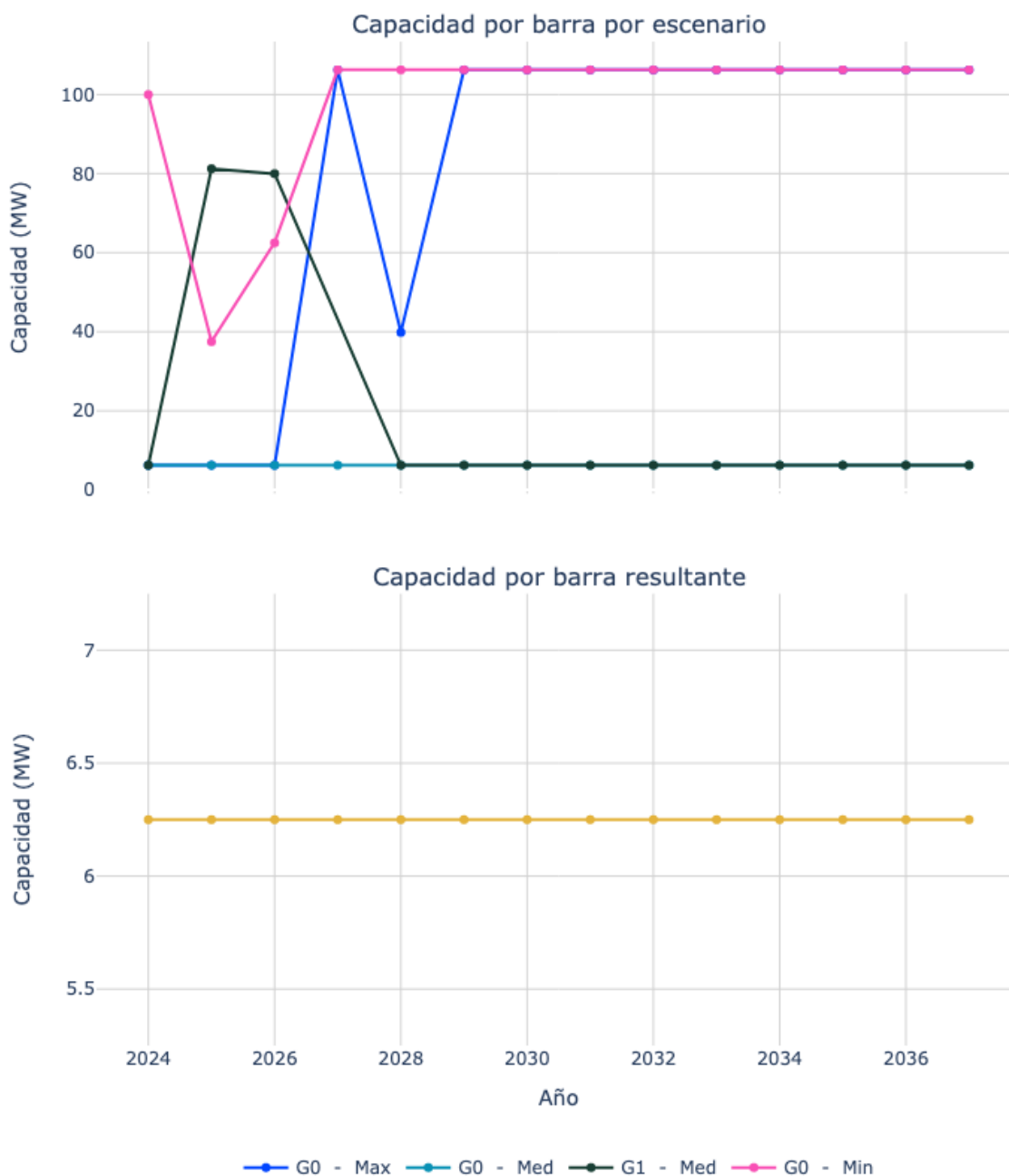
Figura 13. Capacidad de transporte de la subestación Bavaria 115 kV.
