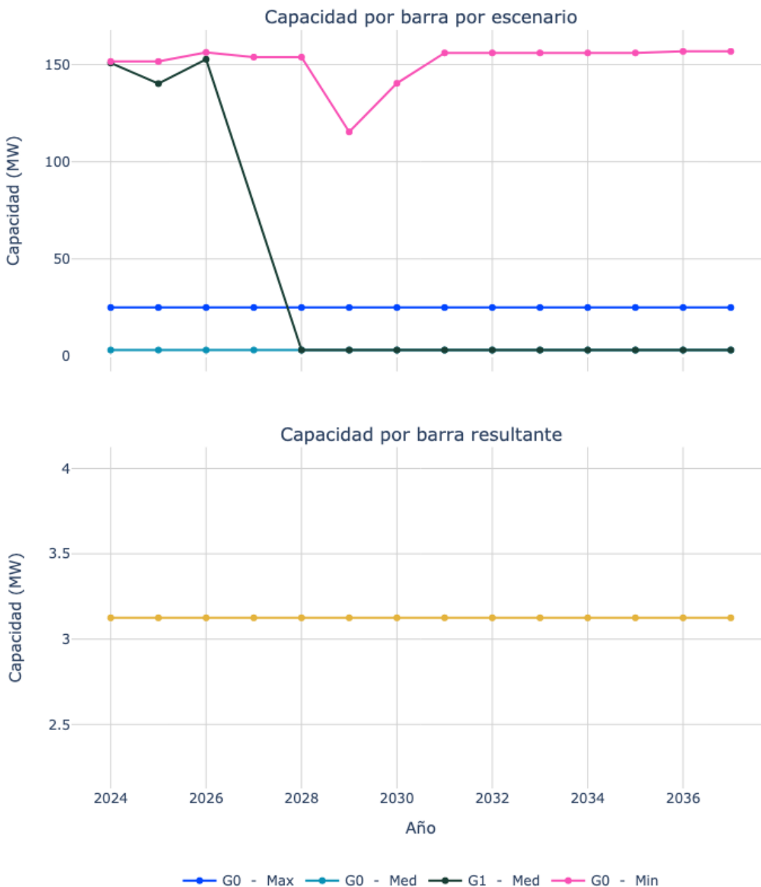
Figura 12. Capacidad de transporte de la subestación Alto Ricaurte 115.
