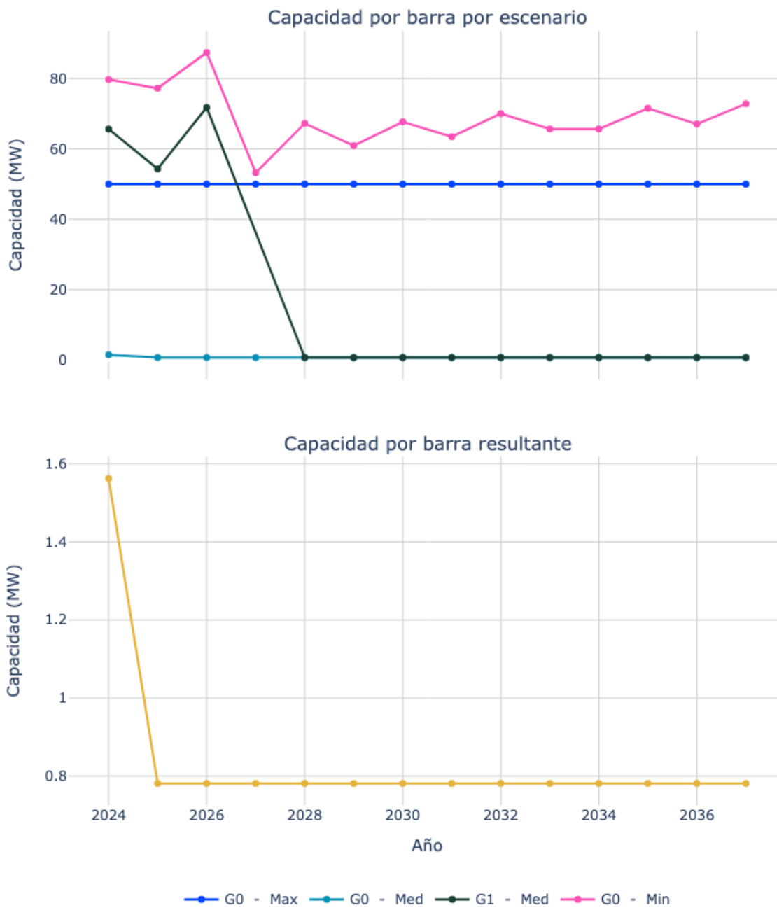
Figura 26. Capacidad de transporte de la subestación Guateque 115.
