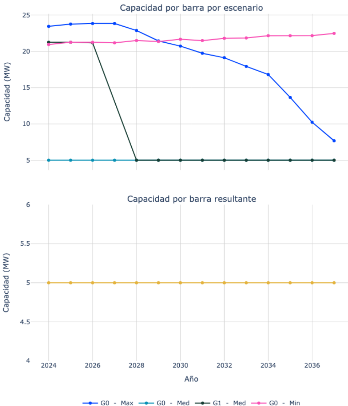
Figura 29. Capacidad de transporte de la subestación Iraka 34.5.
