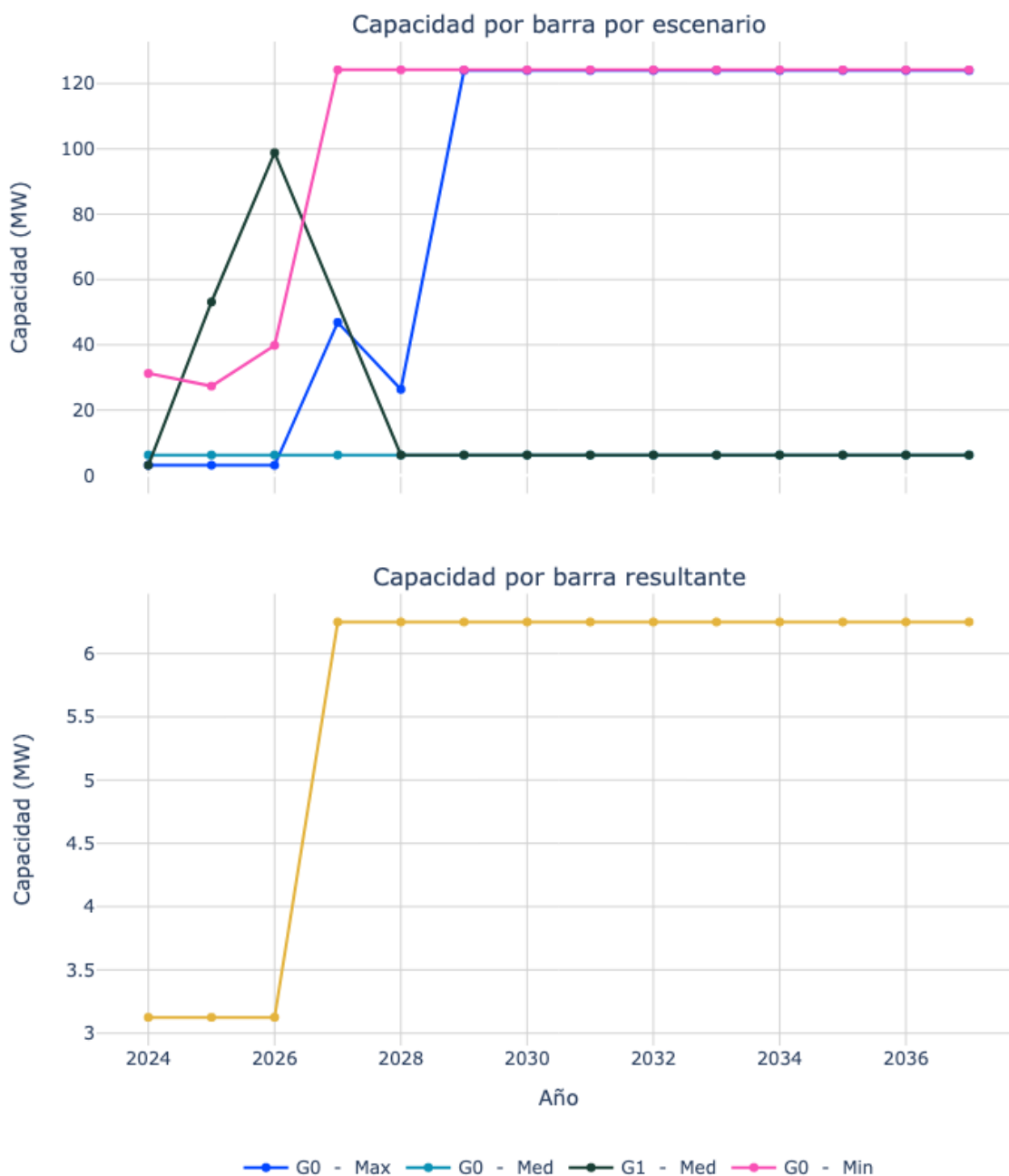
Figura 27. Capacidad de transporte de la subestación Holcim 115 kV.
