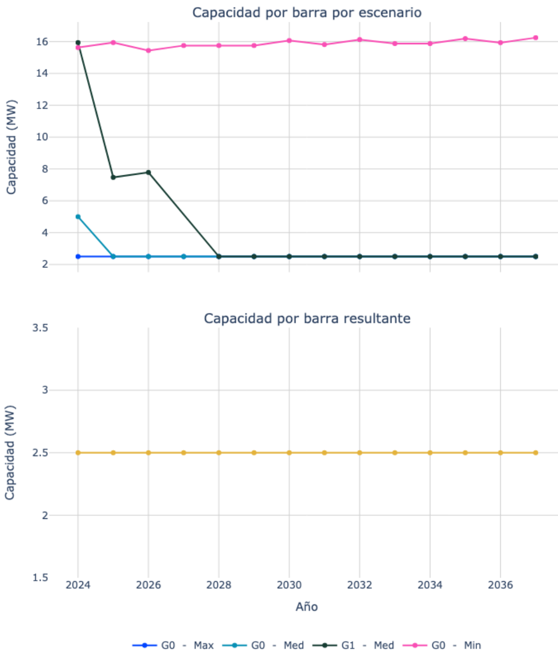
Figura 18. Capacidad de transporte de la subestación Combita 34.5.
