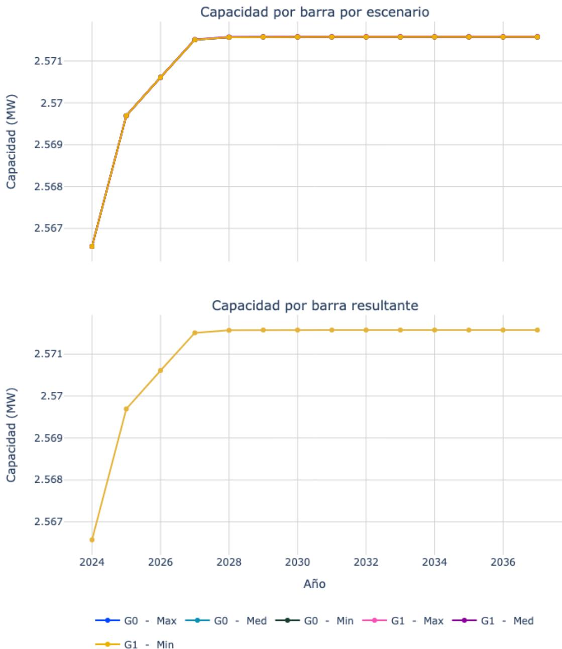
Figura 68. Capacidad de transporte de la subestación Manzanares 13.8.
