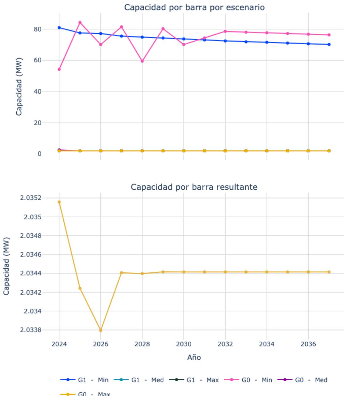
Figura 32. Capacidad de transporte de la subestación Cuba 33.
