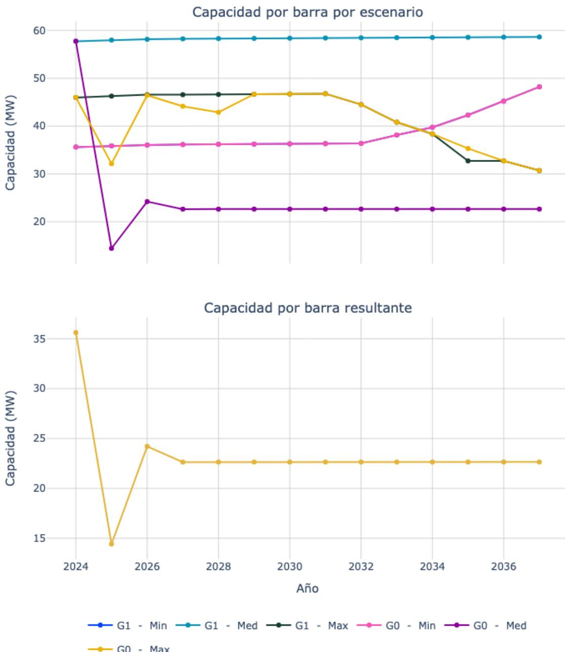
Figura 121. Capacidad de transporte de la subestación Viterbo 33.
