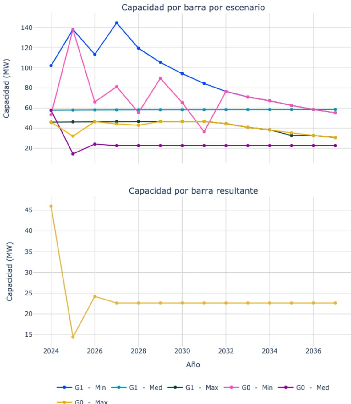
Figura 120. Capacidad de transporte de la subestación Viterbo 115.
