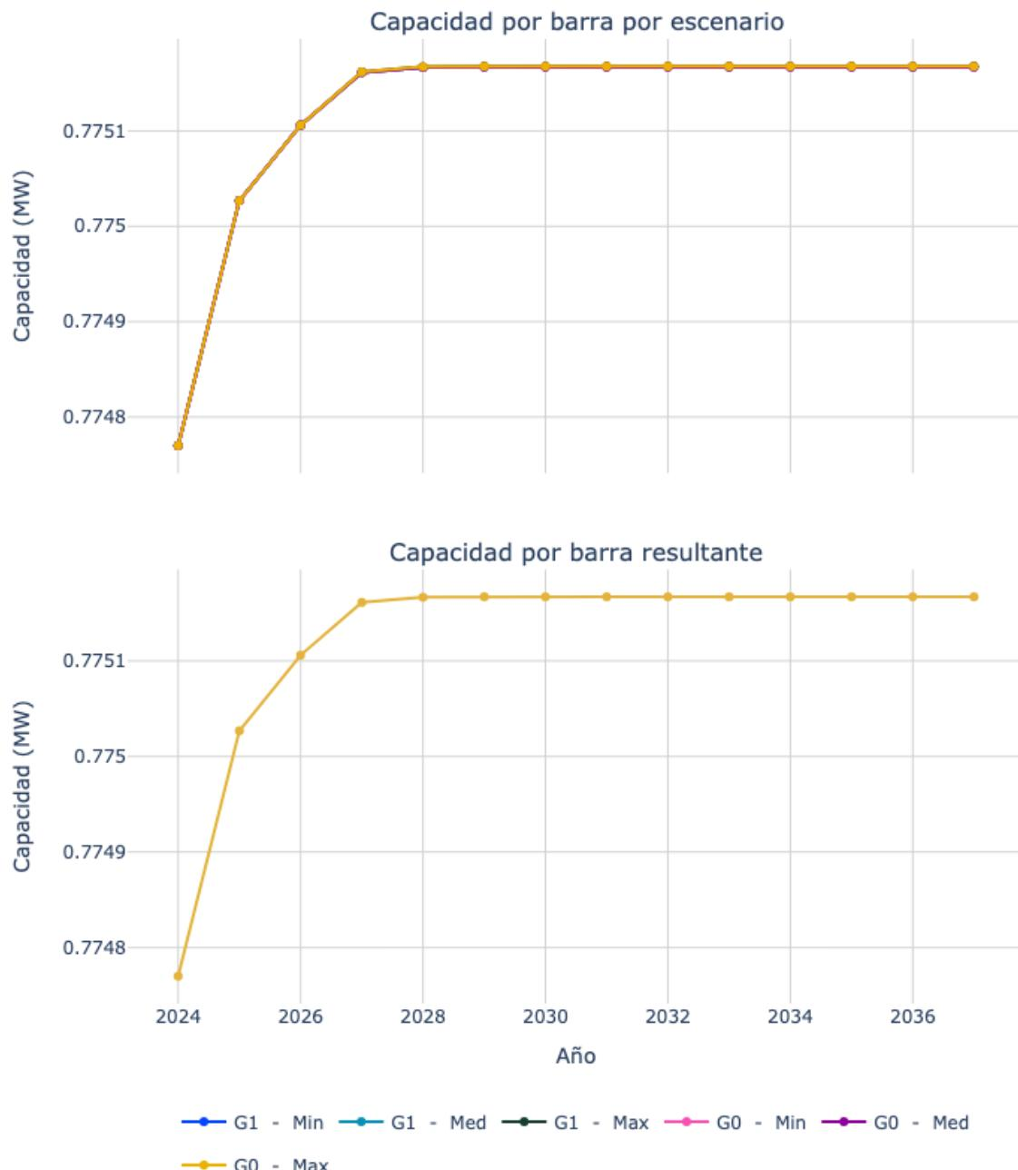
Figura 114. Capacidad de transporte de la subestación Victoria 33.
