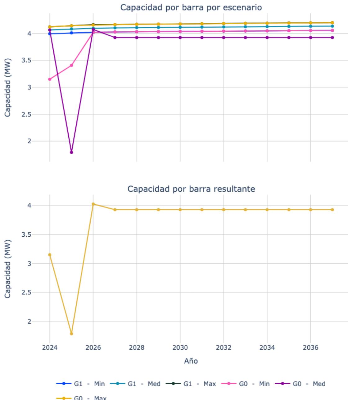
Figura 103. Capacidad de transporte de la subestación San Antonio del Chami 33.
