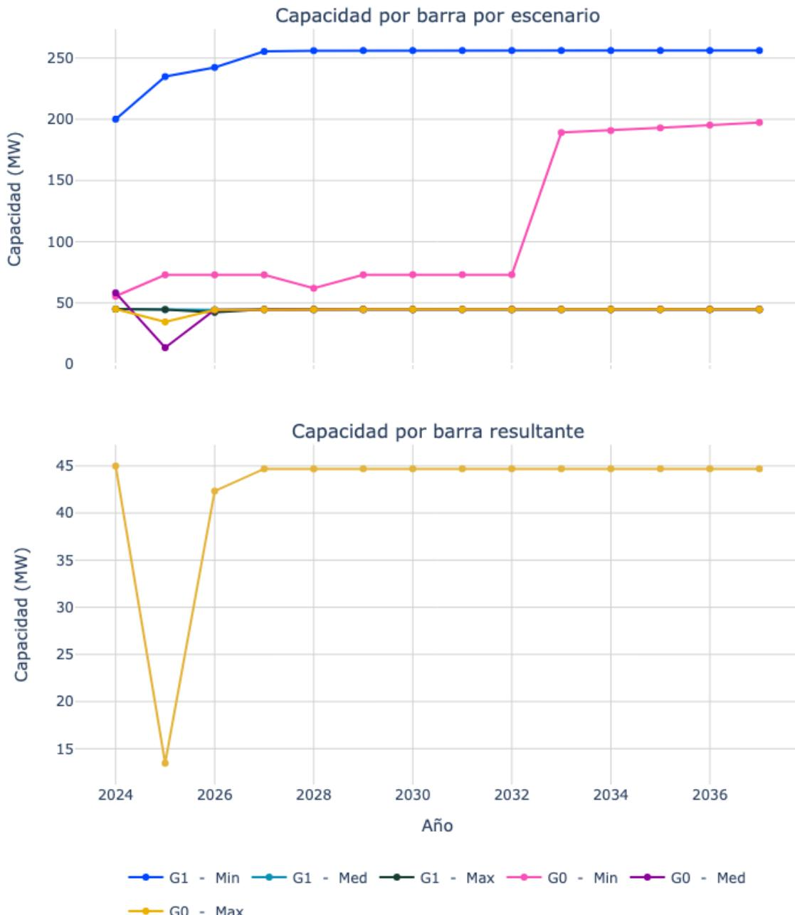
Figura 60. Capacidad de transporte de la subestación La Rosa 115.
