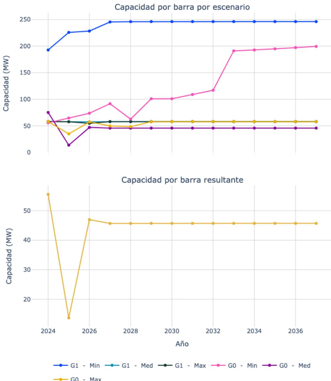
Figura 48. Capacidad de transporte de la subestación Hermosa 115.
