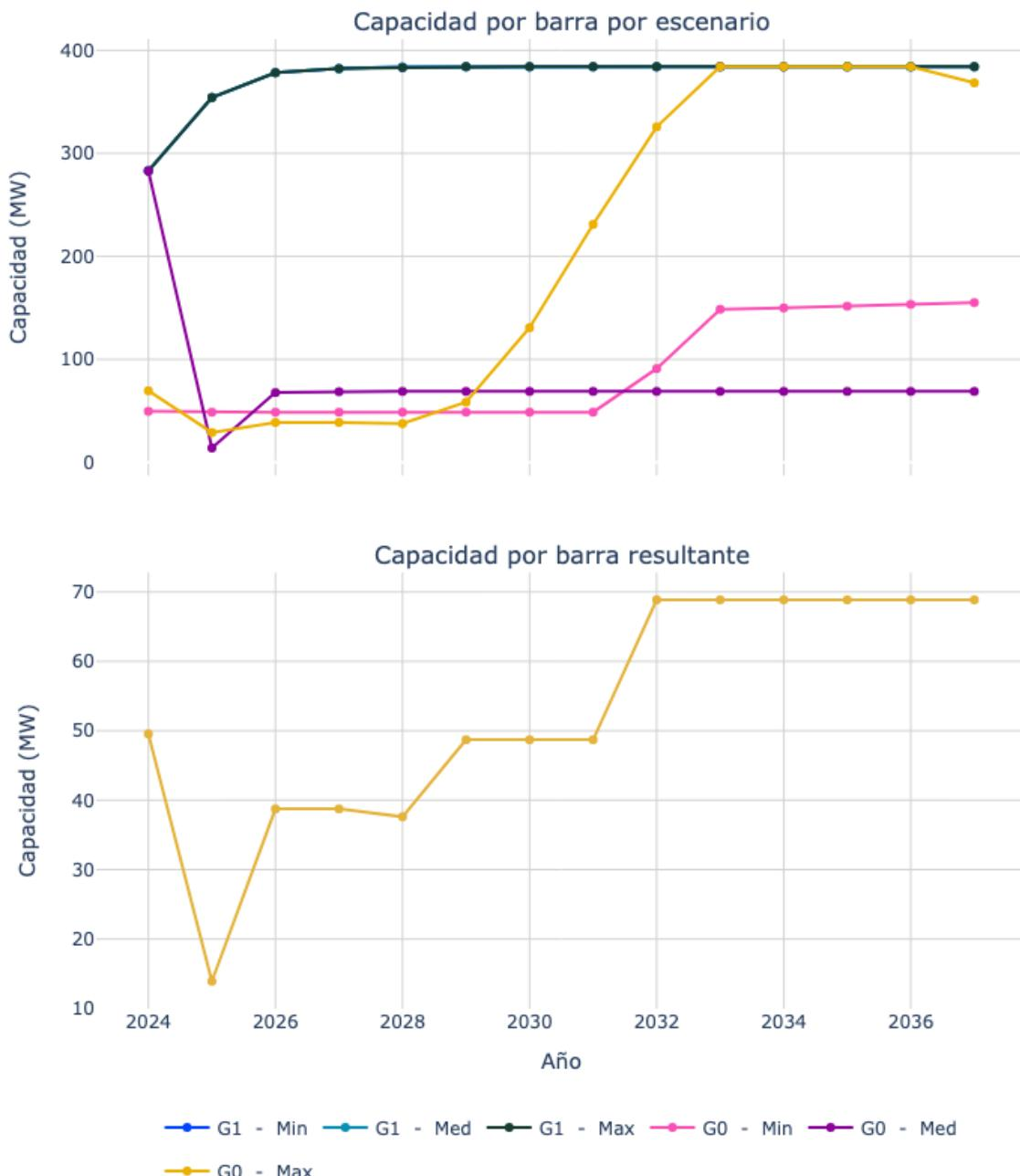
Figura 42. Capacidad de transporte de la subestación Esmeralda 220.
