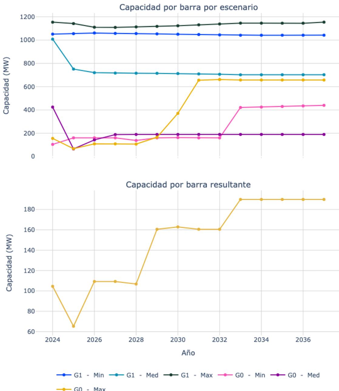
Figura 58. Capacidad de transporte de la subestación La Miel 220.
