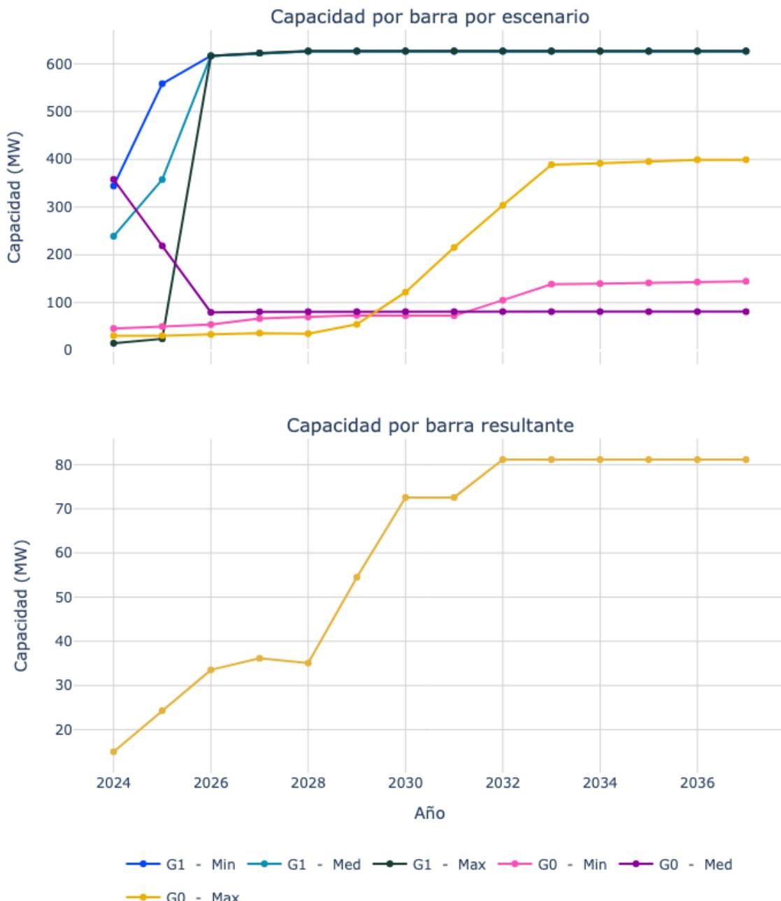
Figura 119. Capacidad de transporte de la subestación Virginia 500.
