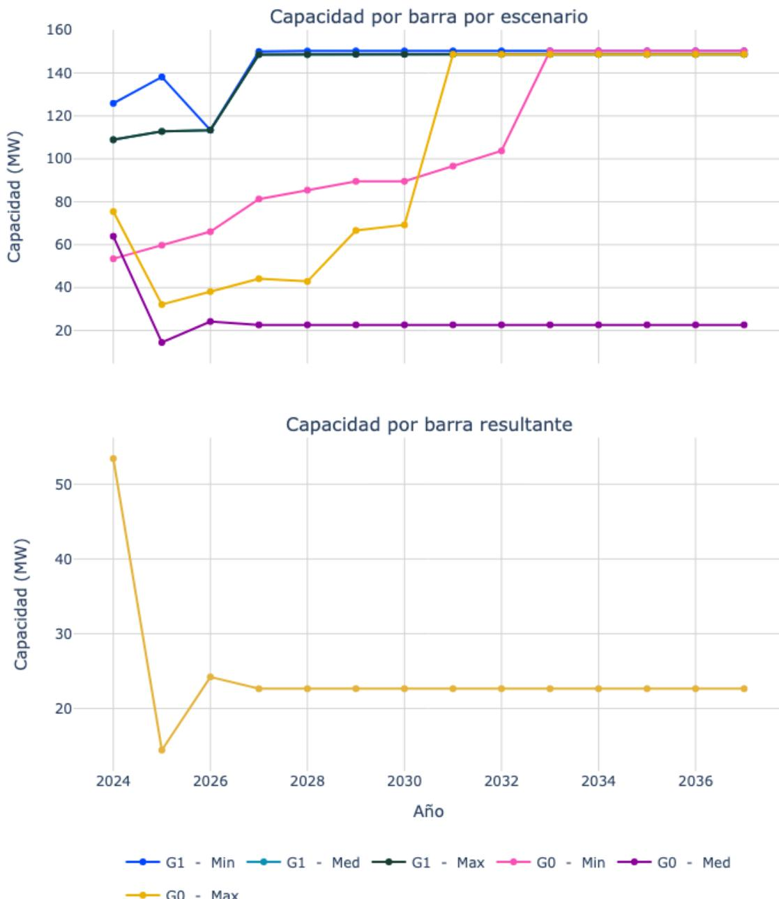
Figura 44. Capacidad de transporte de la subestación Esmeralda CQR 115.
