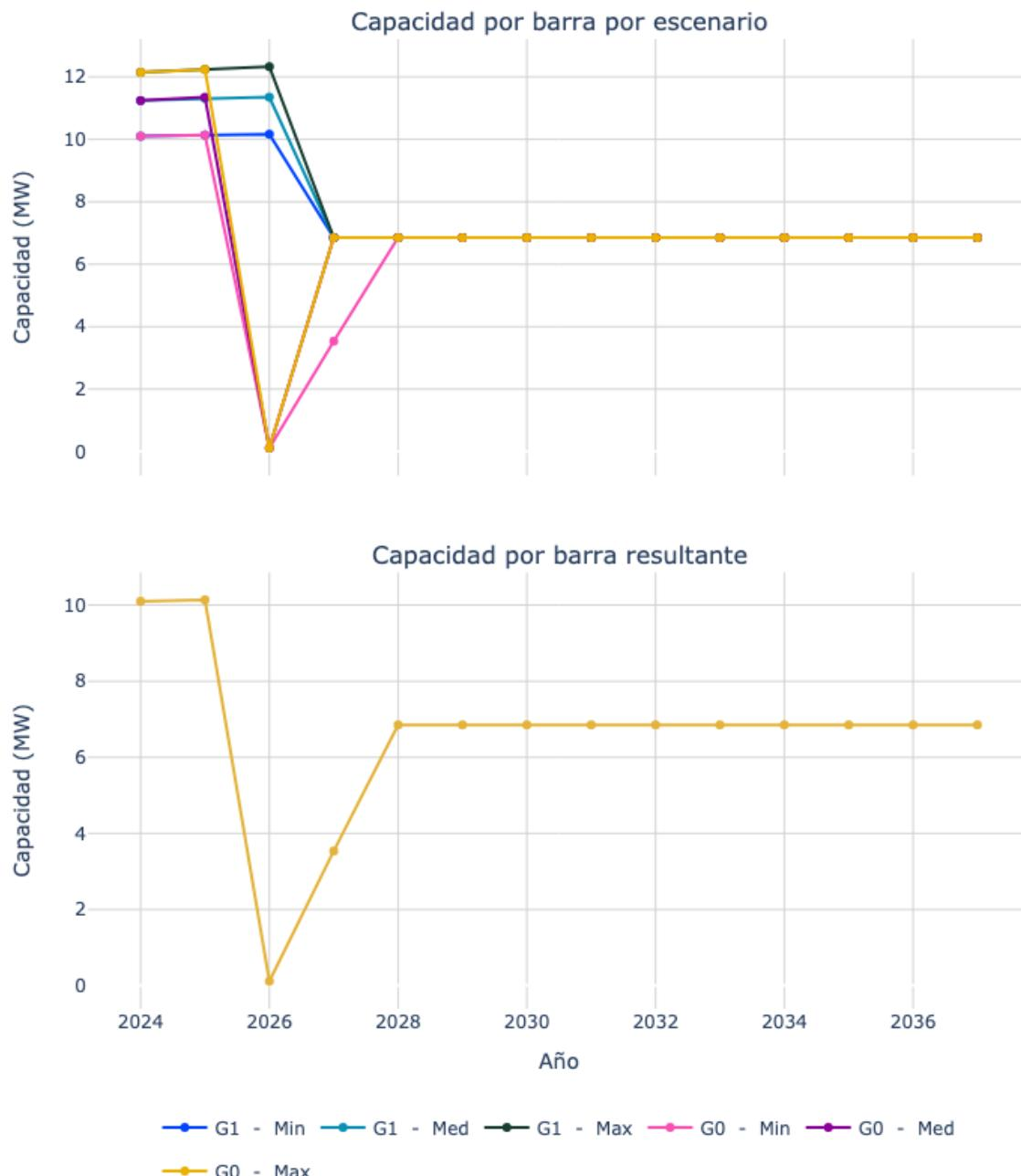
Figura 80. Capacidad de transporte de la subestación Pacora 33.
