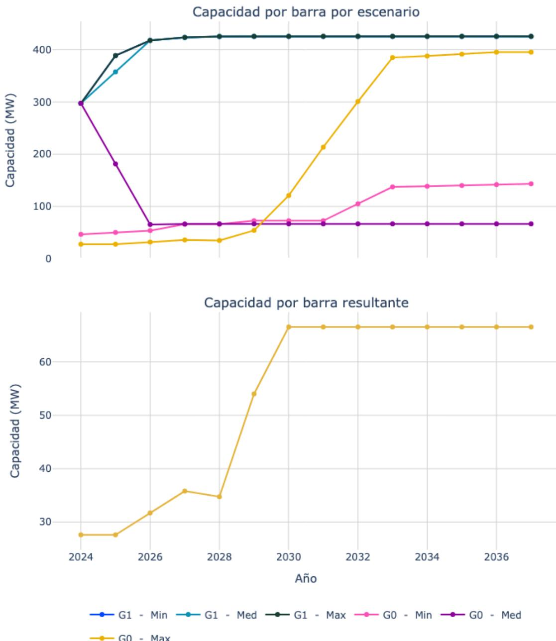
Figura 117. Capacidad de transporte de la subestación Virginia 220.
