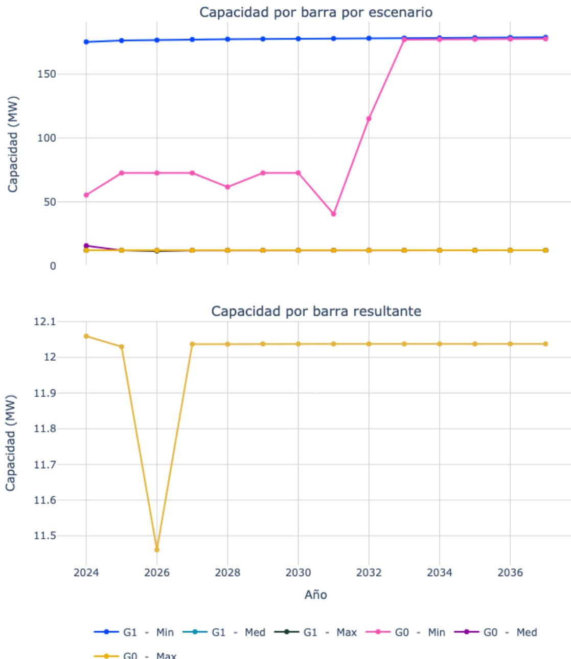
Figura 30. Capacidad de transporte de la subestación Cuba 115.
