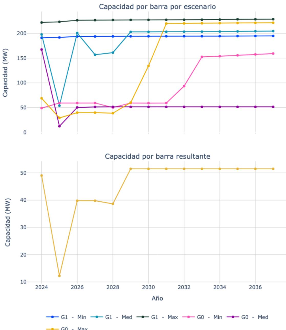
Figura 83. Capacidad de transporte de la subestación Pavas 115.
