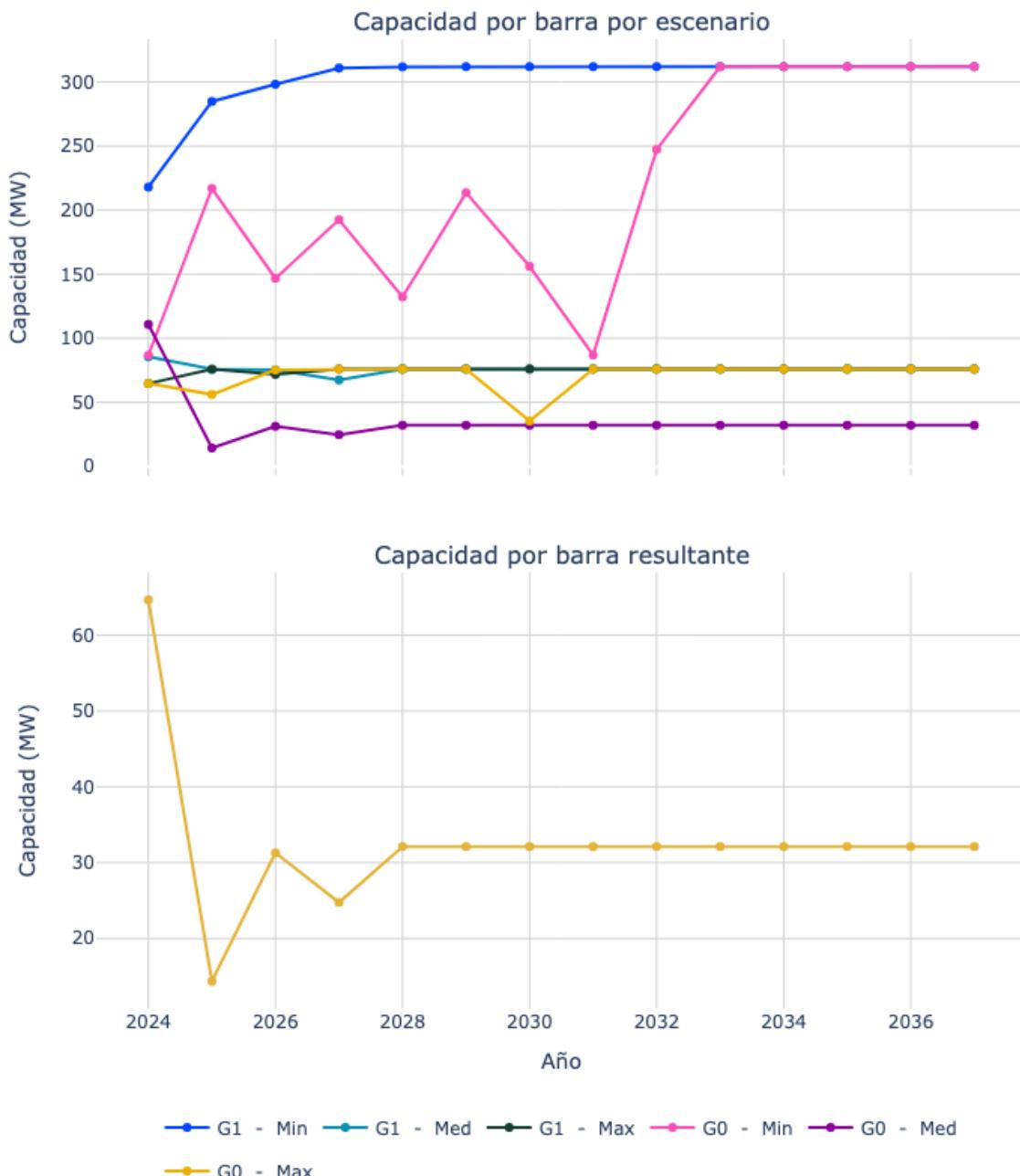
Figura 95. Capacidad de transporte de la subestación Regivit 115.
