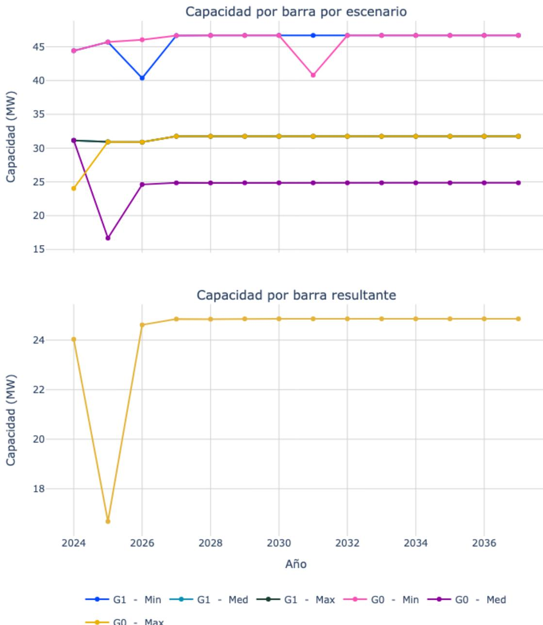
Figura 87. Capacidad de transporte de la subestación Peralonso 115.
