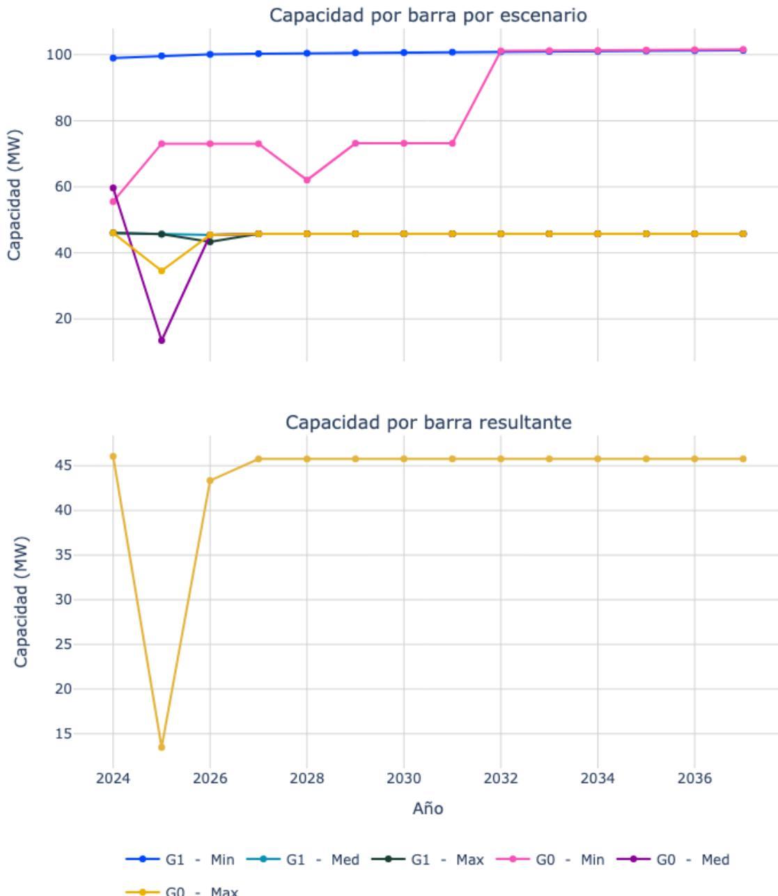
Figura 62. Capacidad de transporte de la subestación La rosa 33.
