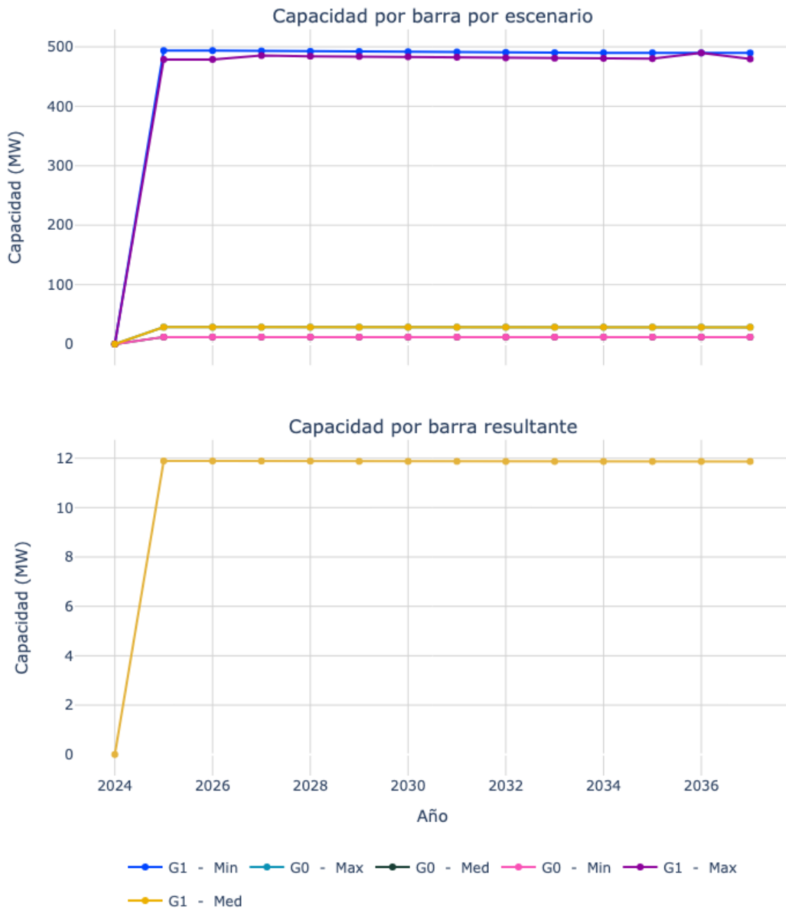
Figura 31. Capacidad de transporte de la subestación Renacer 115.
