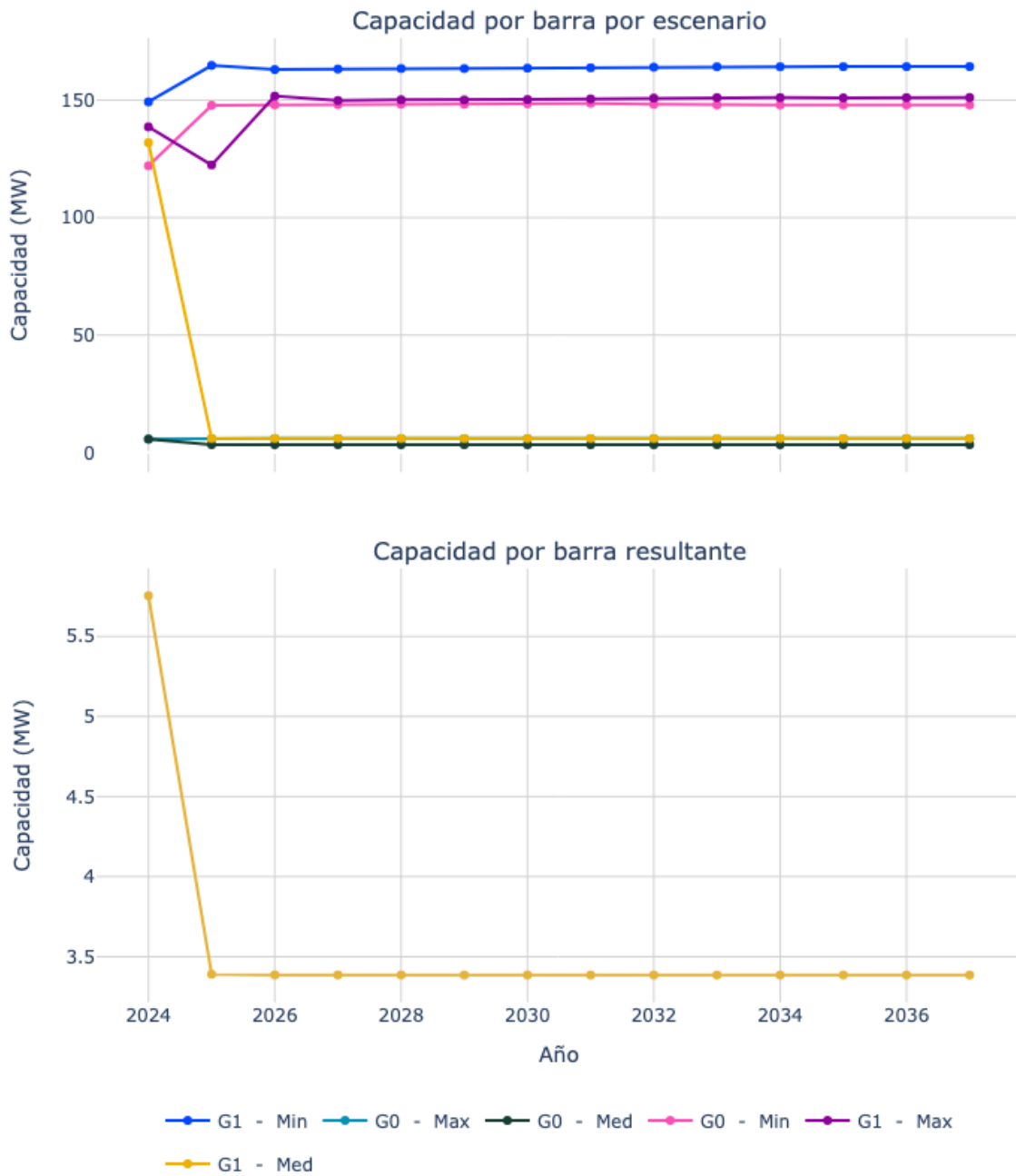
Figura 36. Capacidad de transporte de la subestación San Martin 115.
