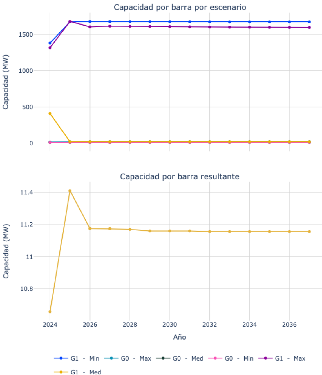
Figura 15. Capacidad de transporte de la subestación Jamondino 220.
