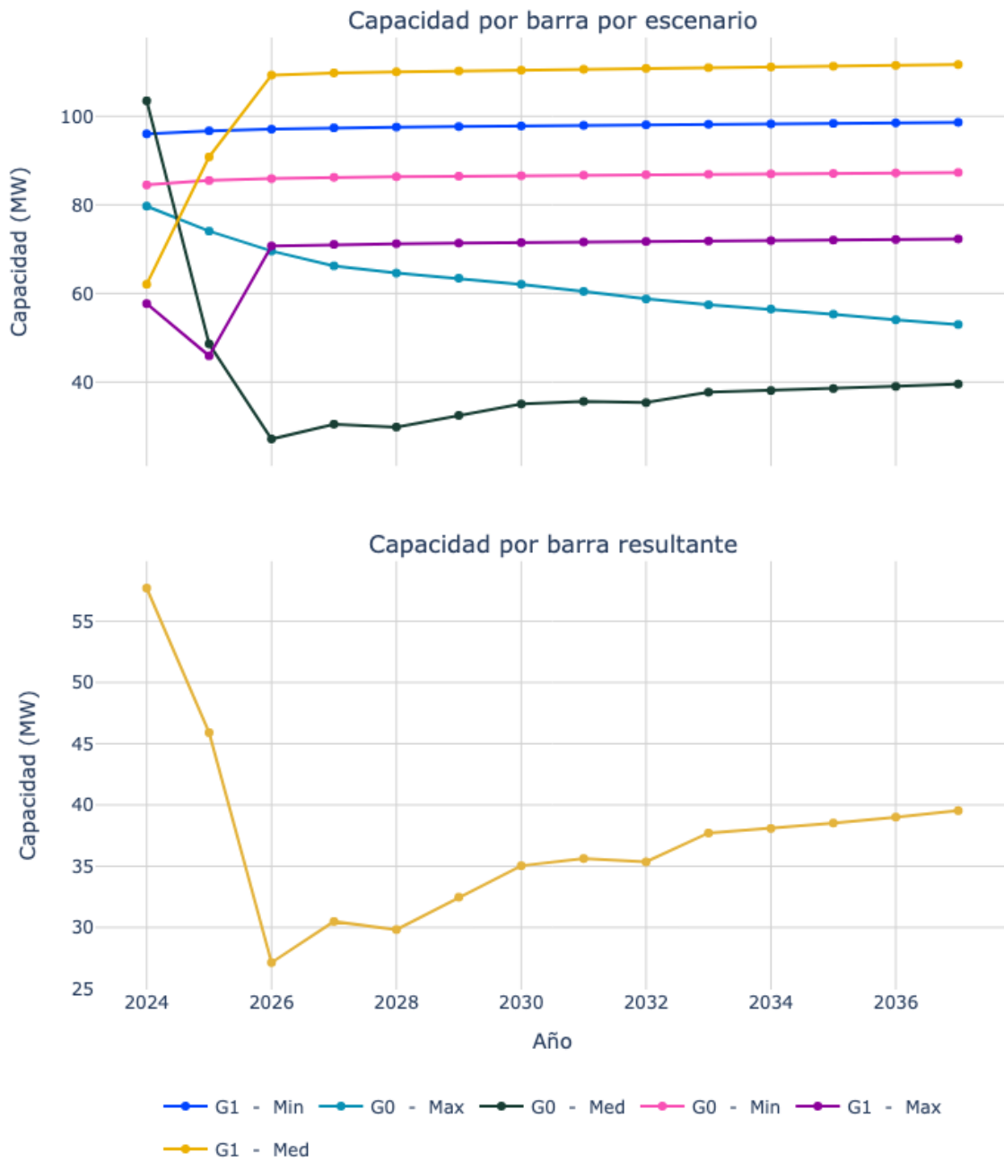
Figura 29. Capacidad de transporte de la subestación Popayan 34.5.
