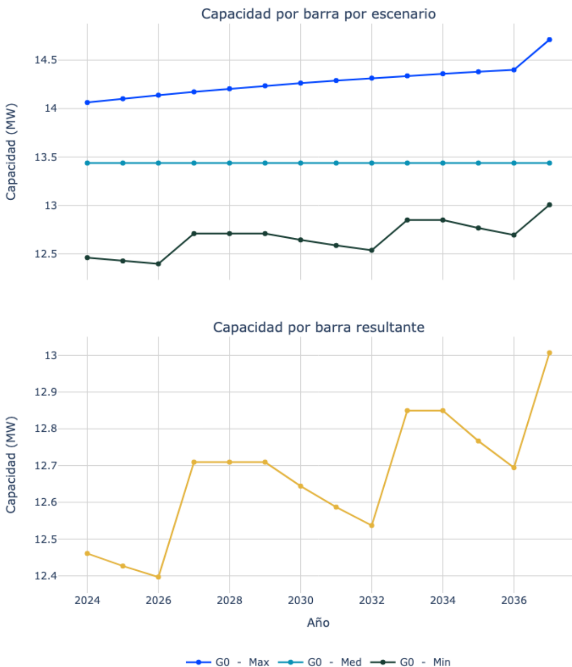
Figura 18. Capacidad de transporte de la subestación B1_Melgar.
