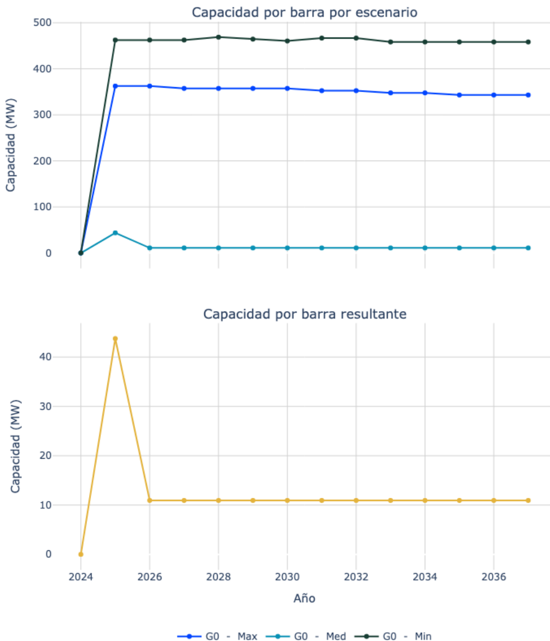
Figura 79. Capacidad de transporte de la subestación Salado 115.
