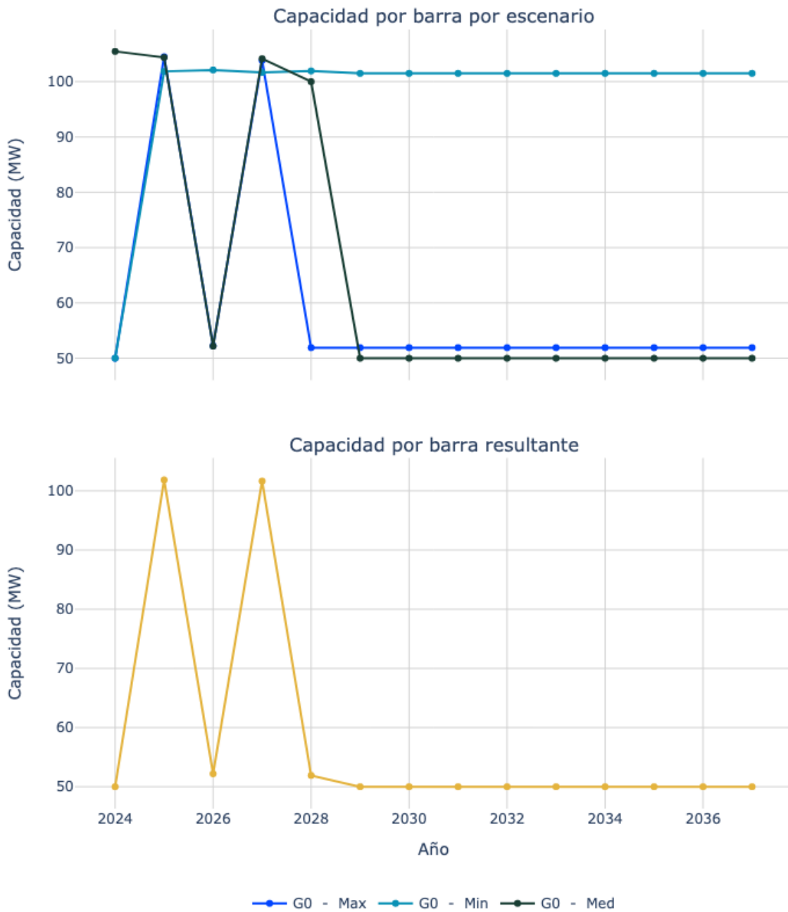
Figura 109. Capacidad de transporte de la subestación Pavco 115.
