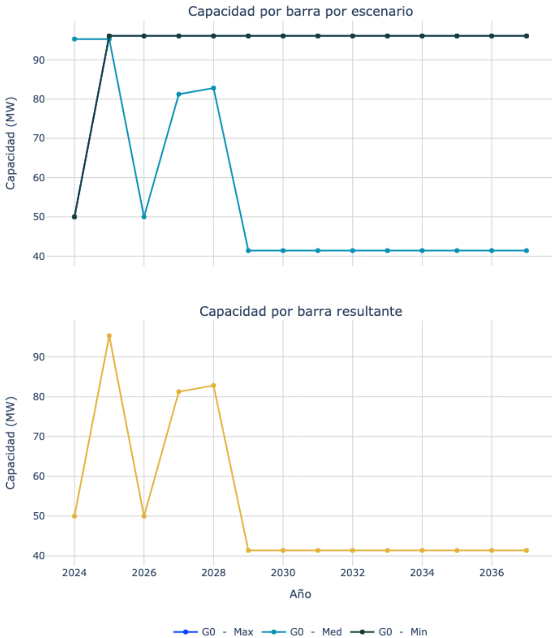
Figura 121. Capacidad de transporte de la subestación Salto II 115.
