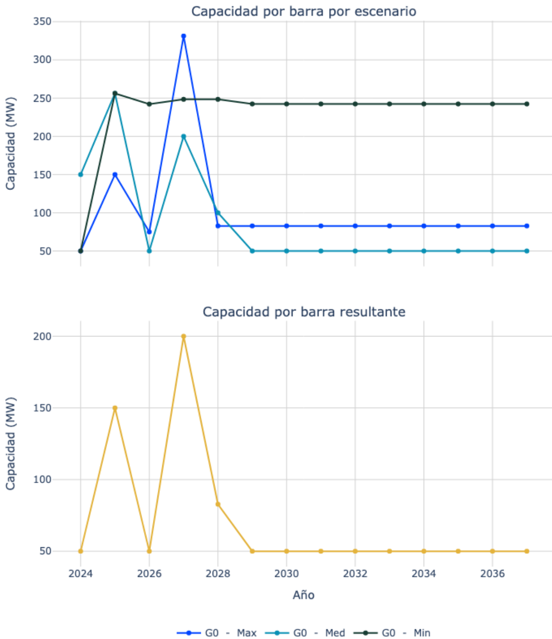
Figura 69. Capacidad de transporte de la subestación Guaca 115.
