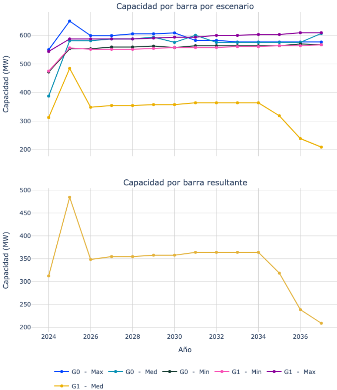
Figura 13. Capacidad de transporte de la subestación Barranca 220.
