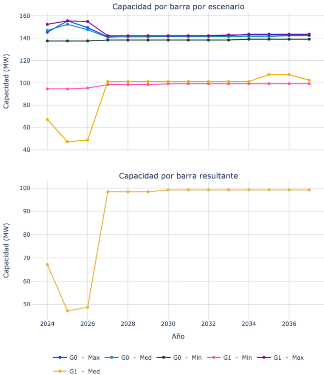
Figura 41. Capacidad de transporte de la subestación Oiba 115.
