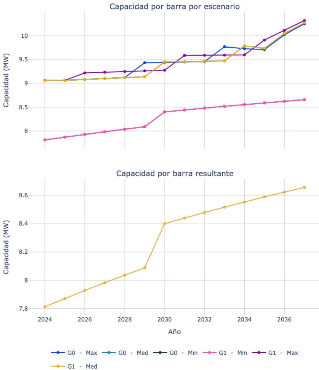
Figura 22. Capacidad de transporte de la subestación Cimitarra 13.8.
