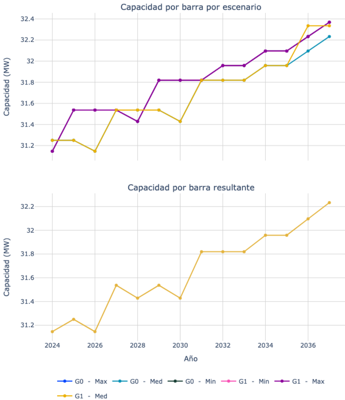
Figura 17. Capacidad de transporte de la subestación Bosconia 115.
