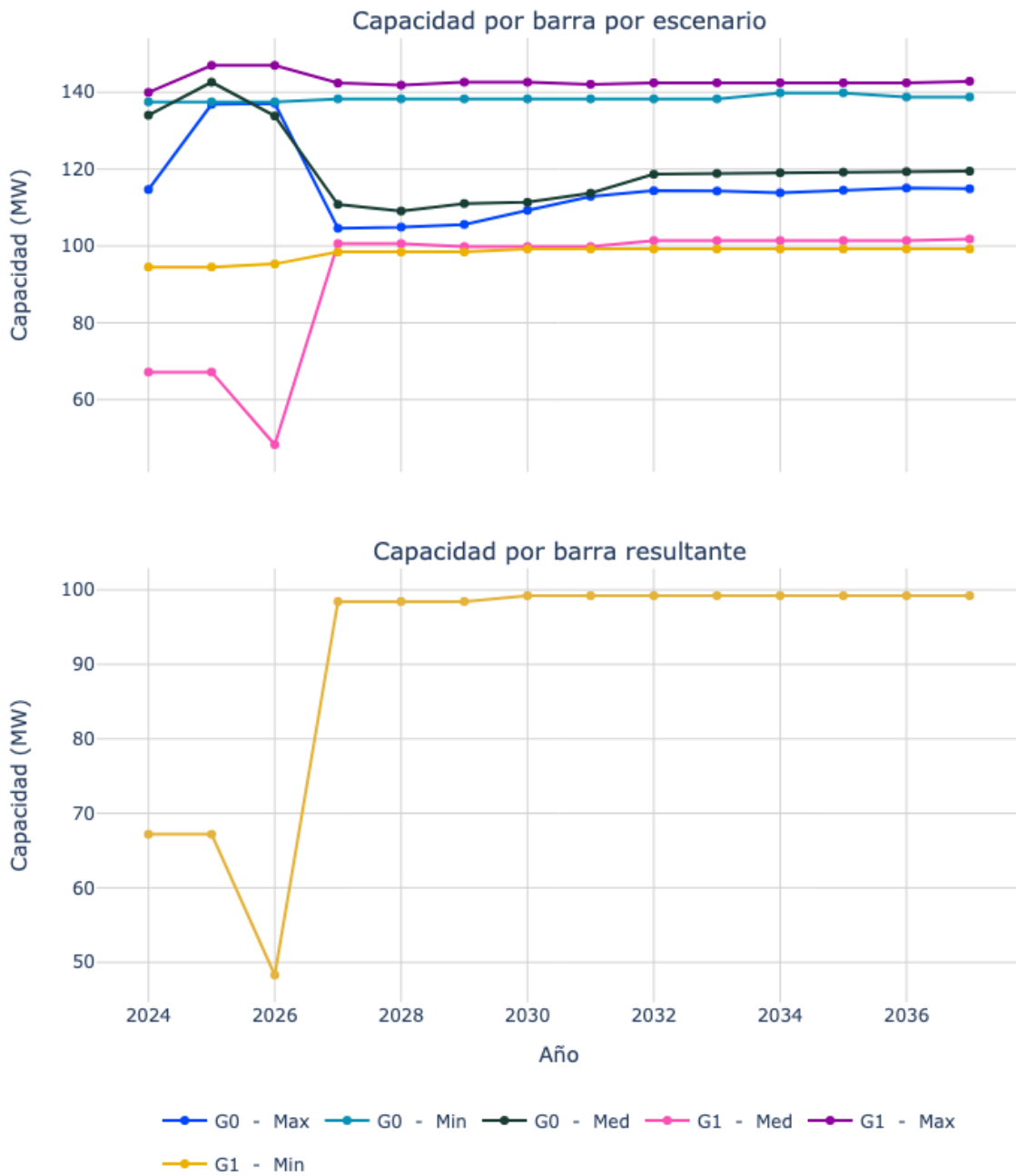
Figura 70. Capacidad de transporte de la subestación Suaita 115.
