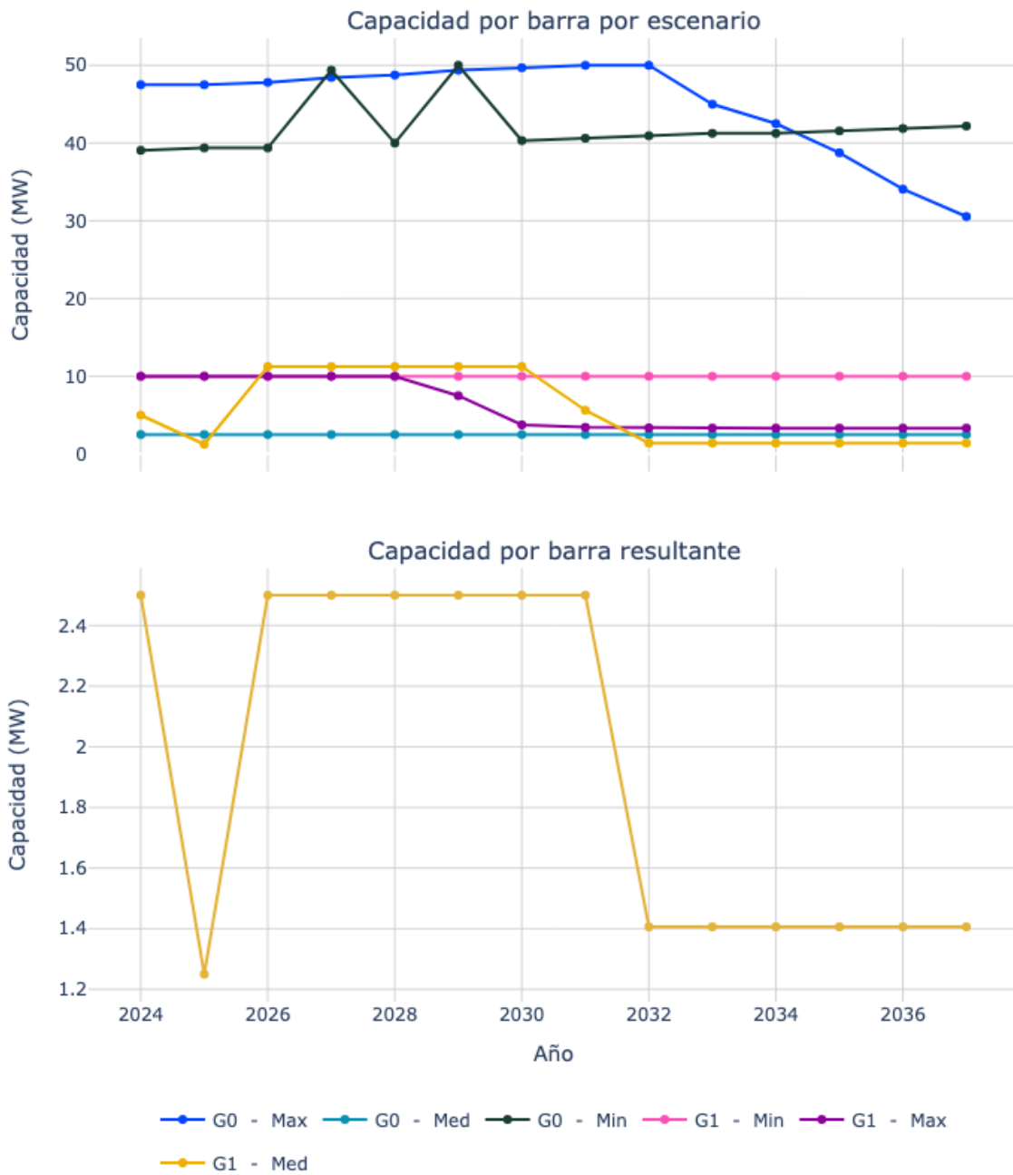
Figura 18. Capacidad de transporte de la subestación Bosque 34.5.
