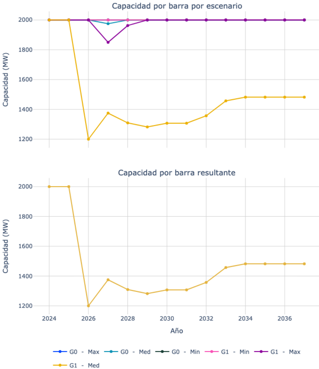
Figura 68. Capacidad de transporte de la subestación Sogamoso 500.
