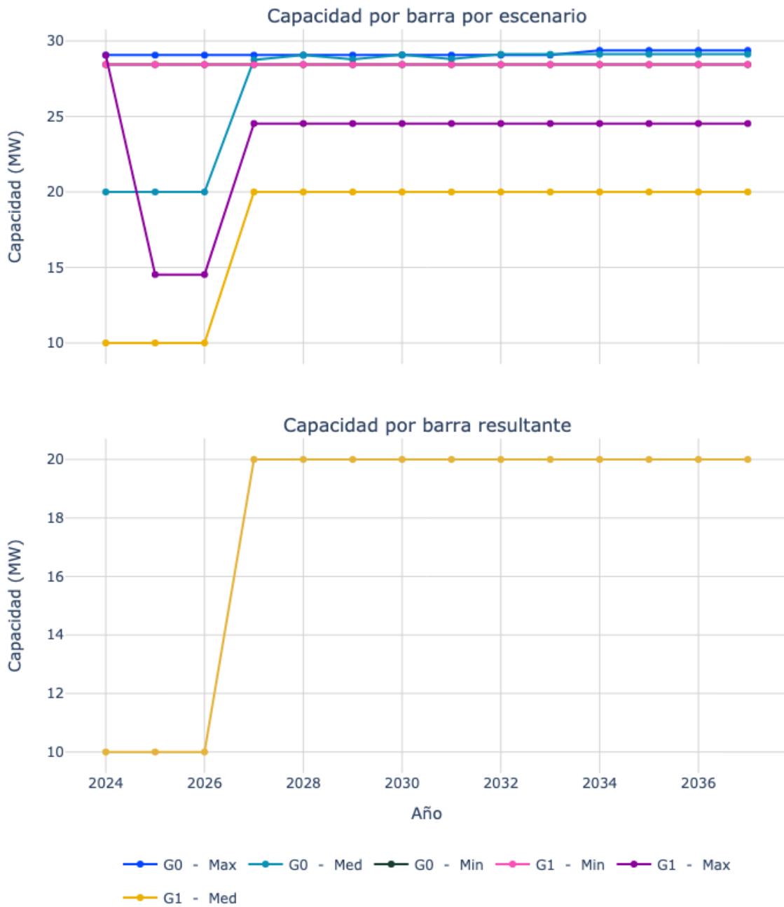
Figura 42. Capacidad de transporte de la subestación Oiba 34.5.
