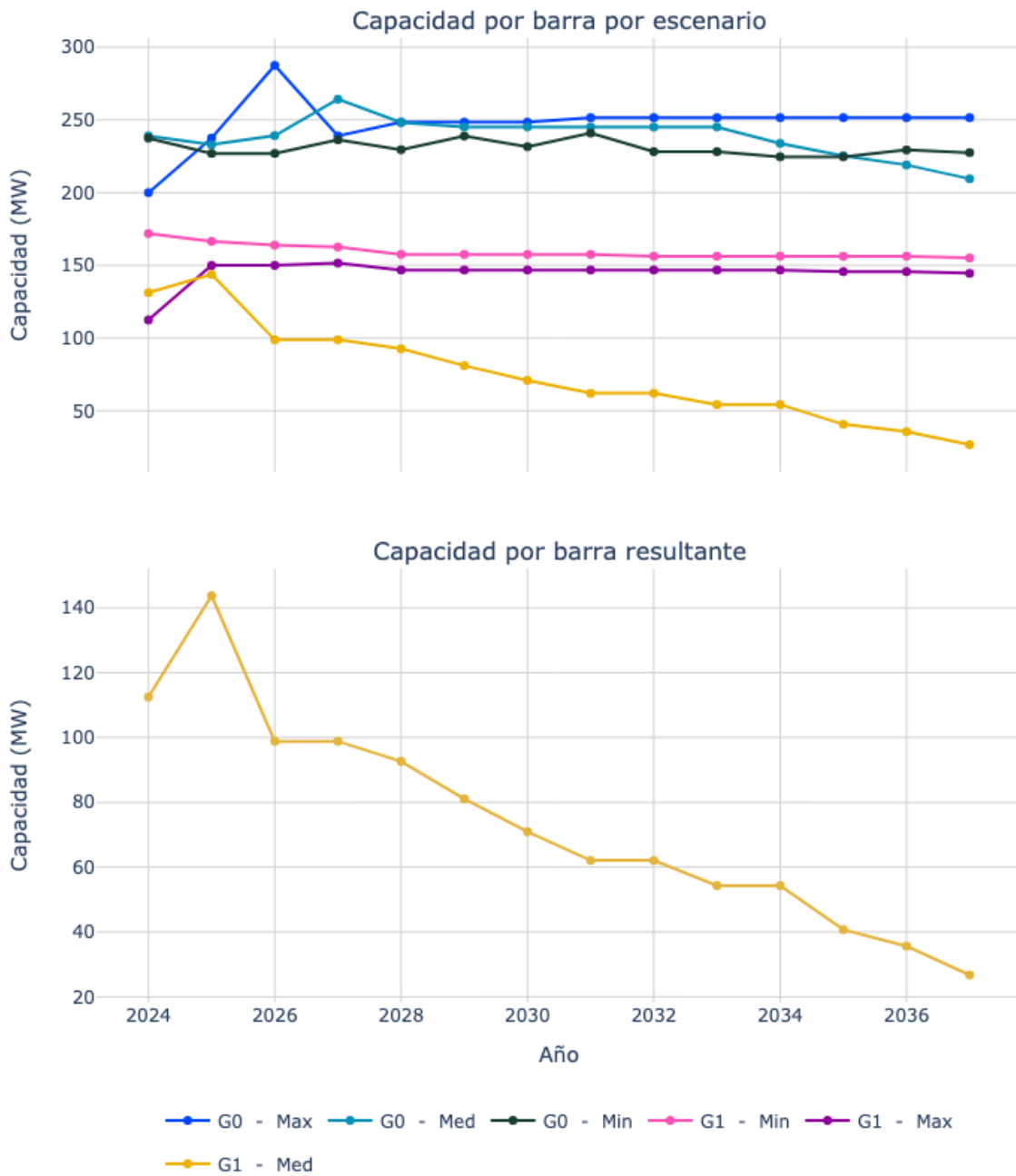
Figura 47. Capacidad de transporte de la subestación Palos 115.
