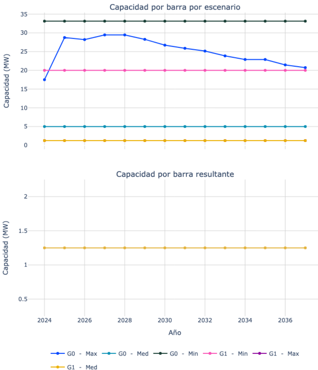
Figura 32. Capacidad de transporte de la subestación La Granja 34.5.
