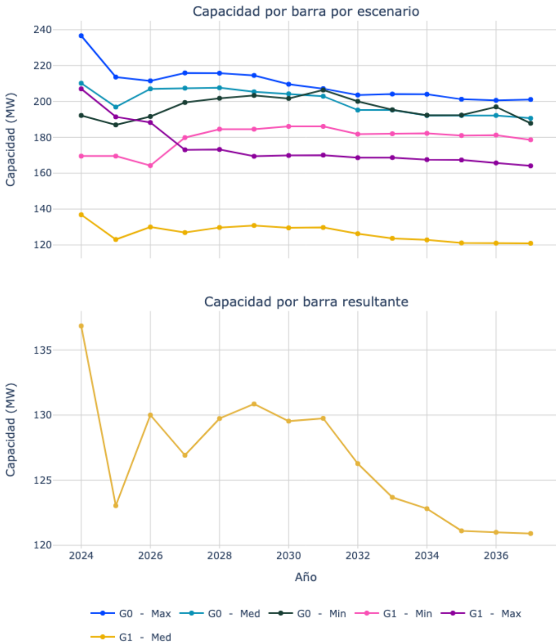
Figura 50. Capacidad de transporte de la subestación Piedecuesta 115.
