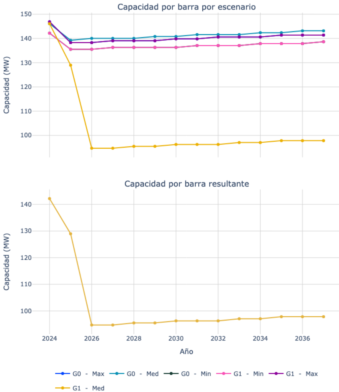
Figura 74. Capacidad de transporte de la subestación Wilches 115.
