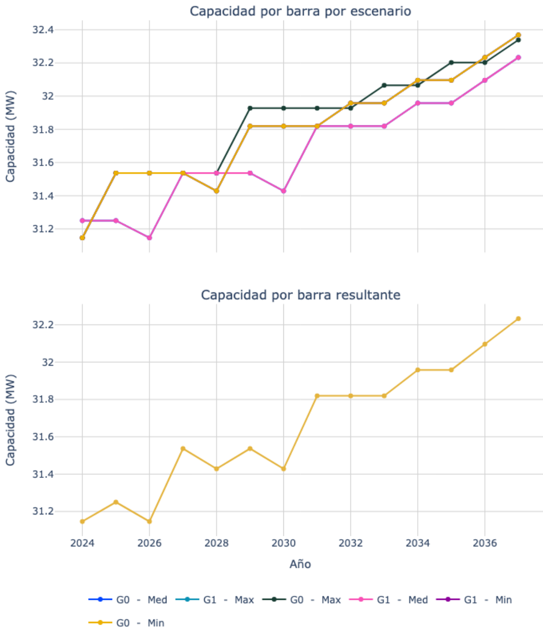
Figura 19. Capacidad de transporte de la subestación Bosconia 115.
