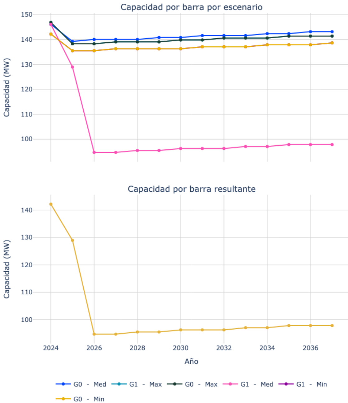
Figura 77. Capacidad de transporte de la subestación Wilches 115.
