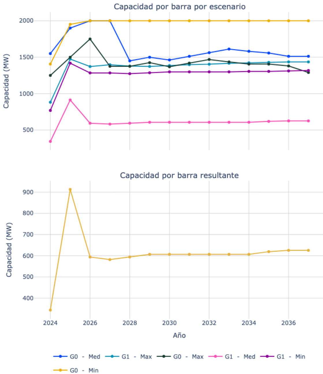
Figura 71. Capacidad de transporte de la subestación Sogamoso 220.
