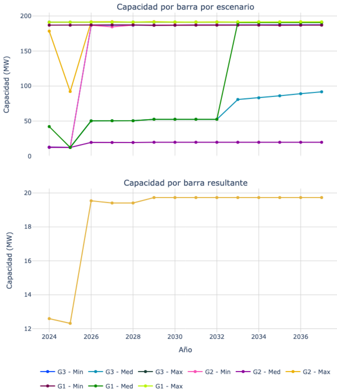
Figura 61. Capacidad de transporte de la subestación Papel Cauca 115.
