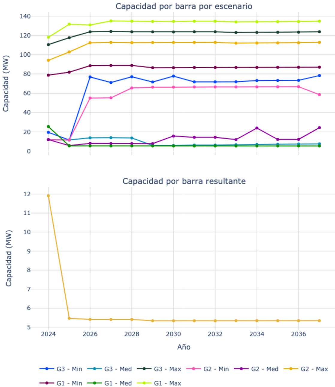
Figura 47. Capacidad de transporte de la subestación La Union 115.
