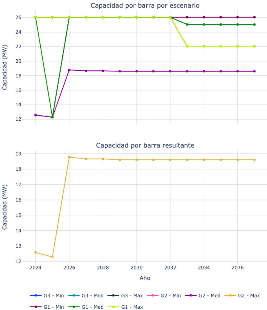
Figura 14. Capacidad de transporte de la subestación Alto Anchya 220.
