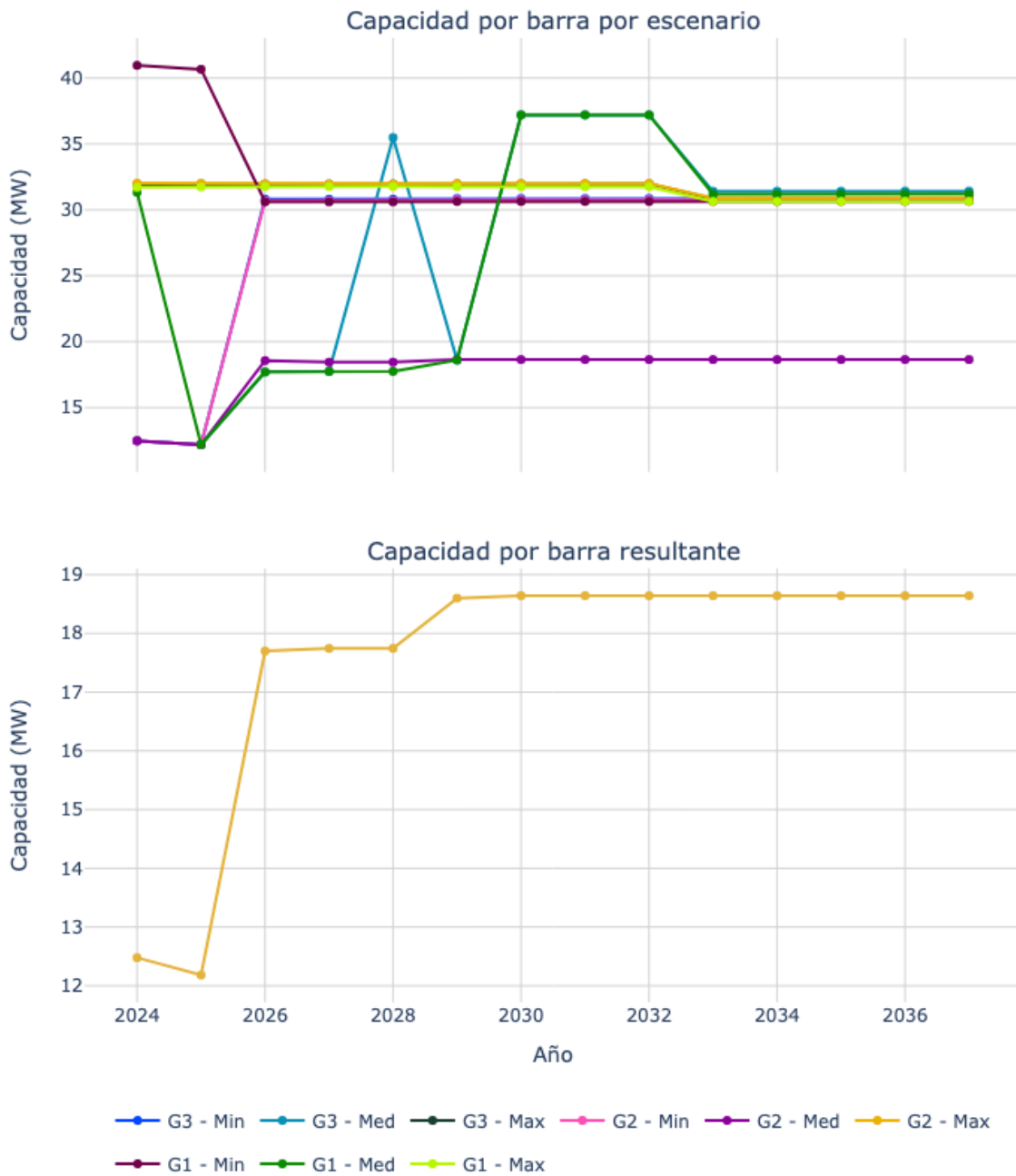
Figura 81. Capacidad de transporte de la subestación UPEREIRA 34.5.
