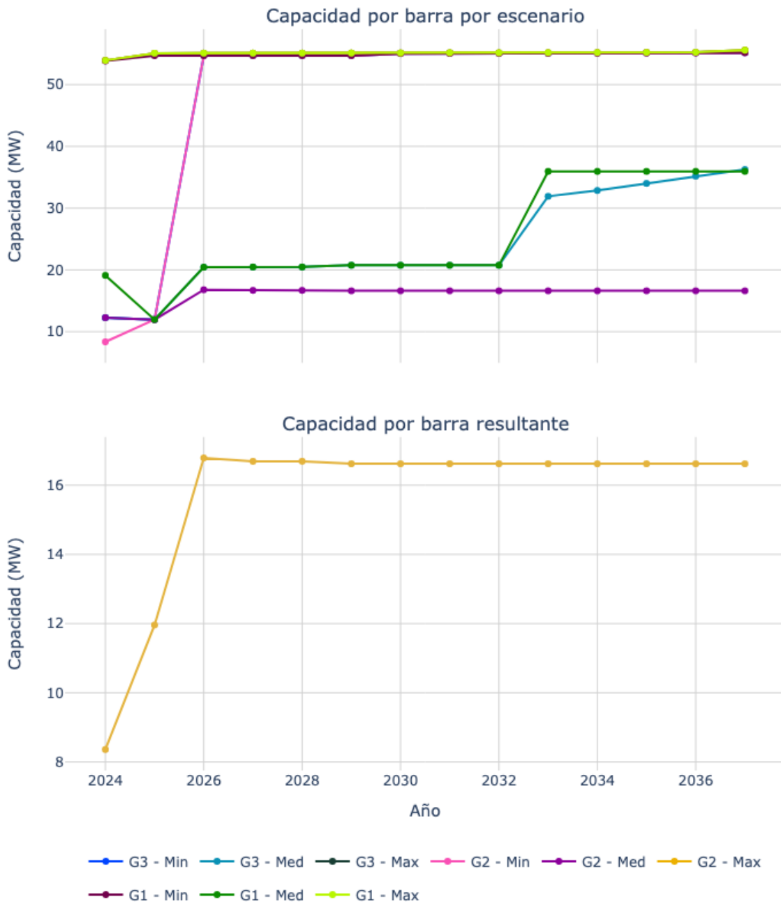
Figura 42. Capacidad de transporte de la subestación Guachal 34.5.
