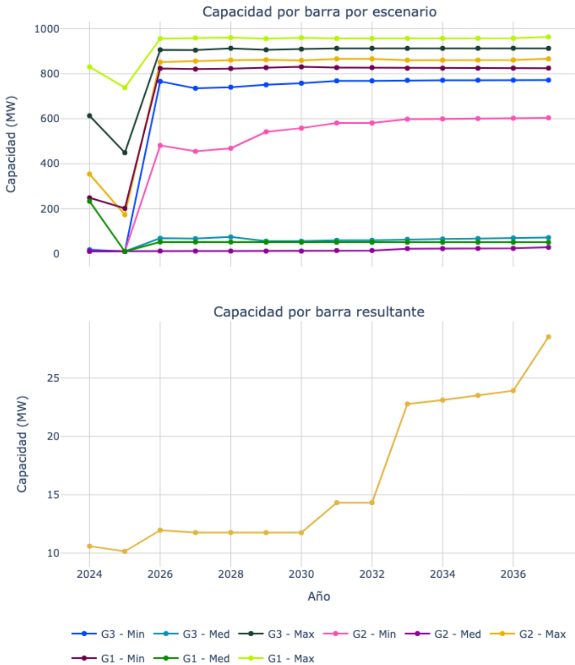
Figura 26. Capacidad de transporte de la subestación Cartago 220.
