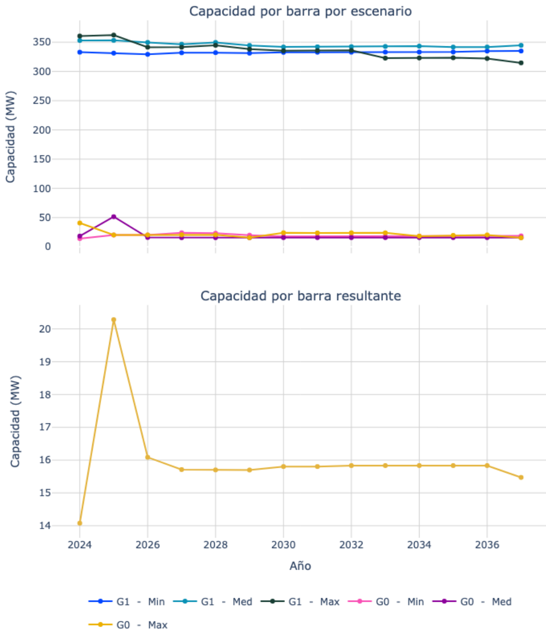
Figura 30. Capacidad de transporte de la subestación Belen (Antioquia) 110.
