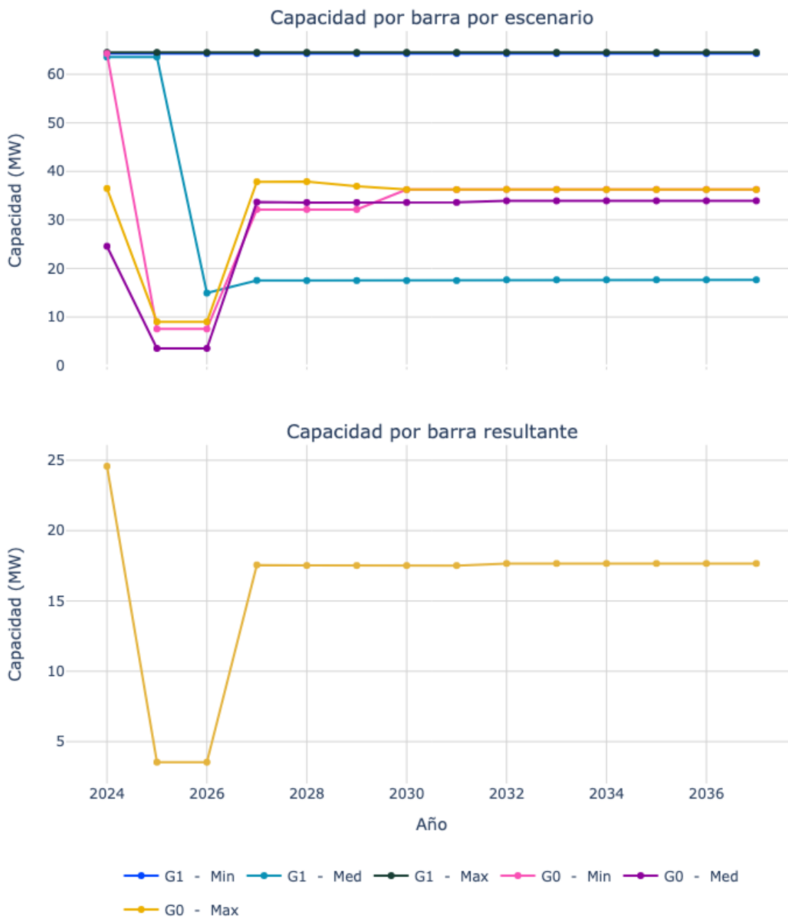
Figura 99. Capacidad de transporte de la subestación Moriche 110.
