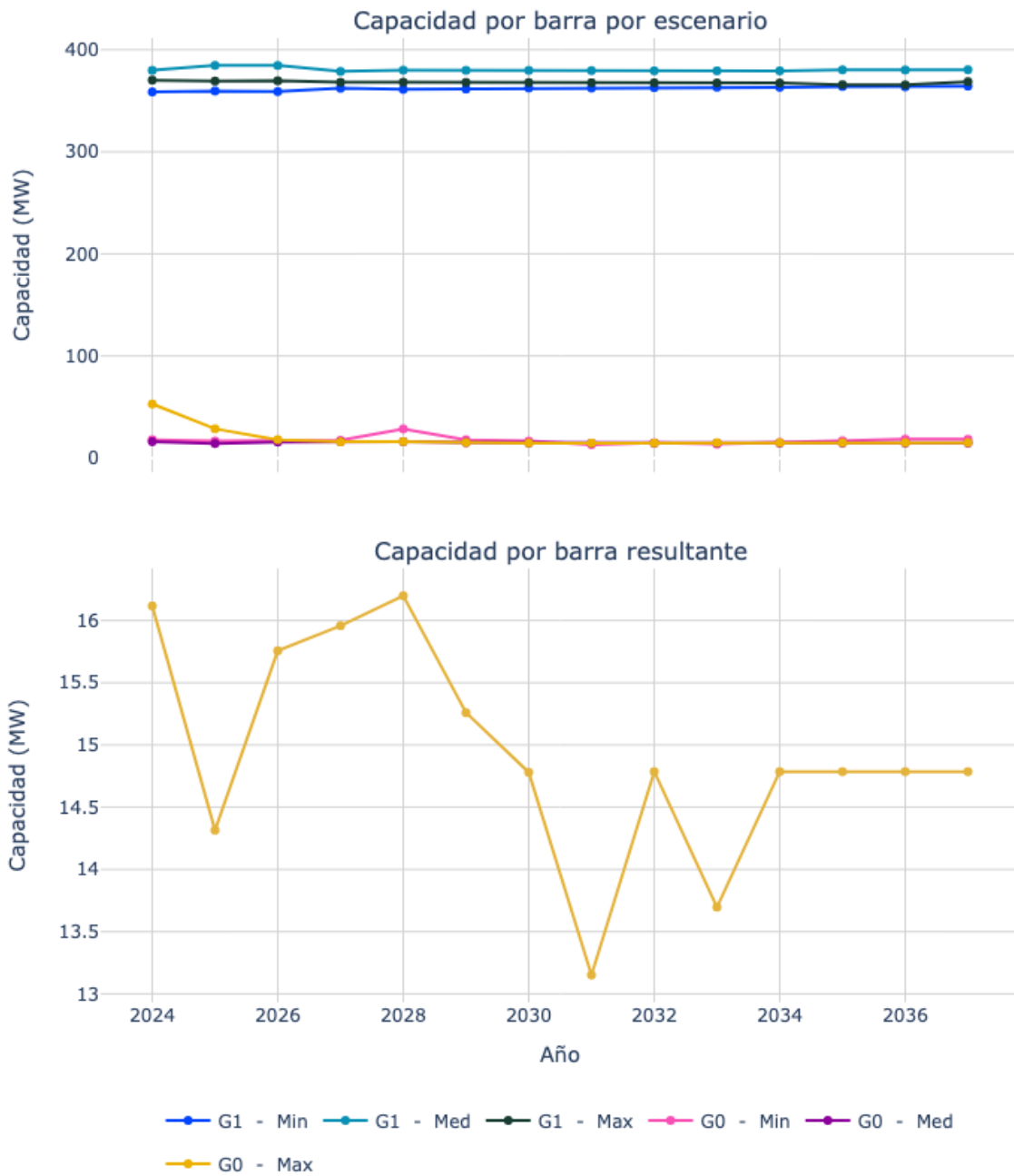
Figura 31. Capacidad de transporte de la subestación Bello 110.
