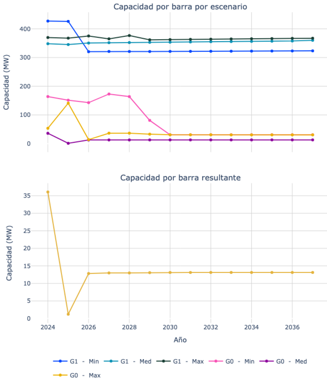
Figura 147. Capacidad de transporte de la subestación Zamora 110.
