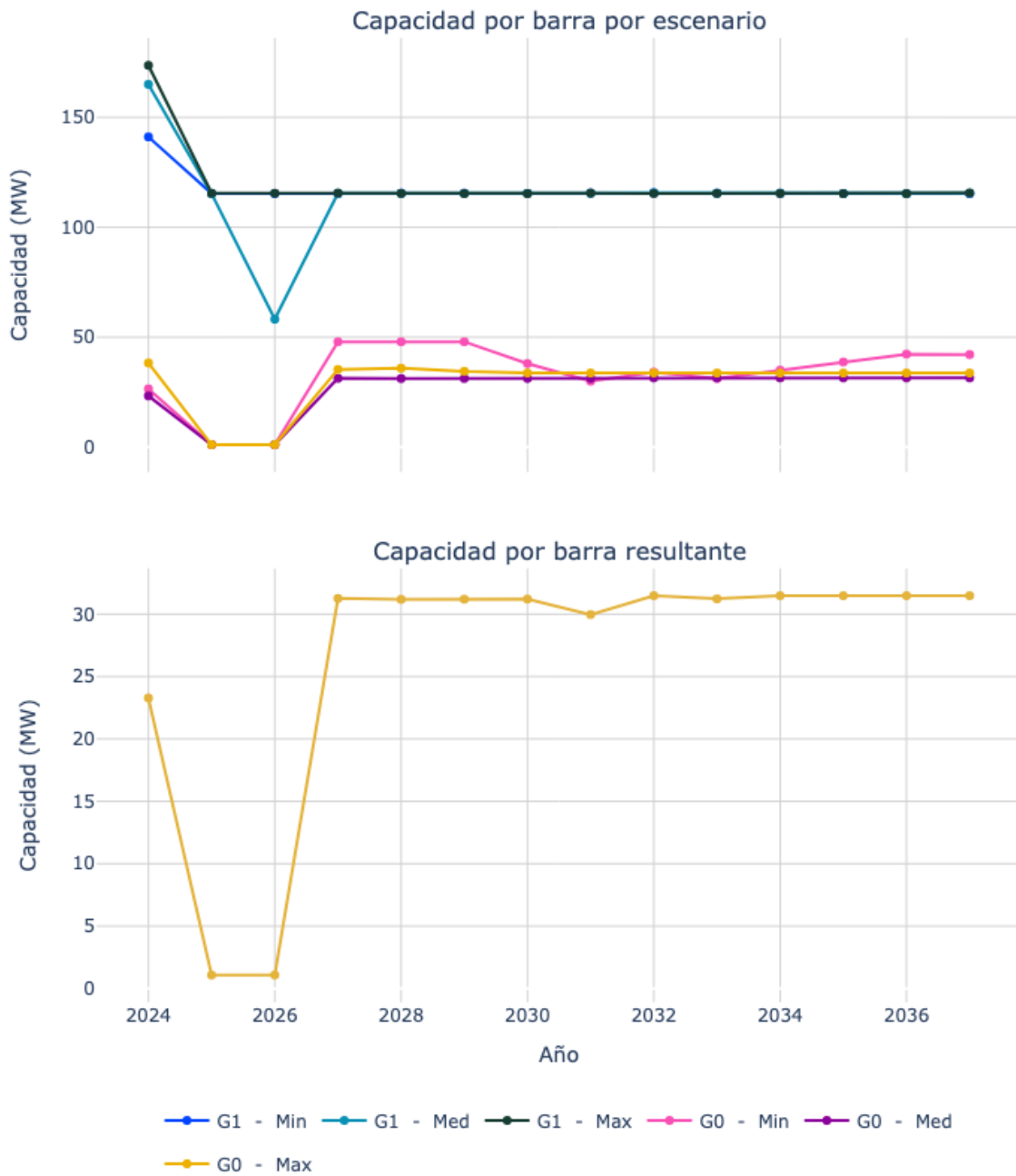
Figura 40. Capacidad de transporte de la subestación Calderas 110.
