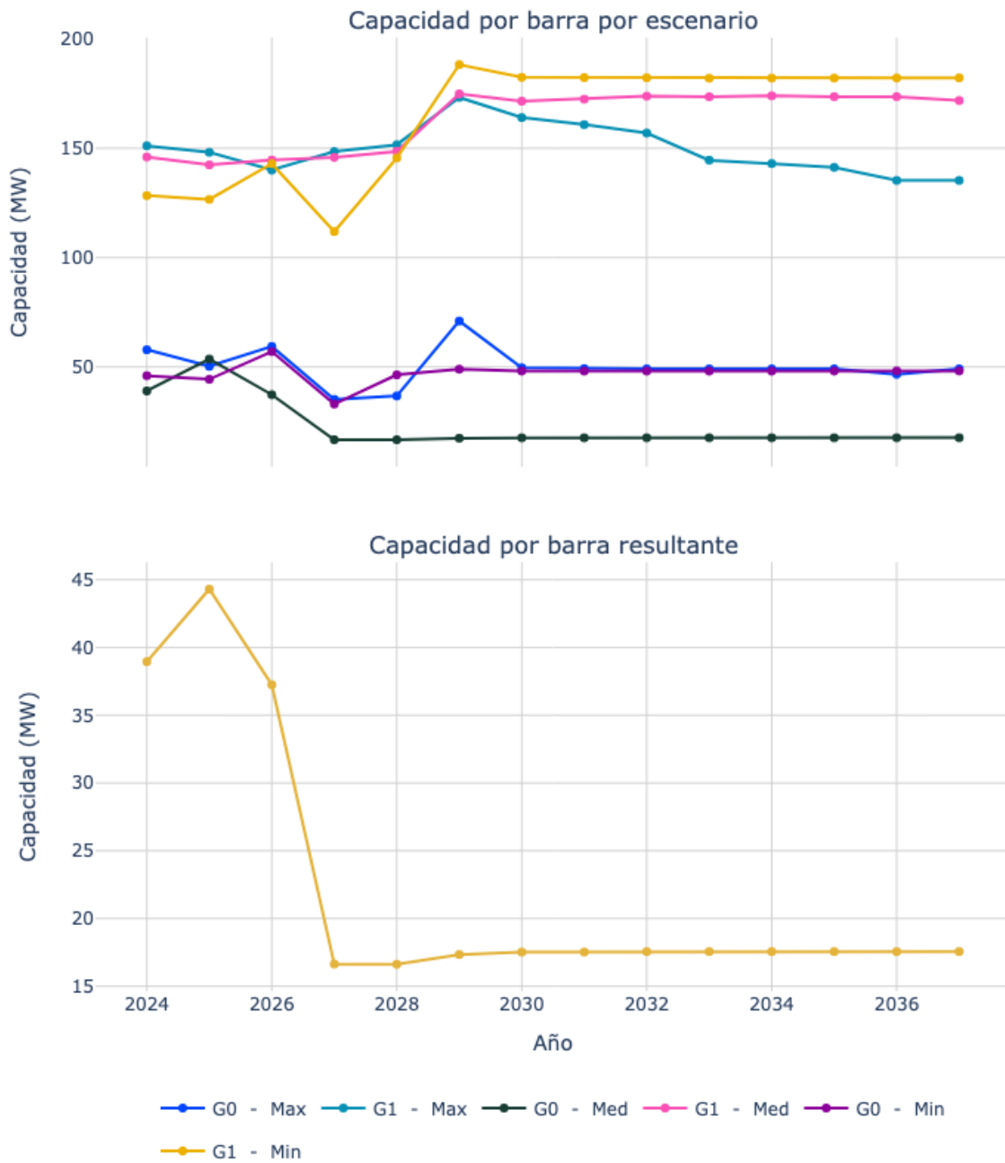
Figura 33. Capacidad de transporte de la subestación Bolombolo 110.
