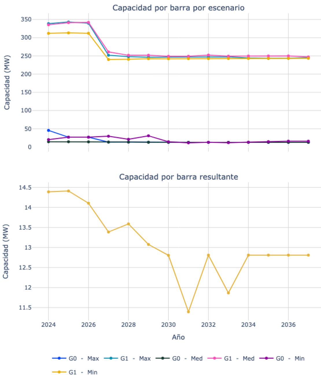
Figura 58. Capacidad de transporte de la subestación Cordova (Antioquia) 110.
