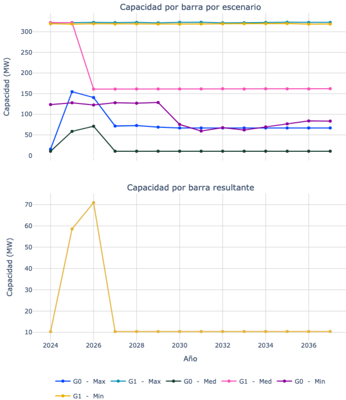
Figura 98. Capacidad de transporte de la subestación Malena 220.
