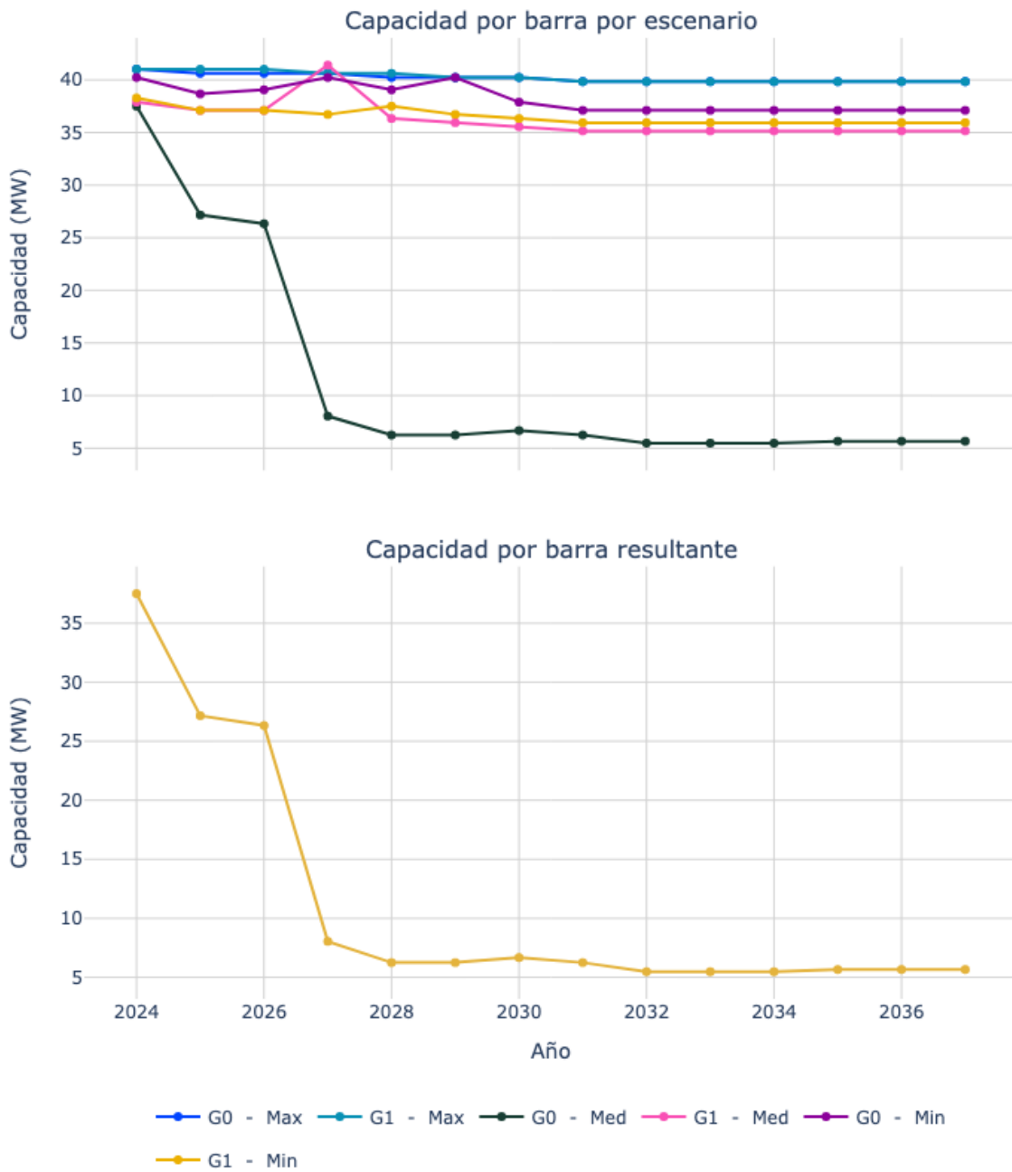
Figura 40. Capacidad de transporte de la subestación Carepa 44.
