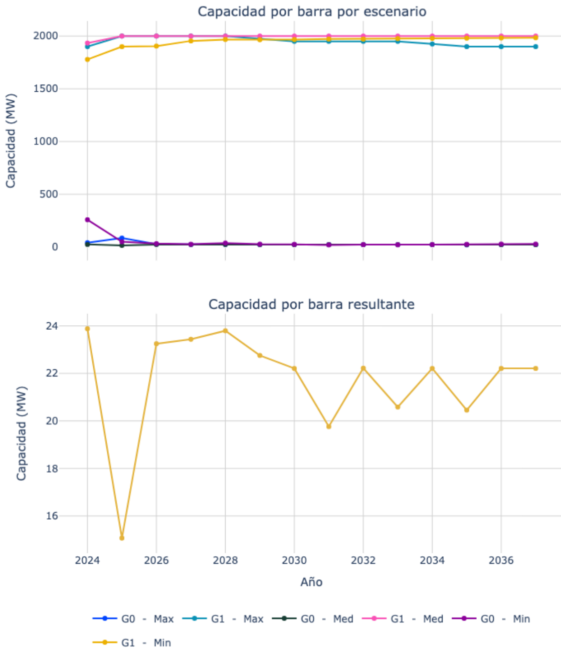
Figura 74. Capacidad de transporte de la subestación Guatape 220.
