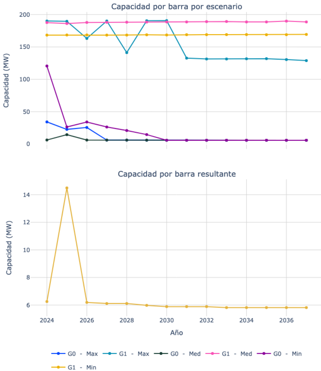
Figura 86. Capacidad de transporte de la subestación Itagui 110.
