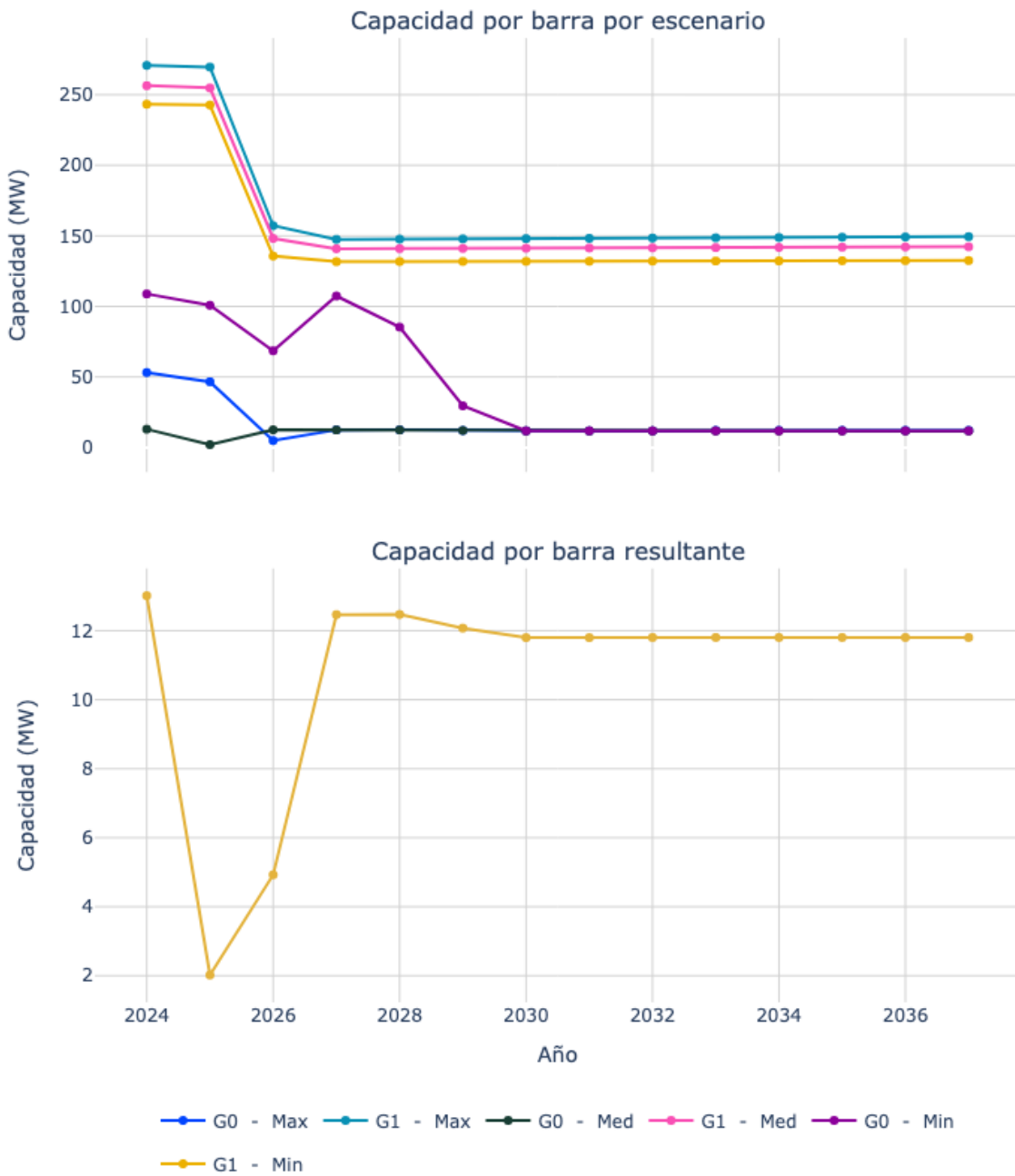
Figura 113. Capacidad de transporte de la subestación Poblado 110.
