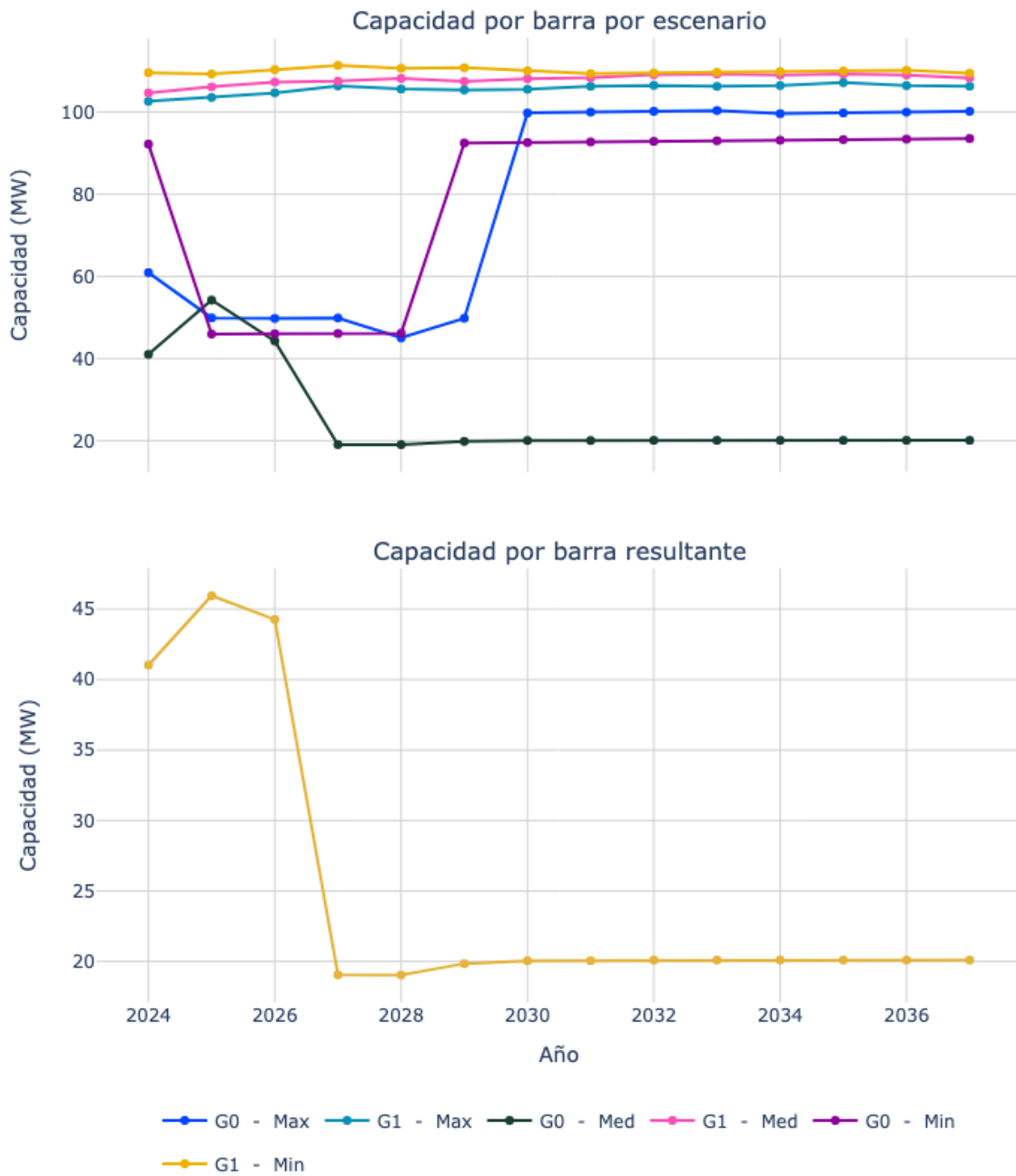
Figura 65. Capacidad de transporte de la subestación El Siete 115.
