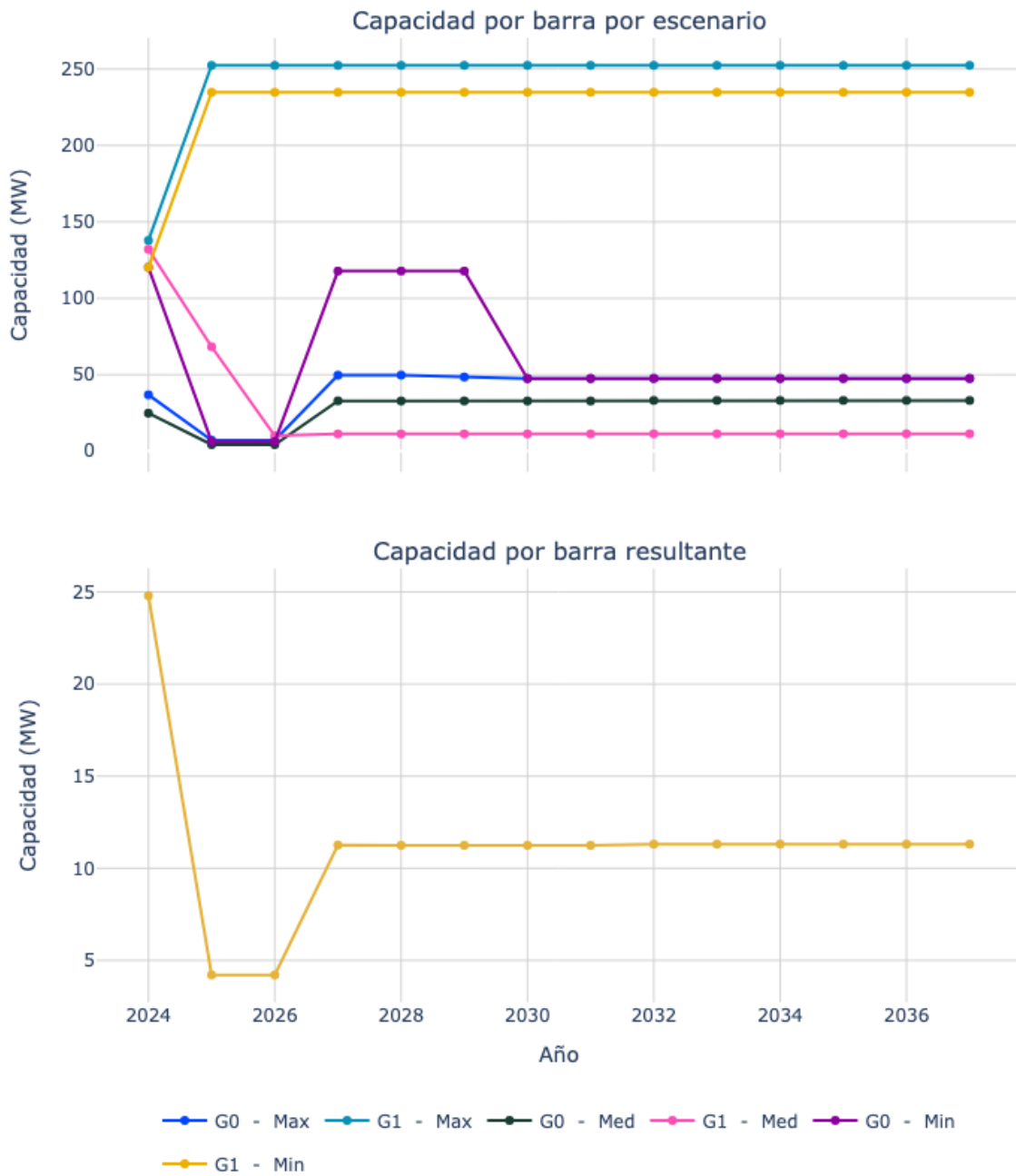
Figura 120. Capacidad de transporte de la subestación Pto Boyaca 110.
