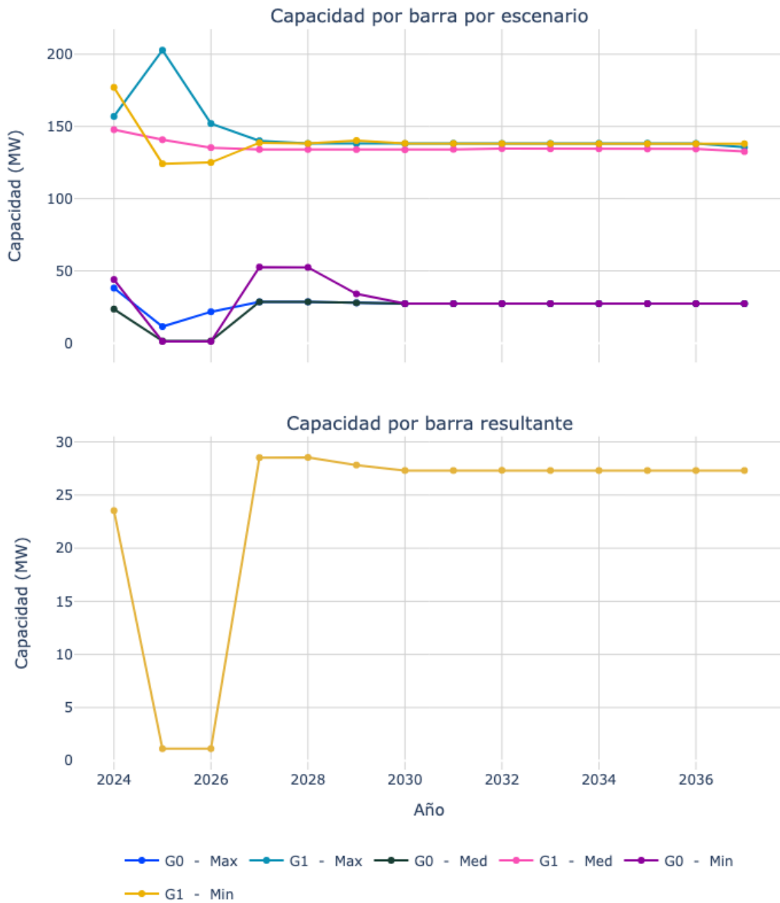
Figura 73. Capacidad de transporte de la subestación Guatape 110.
