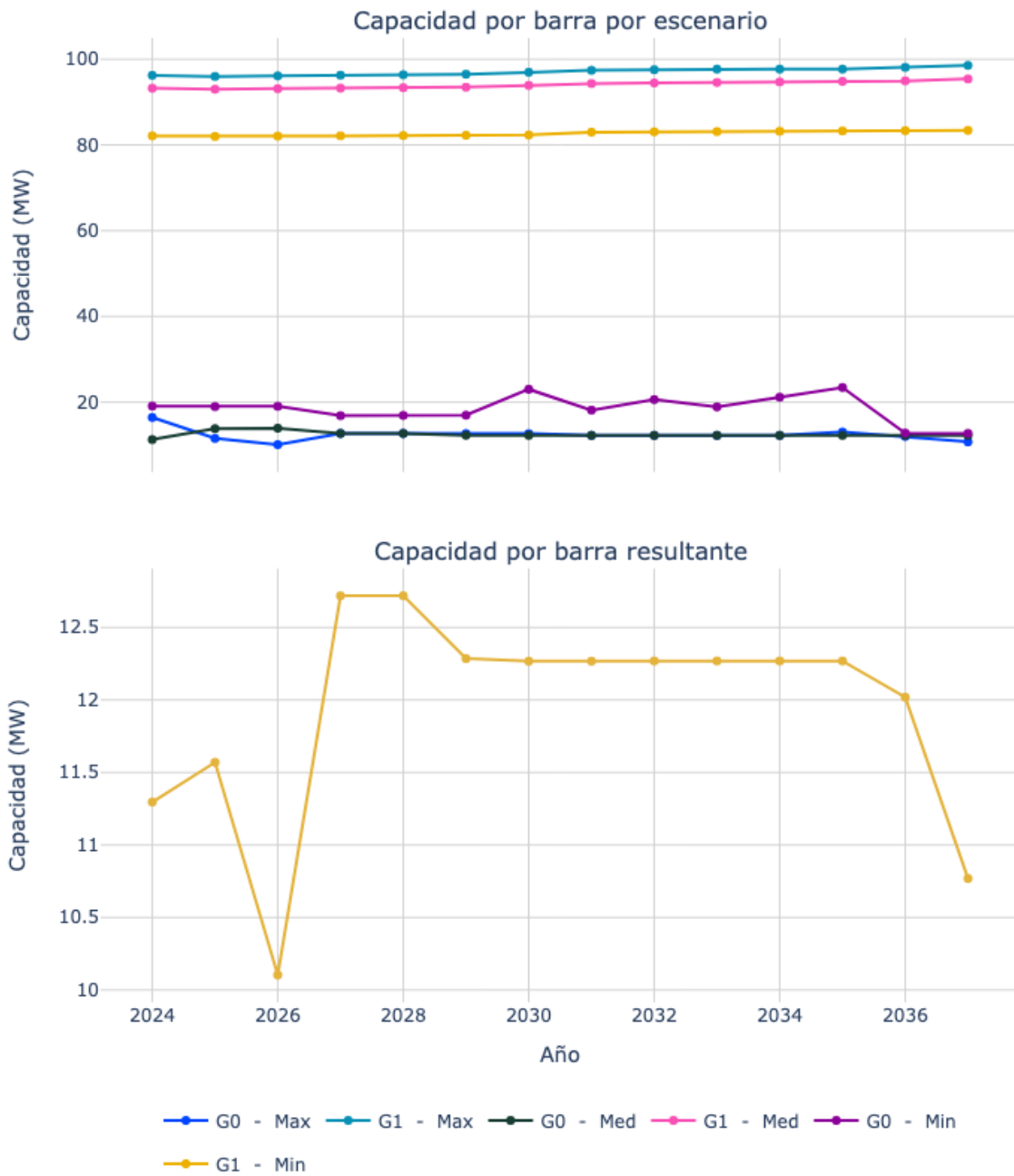
Figura 15. Capacidad de transporte de la subestación Amalfi 110.
