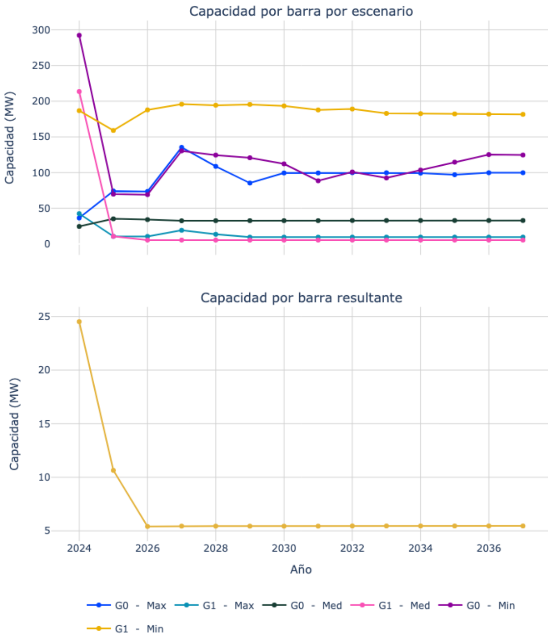
Figura 93. Capacidad de transporte de la subestación La Sierra 220.
