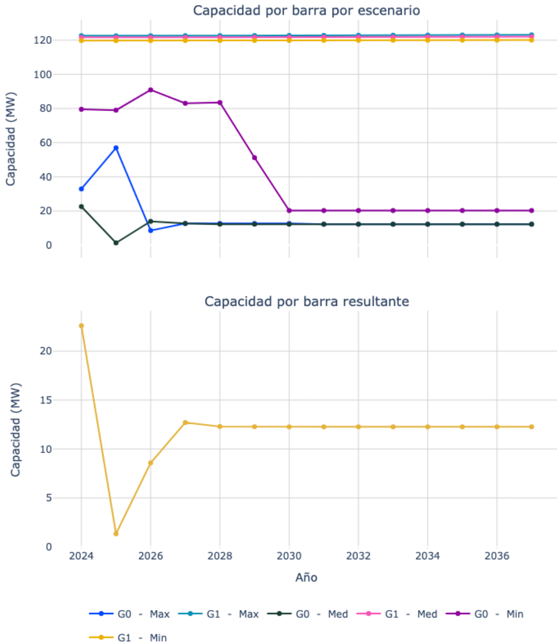
Figura 116. Capacidad de transporte de la subestación Porcecito 110.
