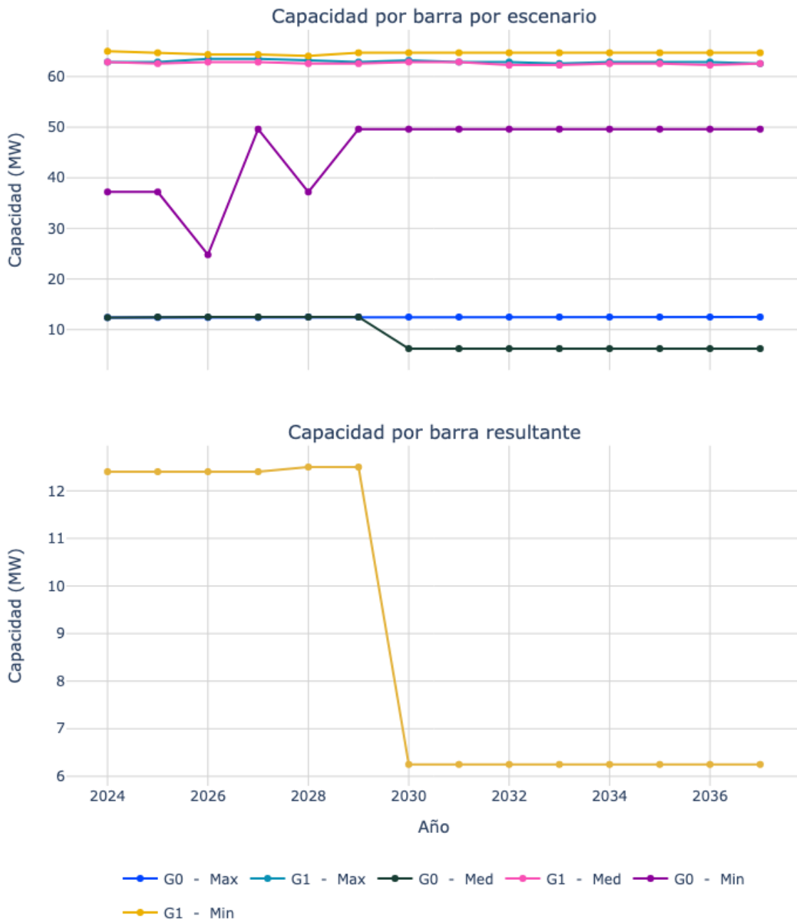
Figura 64. Capacidad de transporte de la subestación El Salto 44.
