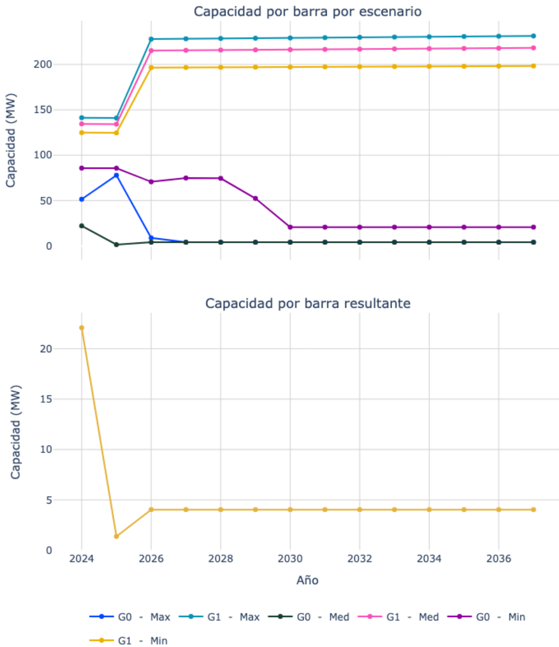
Figura 154. Capacidad de transporte de la subestación Yarumal II 110.
