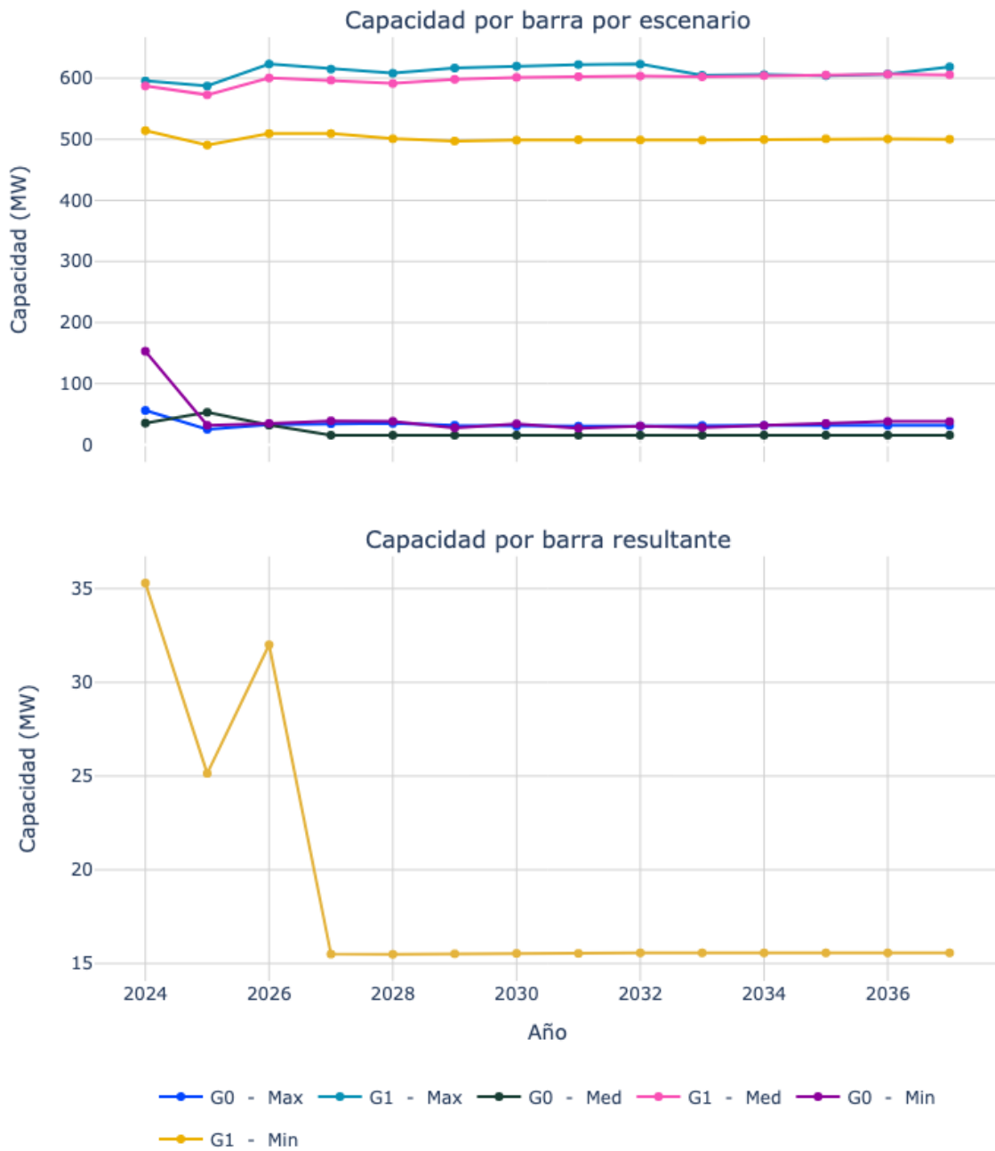
Figura 76. Capacidad de transporte de la subestación Guayabal 220.
