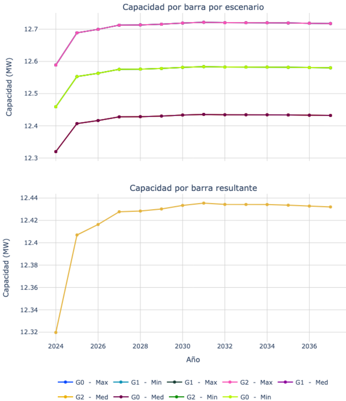
Figura 12. Capacidad de transporte de la subestación Campo Alegre 13.8.
