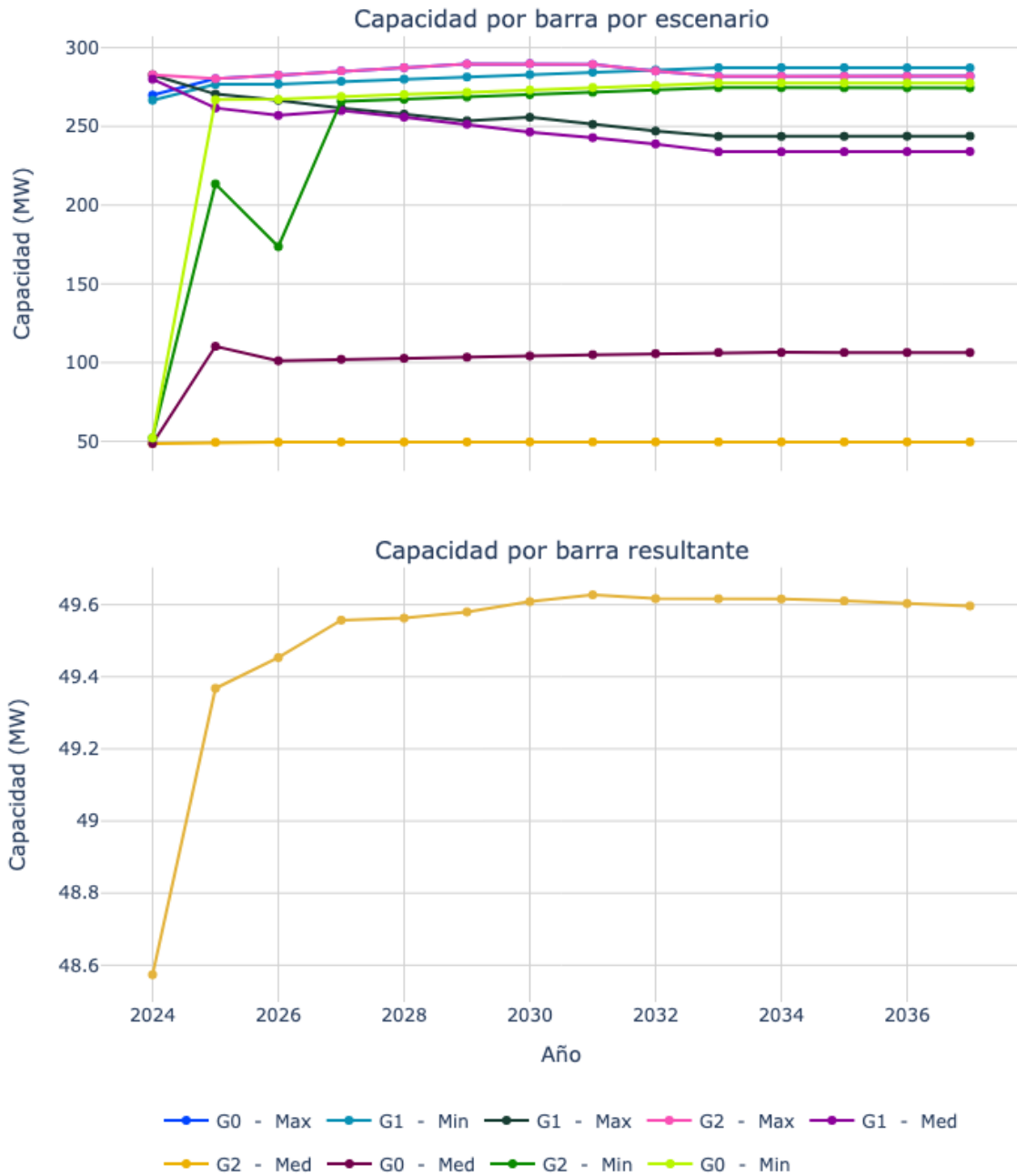
Figura 63. Capacidad de transporte de la subestación Sabanalarga 13.8.
