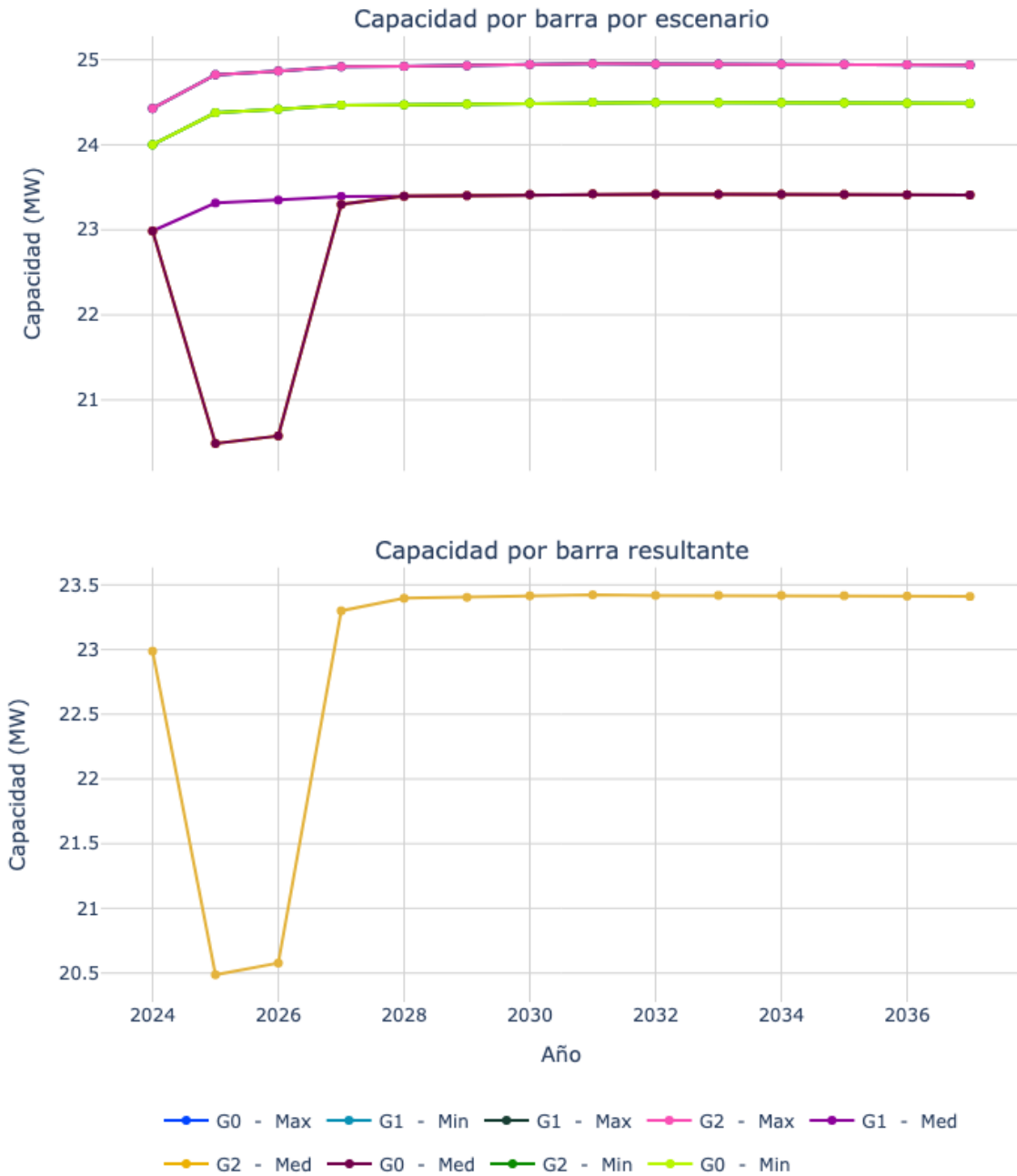
Figura 13. Capacidad de transporte de la subestación Campo Alegre 34.5.
