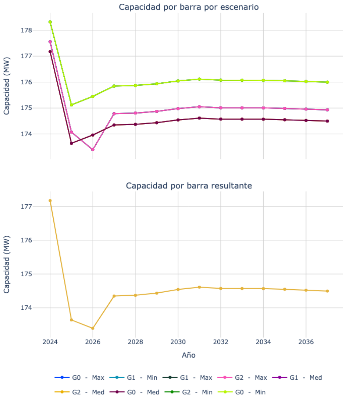
Figura 20. Capacidad de transporte de la subestación Cordialidad 110.
