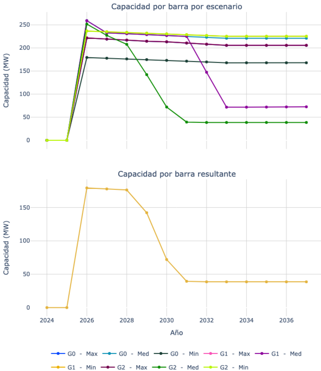
Figura 55. Capacidad de transporte de la subestación Palermo 110.
