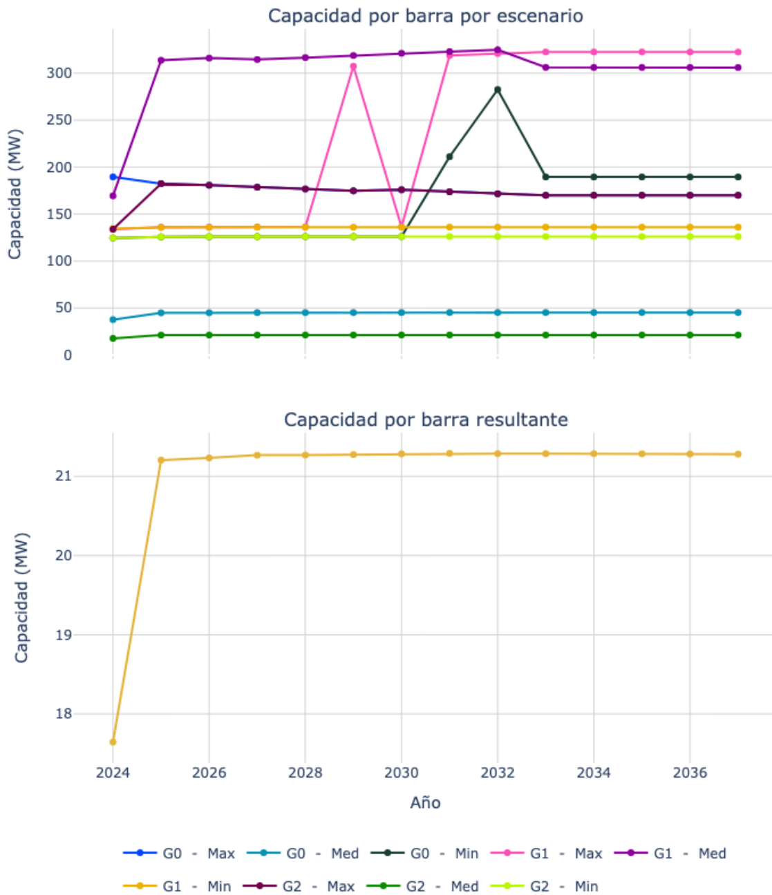
Figura 12. Capacidad de transporte de la subestación Baranoa 34.5.
