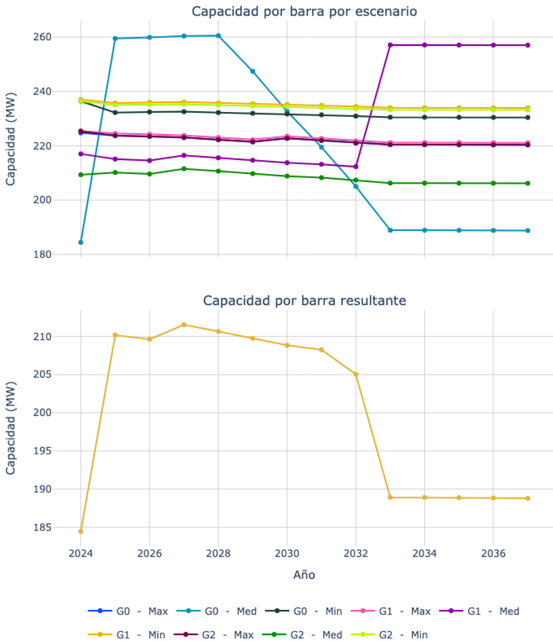
Figura 43. Capacidad de transporte de la subestación Malambo 34.5.
