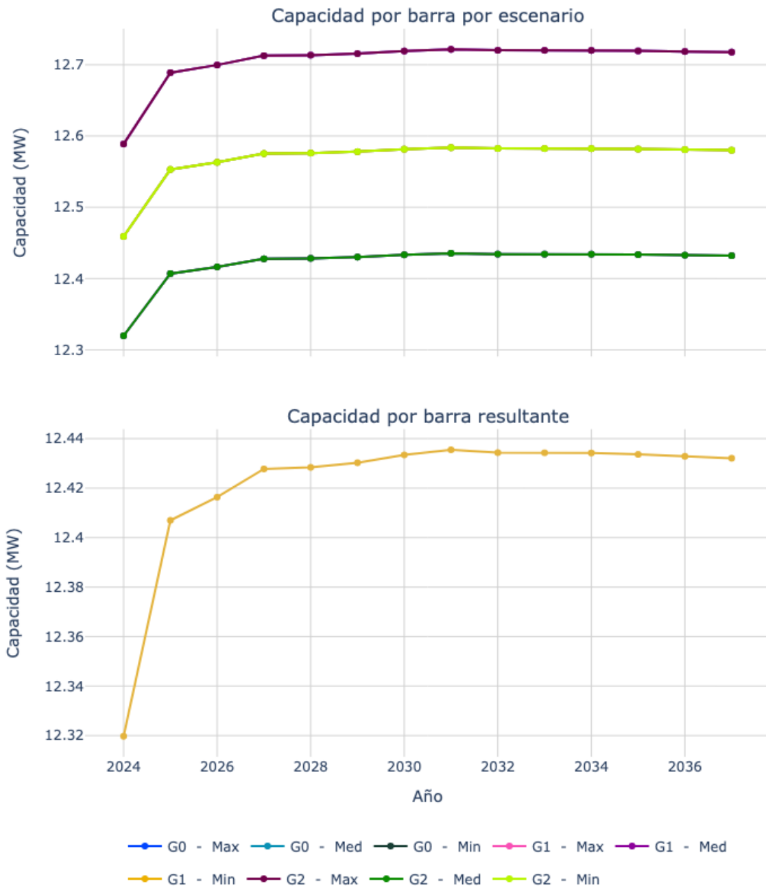
Figura 13. Capacidad de transporte de la subestación Campo Alegre 13.8.
