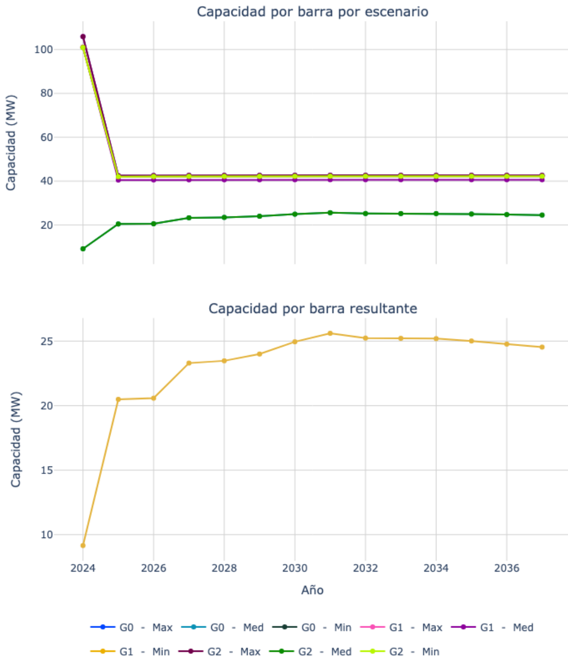
Figura 76. Capacidad de transporte de la subestación Salamina 34.5.
