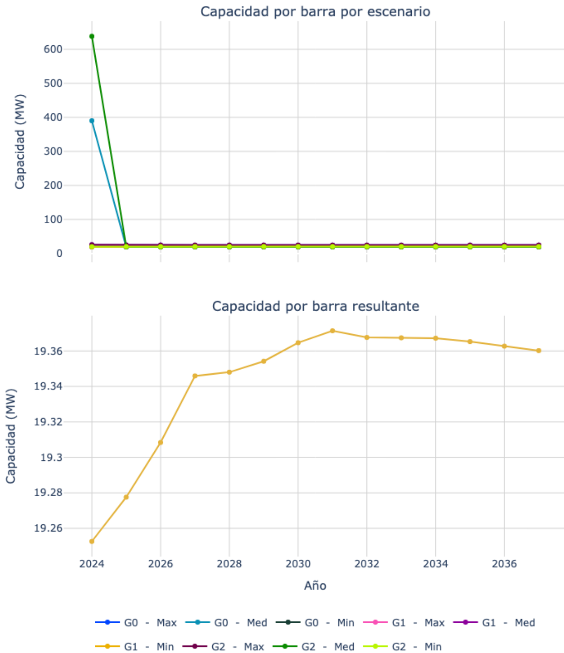
Figura 75. Capacidad de transporte de la subestación Salamina 13.8.
