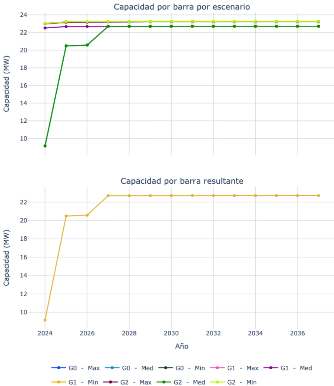
Figura 64. Capacidad de transporte de la subestación Remolino 34.5.
