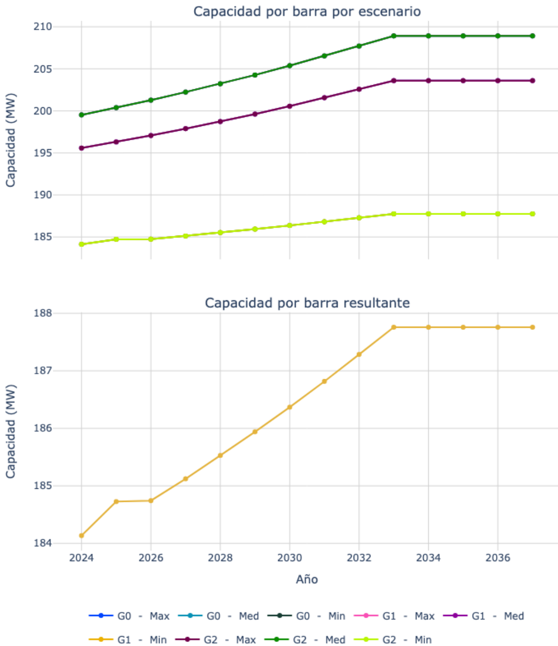
Figura 46. Capacidad de transporte de la subestación Norte 110.
