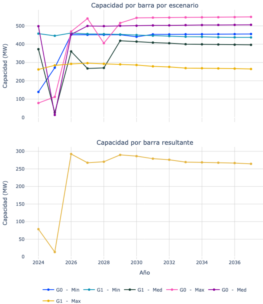
Figura 38. Capacidad de transporte de la subestación La Rosa 115.
