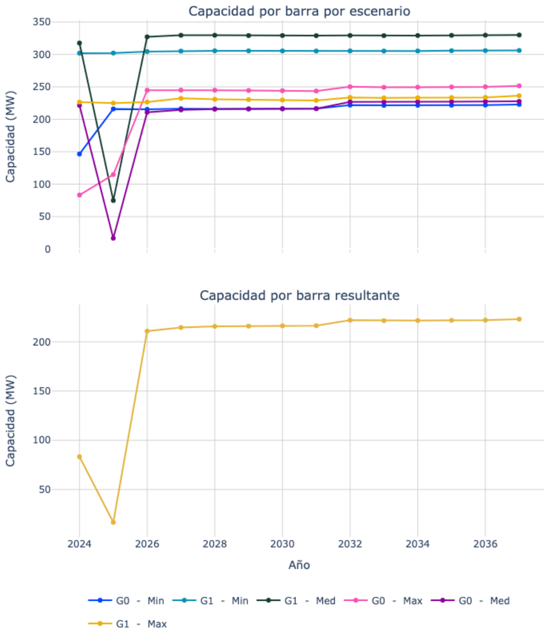
Figura 55. Capacidad de transporte de la subestación Peralonso 115.
