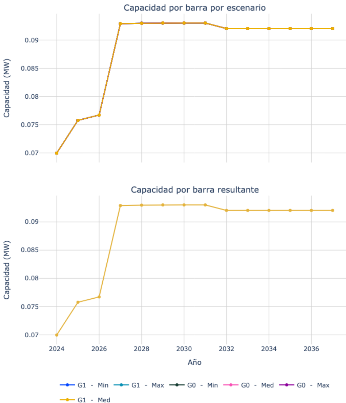
Figura 18. Capacidad de transporte de la subestación Cuba 13.2.
