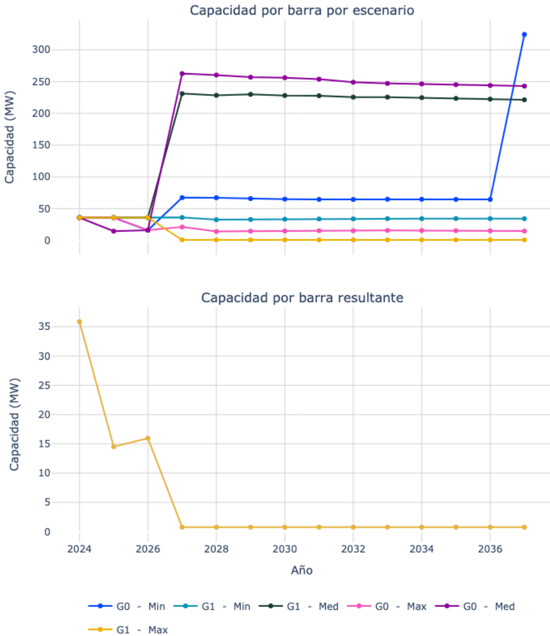
Figura 61. Capacidad de transporte de la subestación Salamina 115.
