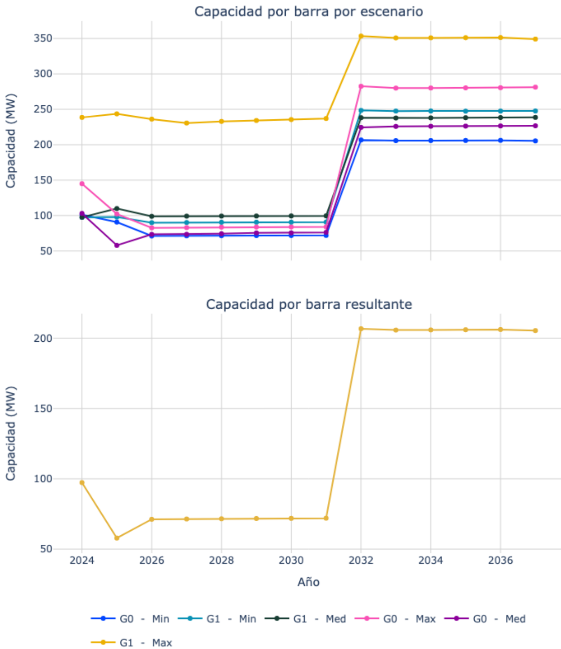
Figura 20. Capacidad de transporte de la subestación Dorada 115.
