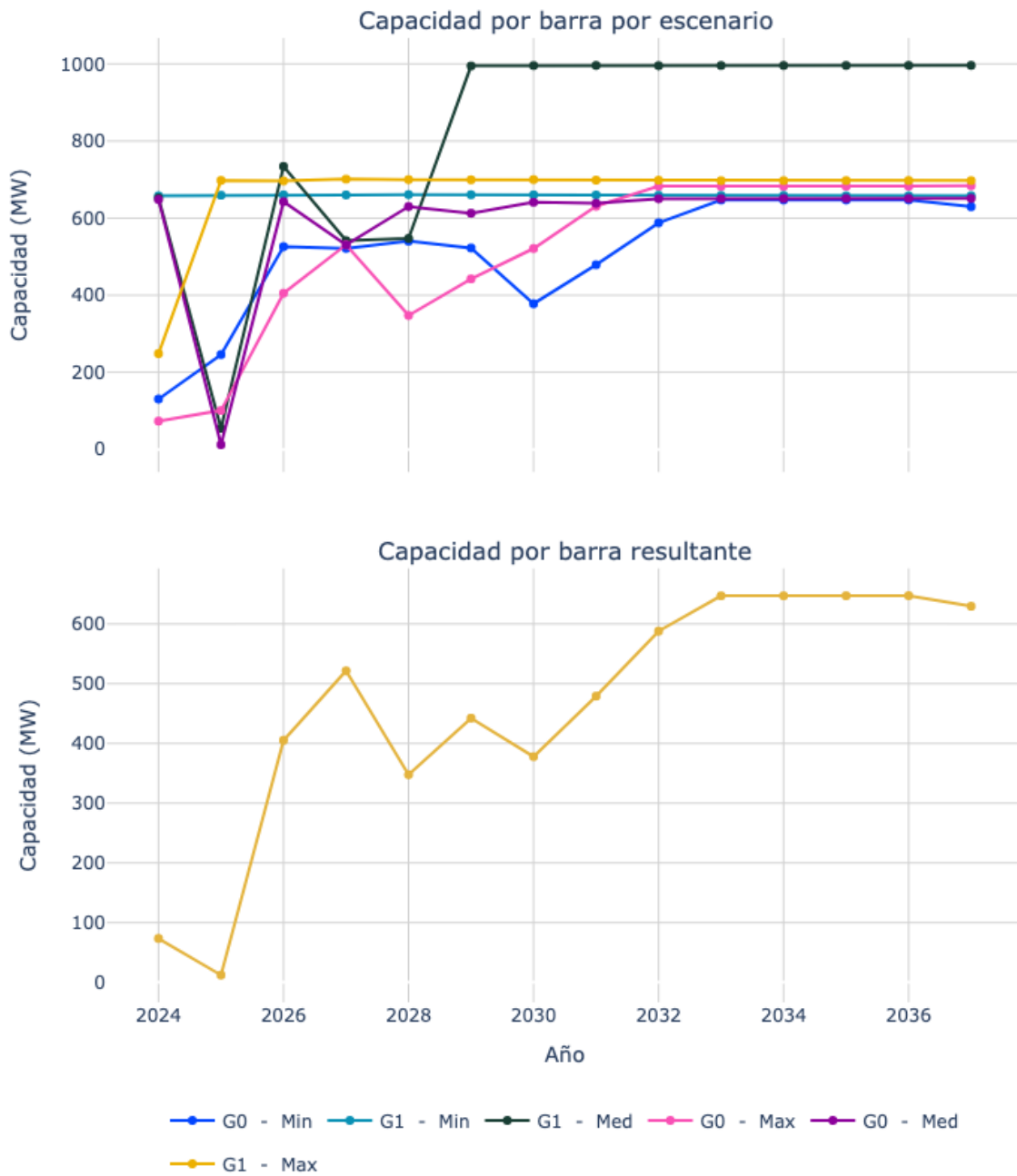
Figura 12. Capacidad de transporte de la subestación Armenia 220.
