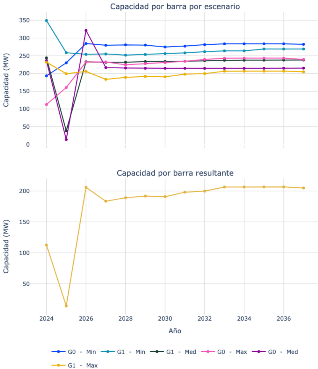
Figura 11. Capacidad de transporte de la subestación Armenia 115.
